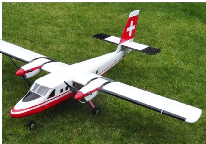
Mit 1.865 Millimeter Spannweite ist die zweimotorige DHC-6 von Pichler ein noch gut transportables Modell
