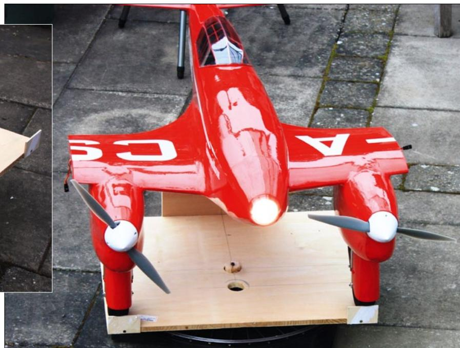
Das Spezialkonstrukt zum Überprüfen des beidseitig gleichmäßigen Motorzugs ist auf einer drehbar gelagerten Fahrradfelge montiert und groß genug für die D.H. 88
