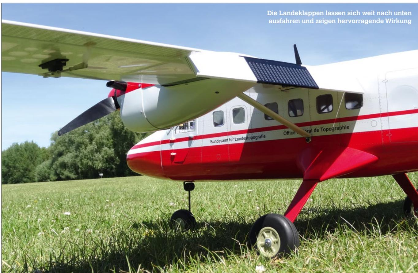
Die Landeklappen lassen sich weit nach unten ausfahren und zeigen hervorragende Wirkung
