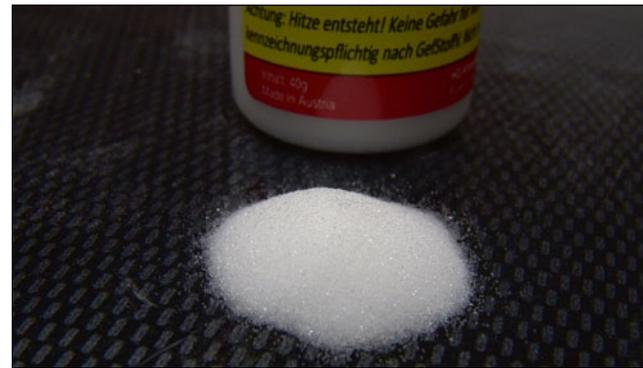
Das ist kein CA-Booster, sondern zum Vergleich die Partikel eines konventionellen CA-Fillers. Die Nahaufnahme verdeutlicht, dass es sich um kleinste Kugeln handelt – alle gleich groß. Das ergibt mit CA-Kleber eine weniger stabile Struktur, die zwar glashart wird, aber auch schneller brechen kann
