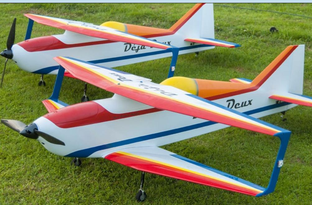
Die Doppeldecker von Hans-Jürgen Ahlborn und Sohn Marvin sind komplette Eigenkonstruktionen und mit einem Einziehfahrwerk ausgestattet. Dabei liegt die untere Tragfläche vor der oberen
