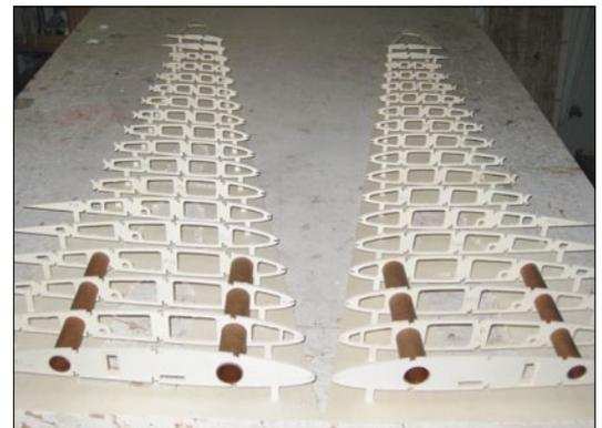
Der Außenflügel lässt sich aufgrund der hohen Vorfertigung in kurzer Zeit auf der Helling stecken
