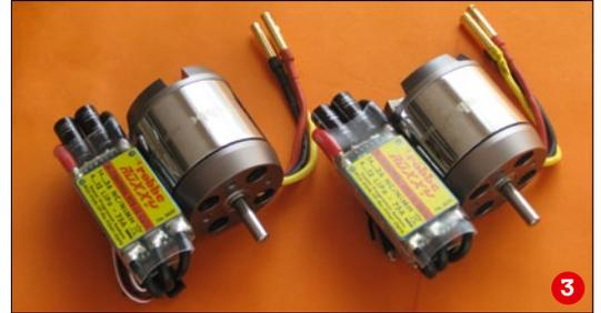
Das Bepflanken des kompletten Modells mit Balsaplatten erfordert etwas Geduld (1), Die Wirkung der Landeklappen im Flug ist deutlich zu spüren und erfordert eine individuelle Anpassung der Ausschläge (2), Antriebsmaschinen mit Reglern. Beide sind zwar noch aus dem ehemaligen robbe-Sortiment, heute aber bei Multiplex im Vertrieb (3)
