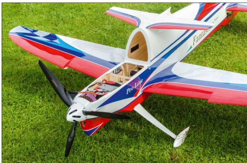
Der Hackermotor Q80 14 XS mit seinem großen Durchmesser wird durch die Schlitze im Spinner besser gekühlt
