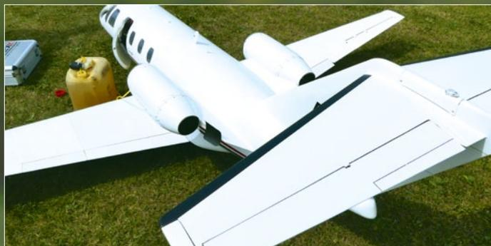
Flächen und Leitwerke sind konventionell mit Styrokern und Abachi-Bepflankung aufgebaut. Die abschließende GFK-Beschichtung wurde mit 25-Gramm-Glasgewebe realisiert
