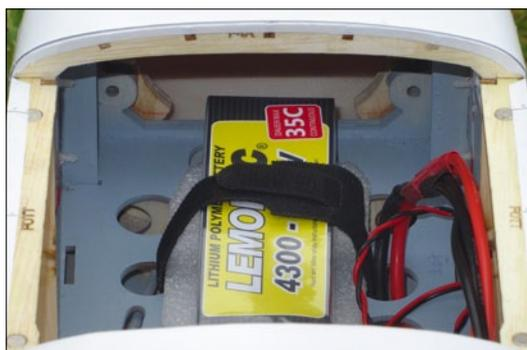
Pichler empfohlene Lemon RC-LiPo mit einer Kapazität von 4.300 Milliamperestunden zur Verfügung. Sein Gewicht führt zu einer Befestigung 20 mm hinter dem Kopfspant auf dem dafür vorgesehenen Bodenbrett.
