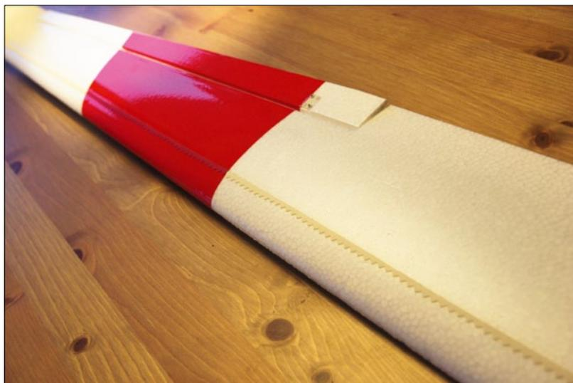
**Abbildung 5:** Turbulatoren im vorderen Bereich der Profiltiefe können helfen, Re-Zahl-empfindliche Profile zu entschärfen
