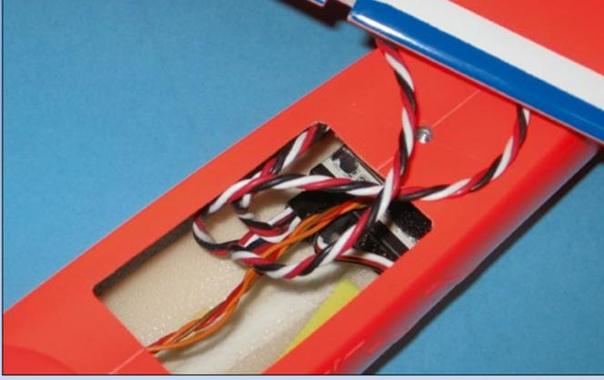
Die Servokabel in den Tragflächen sind lang genug und werden direkt im Empfänger eingesteckt
