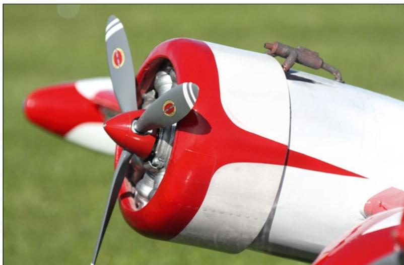
Vor dem Fliegen steht das Synchronisieren der beiden Triebwerke an, und zwar durch Anpassen der Steigung der verstellbaren Ramoser-Propeller
