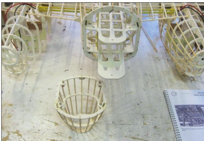
Wie gut sich Rundungen durch Spanten und Stringer realisieren lassen, wird an den Motor gondeln deutlich
