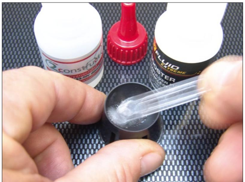
Nun das Klebstoffgel zügig mit dem Rührstäbchen auf die saubere und fettfreie Klebestelle auftragen. Bereits nach etwa fünf Minuten beginnt – je nach Viskosität des Sekundenklebers – der Aushärtprozess
