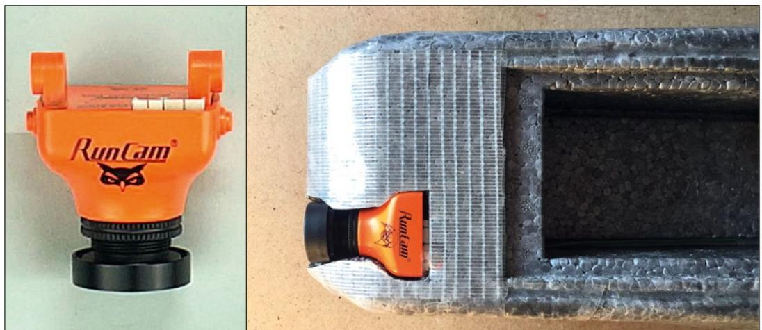
Die Runcam Eagle brilliert durch Farbtreue und großen Dynamikumfang. Sie wird aerodynamisch und gut geschützt in die Rumpfnase integriert
