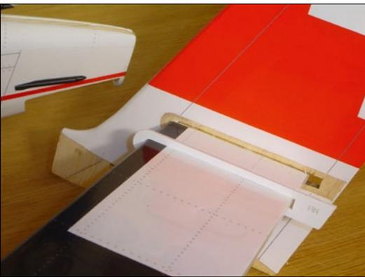
Holzrahmen verstärken die Lagerung der Höhenleitwerksdämpfungsfläche. Zur Verklebung sollte ein spaltfüllender Klebstoff verwendet werden.
