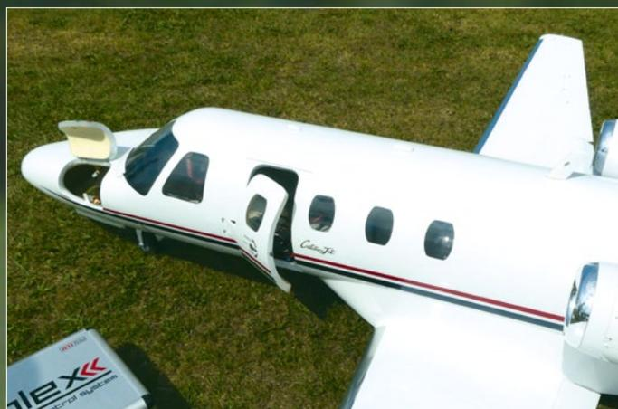
Der Rumpf besteht aus einem Styrokern mit etwa 20 Millimeter Wandstärke, der außen mit 2,5er-Balsa beplankt ist. Die gesamte Rumpfkonstruktion wurde anschließend mit 50-Gramm-Glasgewebe überzogen. Türen und Klappen sind innen ebenfalls mit GFK-Gewebe beschichtet
