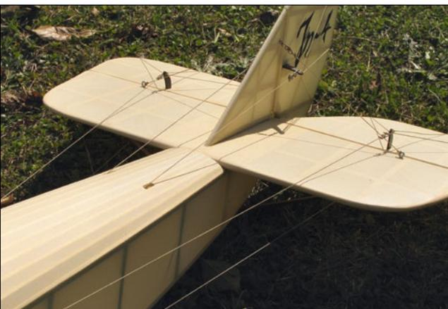
Abbildung 7: Die Curtiss Jenny besitzt ein im Vergleich zum Original um 50 Prozent vergrößertes Leitwerk – optisch stört es kaum
