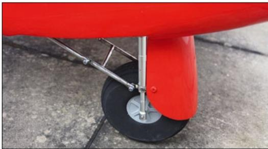
Montiertes Einziehknie mit aerodynamischer Verkleidung
