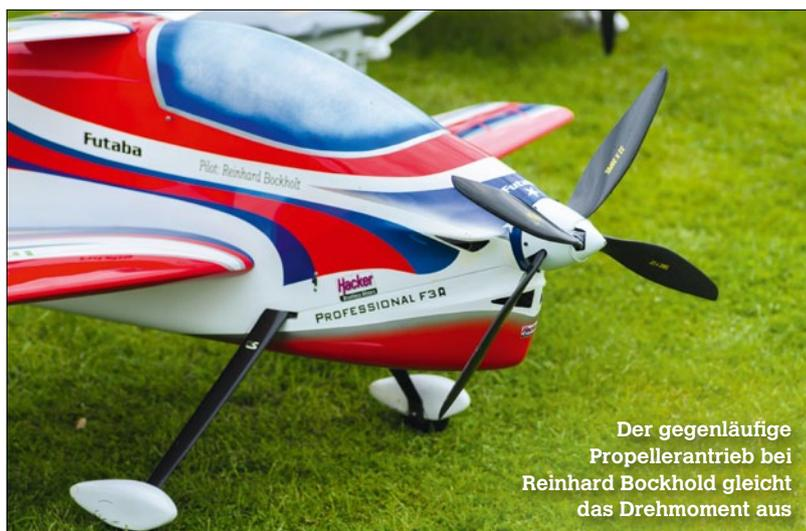
Der gegenläufige Propellerantrieb bei Reinhard Bockholdt gleicht das Drehmoment aus
