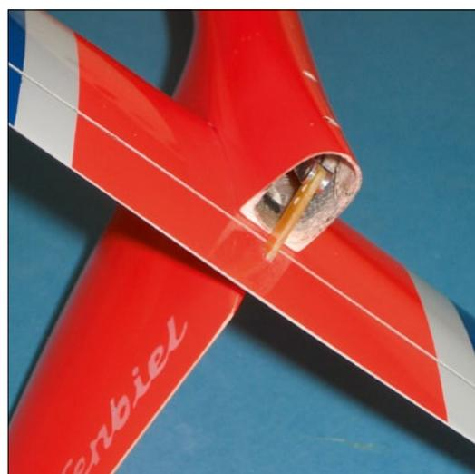
Die Anlenkung des Höhenruders erfolgt auf direktem Weg. Im Ruderhorn wird ganz außen eingehängt, um kleinstmögliche Ausschläge mit dem geringsten Spiel zu realisieren
