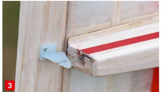
Das Servo für die Schleppkupplung findet seinen Platz unter der Kabinenhaube (1). Die Seitenrudernanlenkung ist ganz klassisch ausgeführt (2). Das Höhenruder wird geradlinig von unten angelenkt (3)
