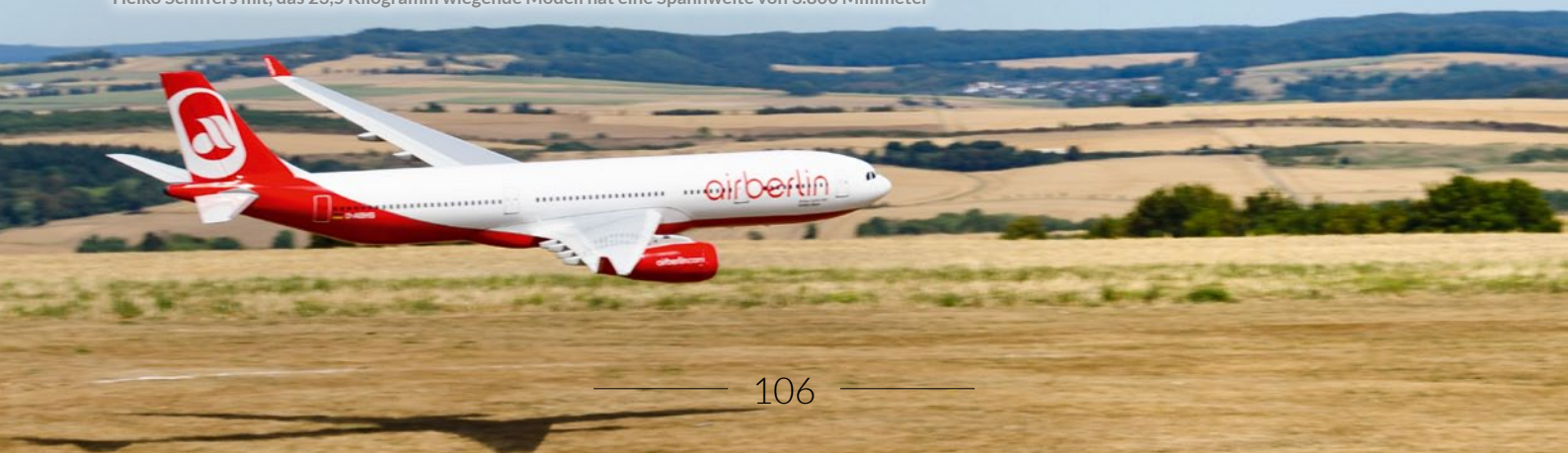
In Kirberg ist Airberlin noch am Start gewesen. Den 4.000 Millimeter langen Airbus A330-300 brachte Heiko Schiffers mit, das 23,5 Kilogramm wiegende Modell hat eine Spannweite von 3.800 Millimeter
