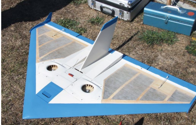
Ein Deltamodell mit integriertem Tangential-Antrieb von Karl-Heinz Tobias
