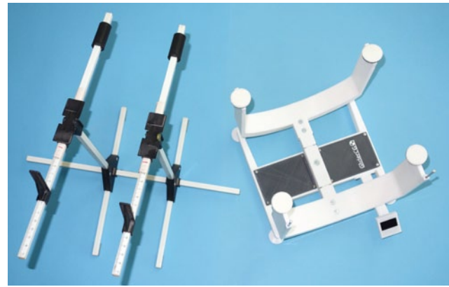
Links die seit Jahrzehnten bewährte Schwerpunktwaage, rechts die digitale Version, welche zukünftig zum Einsatz kommt.
