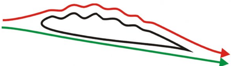
Abbildung 6: Das Einstein-Hochauftriebsprofil geht vom falschen Modell aus. Es war ein Flop
