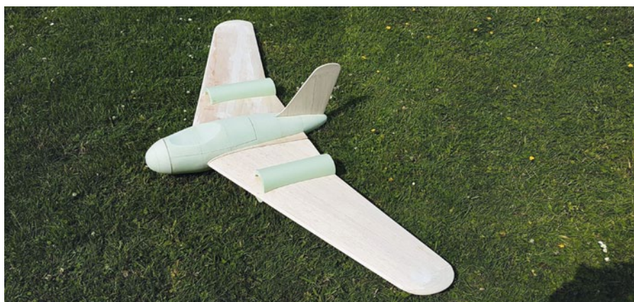
Ein Traum in Schaum: alle Teile der Me-329 sind CNC-geschnitten, die Flächen bereits mit Balsa beplankt. Die Segmentschnittbauweise gibt der Rumpfwider
