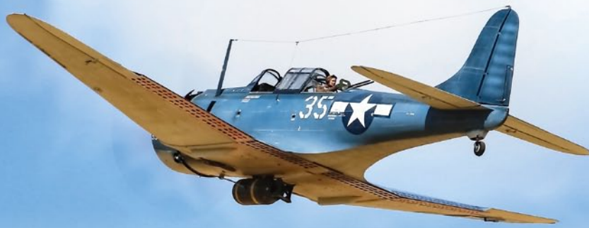
Mit einem kraftvollen 330 Kubik-Motor startete Jörg Albrecht seine 3.200 Millimeter spannende und 33 Kilogramm wiegende Dauntless SBD aus – das ist schon ein besonderes Warbird-Feeling
