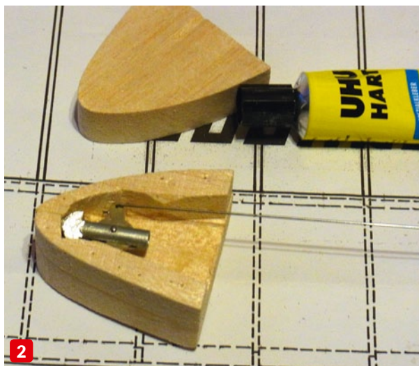
Der Nasenklotz wird in drei Längsscheiben gesägt. Darin lässt sich dann die Schleppkupplung gut einbauen (1 und 2)
