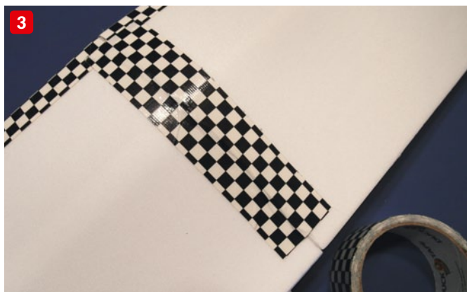
Die Knickverstärkung ist mit Umreifungsband verstärkt. Natürlich eignet sich auch anderes Material, beispielsweise CFK-Flachprofil (1). Die Knickverstärkung wird erst in der einen Hälfte verklebt, dann können die beiden Hälften verbunden werden (2). Eine Bandage aus Ducktape (Panzerband) dient als Sicherheitsreserve. Hier trägt es sogar zur Optik des Modells bei (3). Der Rumpf ist ein einfaches Kastenengebilde und mit ein paar Spanten abgestrebt. Der Motorspant ist aus Pappelsperholz (4)
