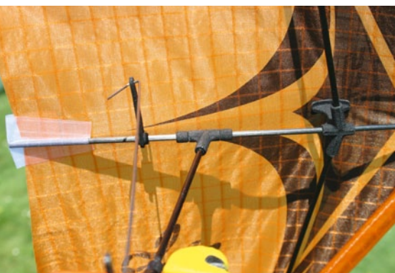
Hightech unterm Segel. Die Verbindungs- und Gelenkteile sind aus Laser-gesintertem Kunststoff gefertigt
