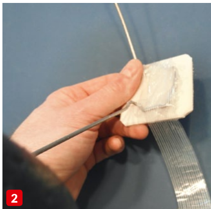
Da die Abmessungen des Modells noch kompakt sind, wird der Flügel mit dem Rumpf verklebt. Das sorgt zudem für viel Stabilität (1). Auf einem Montagebrett ist das Fahrwerk mit Glasfasertape befestigt (2). Spinnacker-Reparaturtape ist ideal für die Herstellung von Ruderscharnieren (3)
