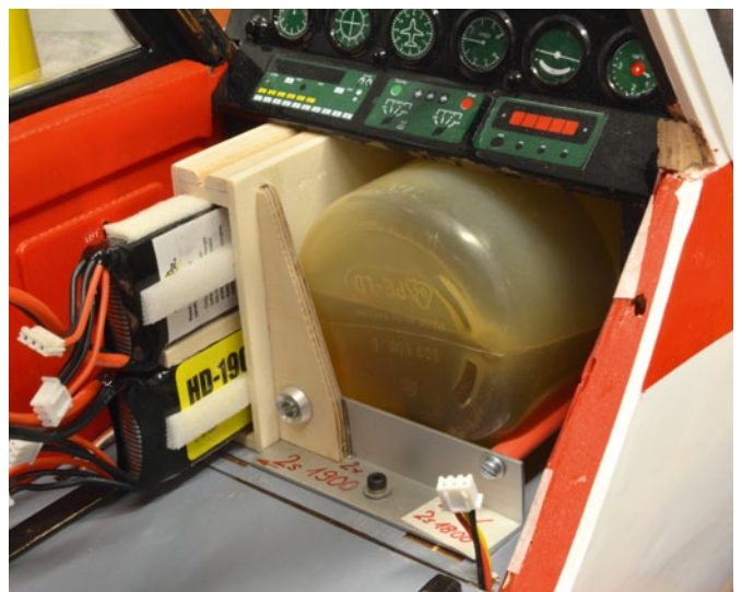
Die Tankhalterung im eingebauten Zustand. Zum Laden können die Empfängerakkus bequem aus der Box heraus gezogen werden
