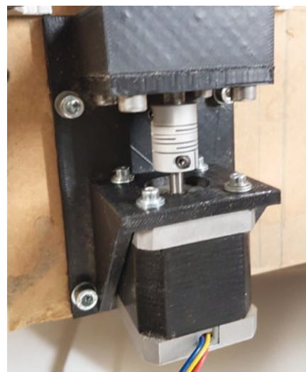
Lagerbock der X-Achse mit integriertem Festlager
