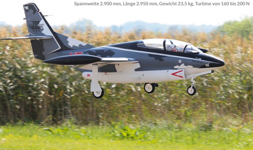
Die Firma Paritech präsentierte mehrere vorbildgetreue Nachbauten der North American T-2 Buckeye. Der Voll-GFK-Bausatz hat eine Scale-Oberfläche. Spannweite 2.900 mm, Länge 2.950 mm, Gewicht 23,5 kg, Turbine von 160 bis 200 N
