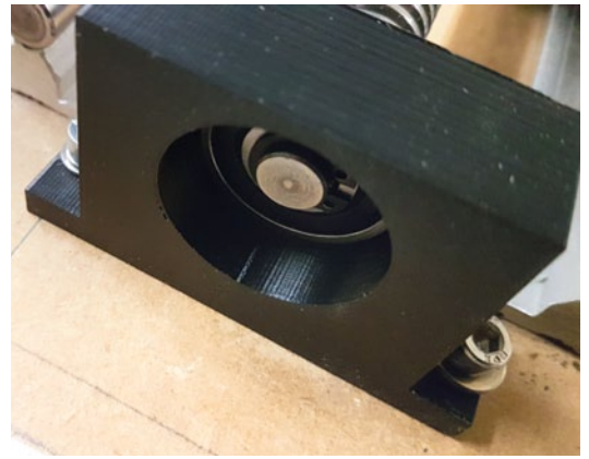
Das Loslager gestattet den Längenausgleich der Spindel
