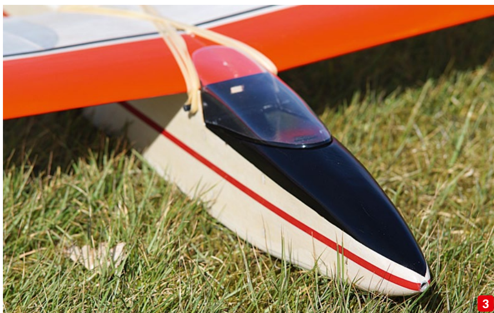
Auch ohne Bespannung macht der Amigo V schon einen guten Eindruck (1). Aus dieser Perspektive zeigt sich die große V-Form der Tragflächen (2). Das Loch in der Rumpfnase ist die Öffnung der Schleppkupplung für den F-Schlepp (3)
