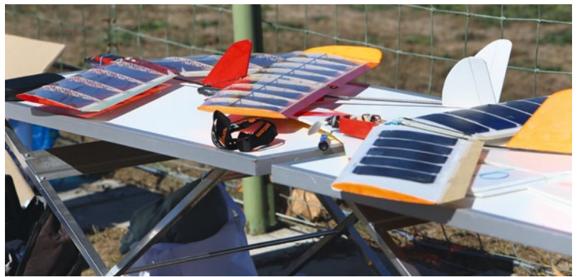
Sobald die Sonne scheint, gehts los. Batterien laden war gestern. Naja, die RC-Elektronik ist von einem 1s-LiPo gepuffert
