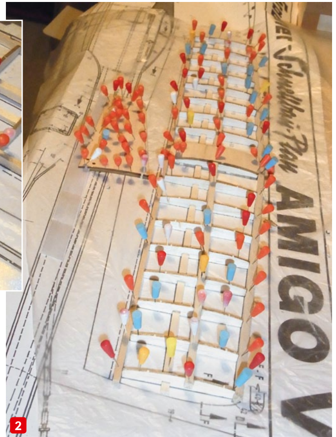
Zahlreiche Stecknadeln fixieren die Bauteile, sodass der Weißleim in Ruhe aushärten kann (1). Auch das Höhenleitwerk wird in Rippenbauweise gebaut und mit Papier bespannt (2)
