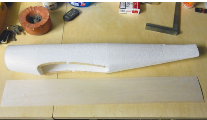
Wie gut CNC-geschnittene Rumpfe sein können, wird hier an der Aircobra ersichtlich, die bereit ist, mit Balsa beplankt zu werden
