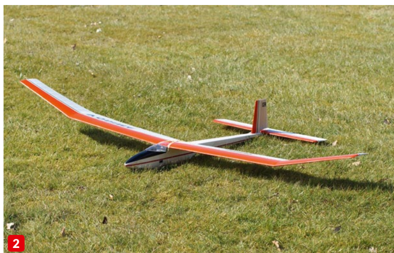
Auch ohne Bespannung macht der Amigo V schon einen guten Eindruck (1). Aus dieser Perspektive zeigt sich die große V-Form der Tragflächen (2). Das Loch in der Rumpfnase ist die Öffnung der Schleppkupplung für den F-Schlepp (3)
