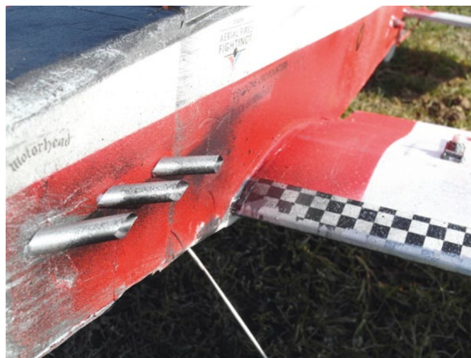
Wer Spaß daran hat, fügt Details hinzu - hier Auspuffrohre aus Strohalmstücken
