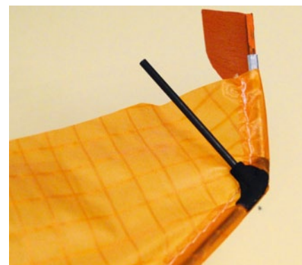
Mit den beweglichen Trimmstangen an den Flügelenden kann die Schränkung des Segels eingestellt werden
