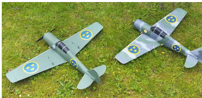
Flügel und Rumpfe der beiden FVVS J-22 bestehen aus CNC-geschrittenem Styro. Die Rumpfe sind mit Paketpapier sowie Parkettlack bespannt, die Flügel mit Balsa beplankt
