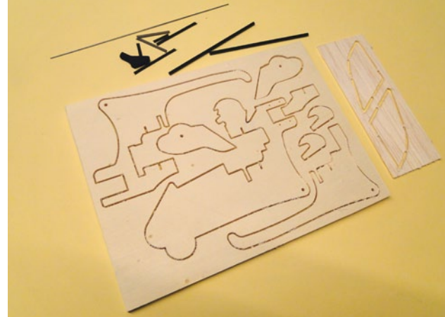
Die Holzteile für Trike und Winglets sind präzise gefräst
