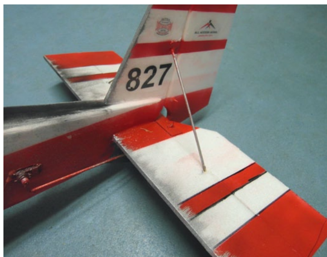
Schasklikspieße streben die Leitwerke ab und sorgen für Steifigkeit
