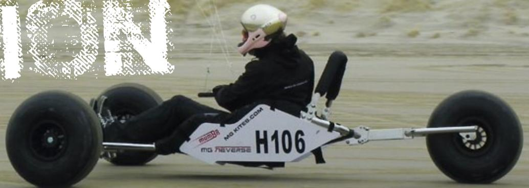
Der Reverse-MG ist ein ganz besonderer Kitebuggy, der von Maarten de Graauw vor allem als Fun-Projekt entworfen und gebaut wurde. Ein Dreirad mit lenkbarem Vorderrad und zwei starren Hinterrädern zu bauen war sicher die naheliegende Möglichkeit. Doch der Konstrukteur der Aero-Buggys wollte etwas ganz Neues machen – und so drehte er das Konzept des Buggys einfach um.
