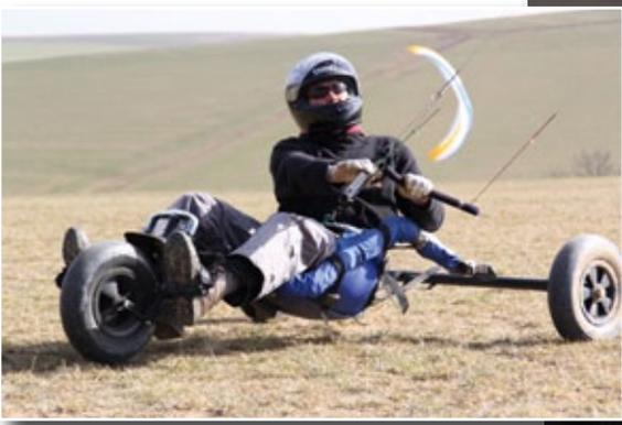
Ein leichter Buggy mit Standardrädern (hier ein Libre V-Max) läuft leichter an und bietet im Binnenland häufig Handling-Vorteile
