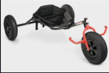
Der legendäre Freestylebuggy von Flexifoil ist seit einem Jahr als Model Scout erhältlich. Der Rahmen besteht aus pulverbeschichtetem Stahl. Die Deichsel ist in vielen Stufen verstellbar und auch die Justierbarkeit des Sitzes soll im Vergleich zum Vorgänger verbessert worden sein.
