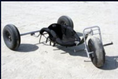
Dieser Edelstahlbuggy von Elliot ist robust aufgebaut. Rundum sorgt Moon-light-Bereifung für gutes Vorankommen. Der von Elliot verbaute Sitz bietet guten Seitenhalt und eine komfortable Rückenlehne, sodass man mit dem Virus perfekt zum Cruisen gehen kann, wobei die Achslänge von 150 Zentimetern Kippstabilität verschafft.
