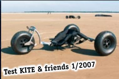
Der Cruiser ist das Einstiegsmodell von Buggy-Direkt, aber bereits ein komfortabel zu fahrender, spurstabiler Edelstahlbuggy. Serienmäßig verfügt der BBS-Cruiser über Moon-lights und ist für viel Seitenhalt und einer 140-Zentimeter-Hinterachse ausgestattet. Elegant ist die vordere Deichsel mit dem gebogenen Rundrohr gelöst.
