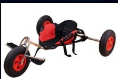
Zur Saison 2012 ist der Radsails-Buggy überarbeitet worden. Der Sitz ist jetzt ergonomischer geformt, durch EVA-Schaum gepolstert und mit sieben Spannern verstellbar. Der Rahmen ist aus Edelstahl gefertigt und soll im Detail verstärkt sein.
