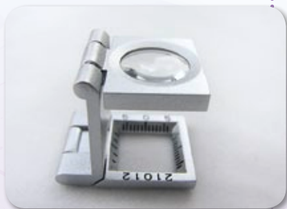
Um die Rooting-Fähigkeiten der Prüflinge exakt bewerten zu können, wurde ein Präzisions-Fadenzähler eingesetzt
