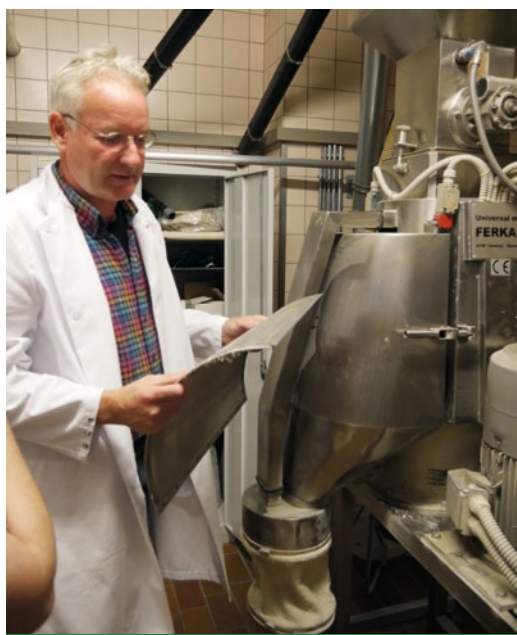
Olaf Knickrehm holt eines der Lochbleche, durch die das Getreide „geblasen“ wird
