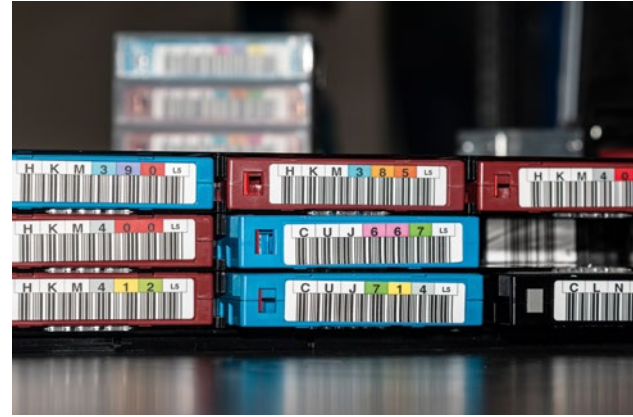
Für die Langzeitarchivierung von Daten sind Magnetband-Speichermedien besonders gut geeignet
