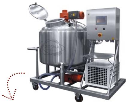
Für die automatisierte Sauerteigführung sind entsprechende Sauerteig-Anlagen notwendig, die den Prozess im Alltag erleichtern. Sie können optional die Teigführung anhand der pH-Werte steuern
