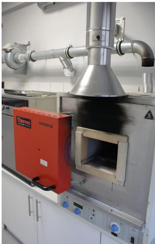
Im Muffelofen wird Mehl bei 900°C verbrannt, um den Masseverlust zu ermitteln. Die nichtbrennbaren Bestandteile entsprechen dem Mineralstoffgehalt des Mehls. Über das Verfahren lässt sich die Mehl-Type bestimmen
