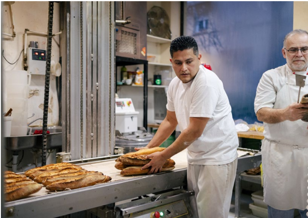
Be- und Entladesysteme verkürzen die Zeit offener Ofenklappen. Das spart Energie, weil weniger Wärme entweicht
