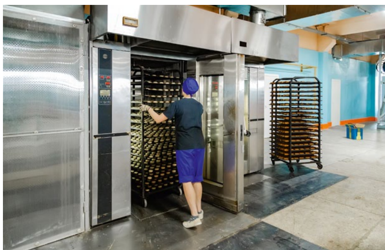
Dank der Wagenbeladung können Stikkenöfen per se schnell be- und entladen werden
