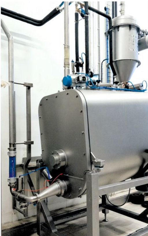
In entsprechenden Vorteiganlagen lassen sich die Teige kühlen. So regulieren sie auch die Hauptteig-Temperatur
