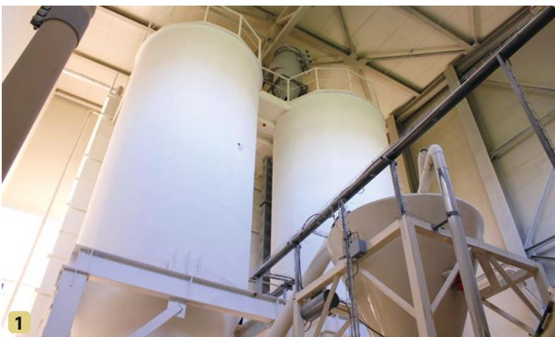
1) Silos müssen so gebaut sein, dass sowohl das Befüllen als auch die Entnahme des Mehls möglichst staubarm erfolgen. 2) Wer mit Mehlsäcken arbeitet, sollte sehr sorgsam mit ihnen umgehen
