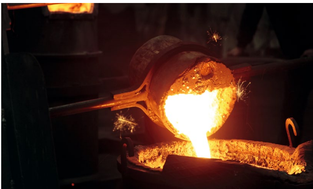
Bei Temperaturen von mehr als 1.150 Grad werden Gusseisen-Töpfe produziert
