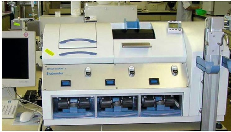
Im Extensographen wird der Teig mehrfach bis zum Zerreißen gedehnt. Aus dem Widerstand lassen sich Eigenschaften wie die Gärtoleranz, Teigstabilität und spätere Gebäckform ablesen
