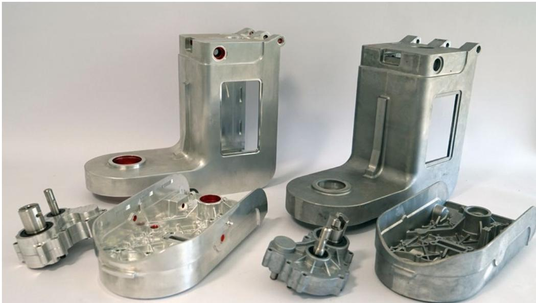
Während der Gehäuseentwicklung wurde zunächst ein Prototyp aus Aluminium gefräst (links), das Seriengehäuse entsteht im Alu-Druckguss (rechts)
