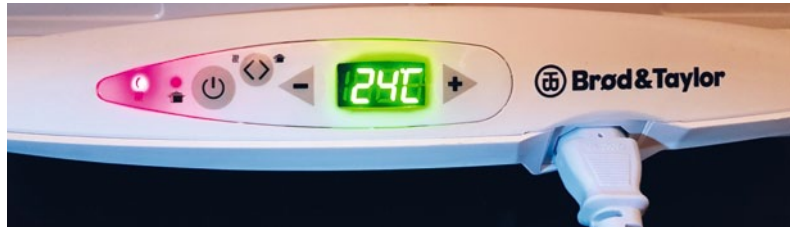
Der Automat arbeitet auch als Slow-Cooker, daher lassen sich Temperaturen zwischen 21 und 90 Grad herstellen
