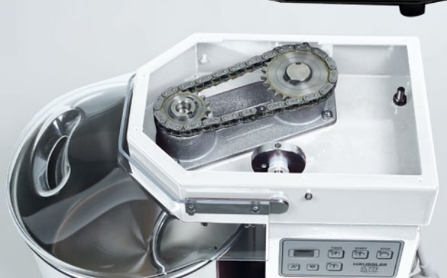
Per Kettenantrieb werden die 390 Watt des Häussler-Motors übertragen
