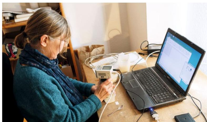
Heide Meyer ermittelt über ein spezielles Messgerät die Farbe des Erbsenmehls. Es wurde herausgefunden, dass sich aus Erbsen beispielsweise vegane Ersatzprodukte herstellen lassen. Vielleicht lösen Erbsen in dieser Hinsicht schon bald den Soja ab
