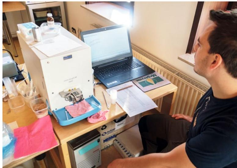
**Philip Schierning wiegt genau definierte Mehlmengen ab, die in einem Hightech-Mini-Kneiter mit einer vorgegebenen Wassermenge solange geknetet werden, bis die perfekte Konsistenz erreicht ist**
