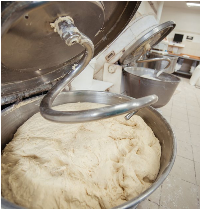
Professionelle Knetmaschinen kennen oft nur zwei Geschwindigkeiten
