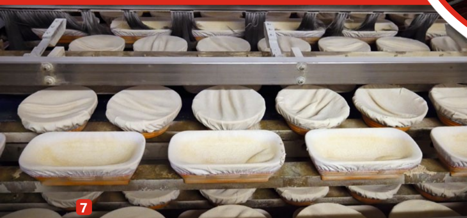
5) Die notwendige Spannung im Teigstück wird durch Rundwirken mit gegenläufigen Bändern aufgebaut. 6) In der Aufarbeitung wird das Teigstück für ein Weltmeisterbrot lang gewirkt und in einer Saatenmischung eingerollt. 7) In der Backanlage werden runde und längliche Garkörbe verwendet
