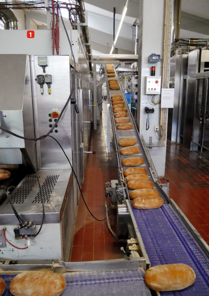
1) Nach dem Backen werden die Brote zur Verpackungsabteilung weiter transportiert. Auf dem Weg kühlen sie aus, bevor sie geschnitten und verpackt werden können. 2) Im großen Gärschrank entwickeln die Teigstücke in Gärkörben ihr Volumen. 3) Der Ofenauslauf entlässt je nach Backzeit und Brotsorte rund 2.700 Brote pro Stunde. 4) Toast und Sandwich wird bei Harry mit der Four-pieces-Methode gebacken. Dabei wird der Teigstrang geteilt und jedes der vier Teile um 90 Grad gedreht, bevor es in den Kasten fällt
