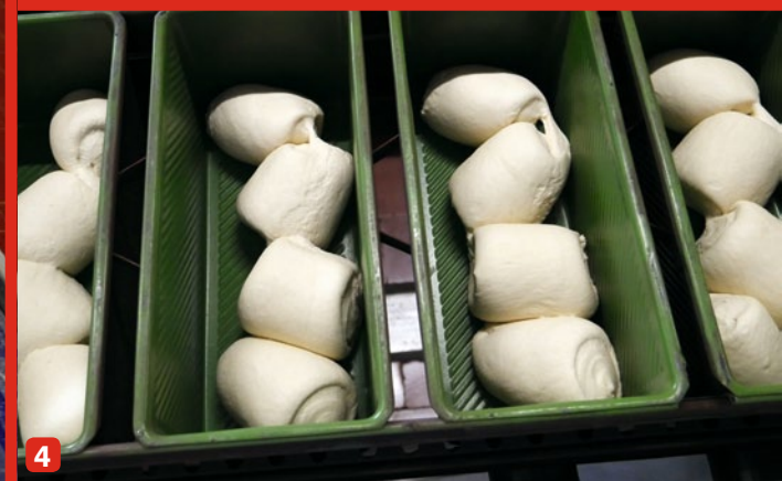
1) Nach dem Backen werden die Brote zur Verpackungsabteilung weiter transportiert. Auf dem Weg kühlen sie aus, bevor sie geschnitten und verpackt werden können. 2) Im großen Gärschrank entwickeln die Teigstücke in Gärkörben ihr Volumen. 3) Der Ofenauslauf entlässt je nach Backzeit und Brotsorte rund 2.700 Brote pro Stunde. 4) Toast und Sandwich wird bei Harry mit der Four-pieces-Methode gebacken. Dabei wird der Teigstrang geteilt und jedes der vier Teile um 90 Grad gedreht, bevor es in den Kasten fällt
