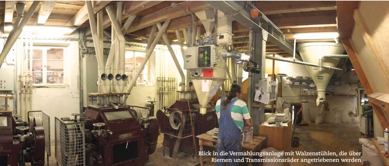
Blick in die Vermahlungsanlage mit Walzenstühlen, die über Riemen und Transmissionsräder angetrieben werden
