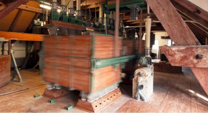
Im Sichter wird das Mahlgut nach jeder Mahlpassage mit 96 Sieben gesiebt und sortiert
