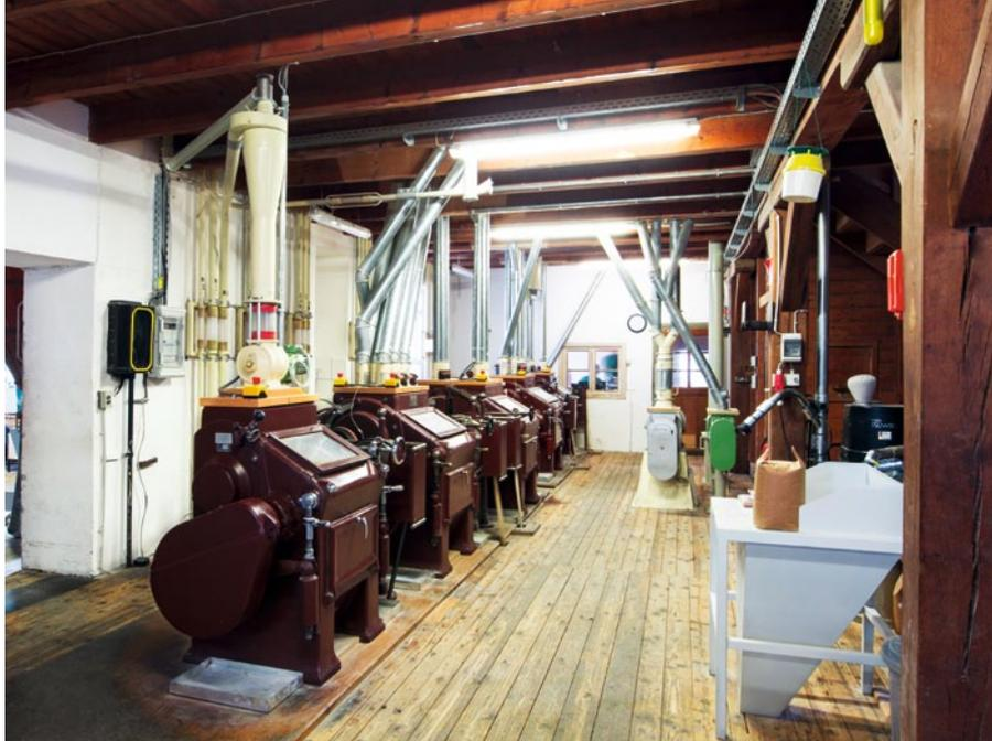
Mehl wird in mehreren Passagen (Zerkleinerungsstufen) produziert. Im ersten Schritt wird das Getreide auf dem Walzenstuhl geschrotet. Nach Sichtung und Siebung erfolgt eine Sortierung in Schalenteile, Grieße, Dunste, helle und dunkle Mehlteilchen. Die hellen Teile gehen direkt in den Mehlmischer, alle anderen werden auf den anderen Walzenstühlen weiter zerkleinert. So entsteht über 14 Passagen feines Mehl
