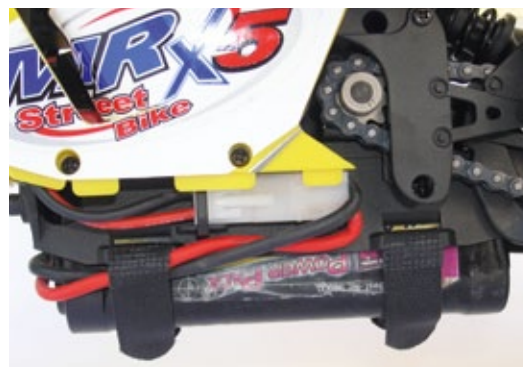
In das schwerpunktünstig unten am Chassis angebrachte, horizontale Akkufach passen herkömmliche Racingpacks
