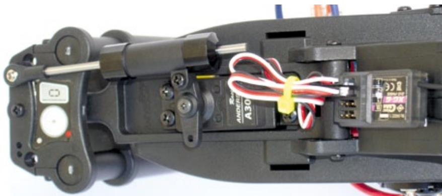
Zentral unter dem Fahrer ist das Lenkservo angebracht, welches die Vorderradgabel indirekt mit dem ölgefüllten Lenkungsämpfer ansteuert
