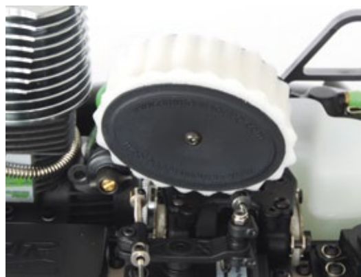
Den beiliegenden Luftfilter muss man noch ölen
