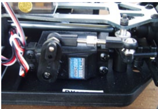
Das Lenkservo ist liegend montiert
