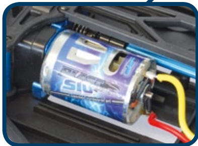
Bekannt aus allen Modellen der S10-Serie kommt auch im Short Course-Truck ein Bürstenmotor zum Einsatz
