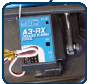
Eine 2,4-Gigahertz- Anlage gehört zum Lieferumfang. Der Empfänger ist auf dem Lenkservo platziert
