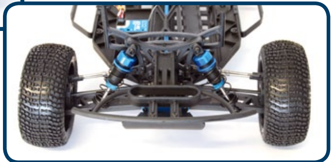
Öldruckstoßdämpfer mit Rändelschrauben und Rechts-links-Gewindestangen erlauben vielfältige Fahrwerkssetups
