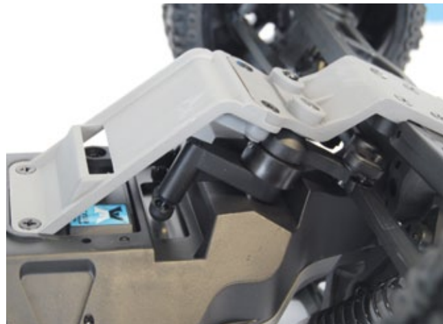
Das Lenkservo sitzt gut geschützt unter einer Abdeckung
