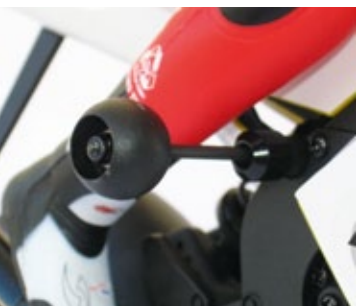
Bei maximaler Schräglage stützt sich das Modell auf den seitlichen Sturzrollen aus Kunststoff ab
