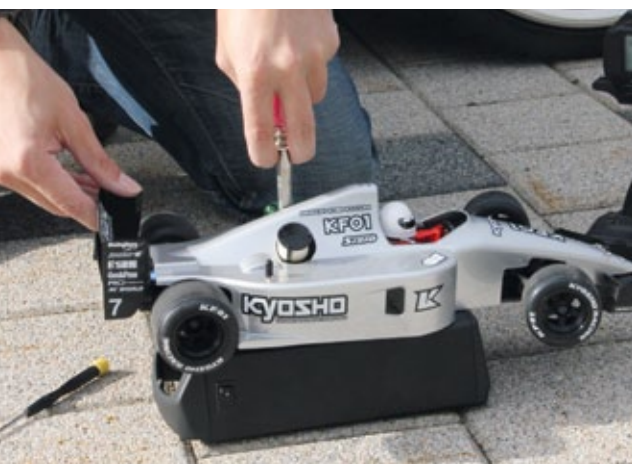
Zum Anlassen des kleinen Sirio-Motors ist eine spezielle Startbox erforderlich
