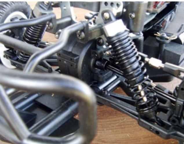
Die Dämpfergehäuse bestehen aus Kunststoff
