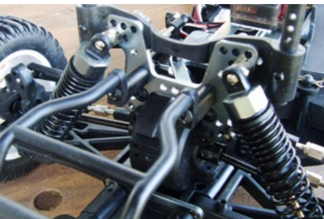
Für die Stoßdämpfer gibt es genügend Befestigungspunkte
