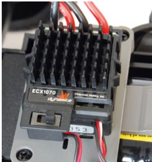
Der Dynamite-Regler verträgt 80 Ampere Dauer- und 240 Kurzzeitbelastung. Ein sanftes Regelverhalten zeichnet ihn aus
