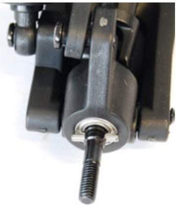
Klassisch: Der Sechskantmitnehmer der Felgen sitzt auf einem Quersplint der Radachse
