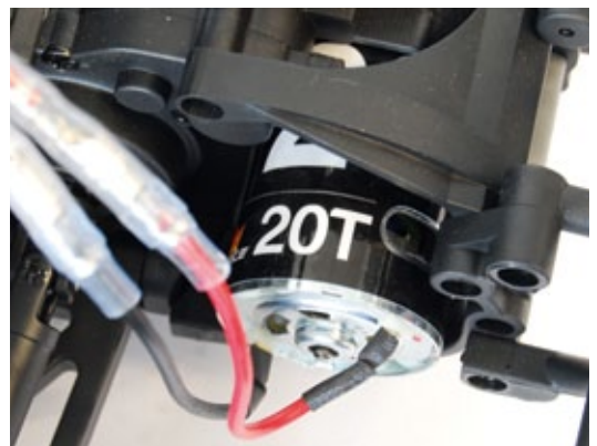
Der 540er-Bürstenmotor mit 20 Turns erledigt seine Aufgabe zuverlässig
