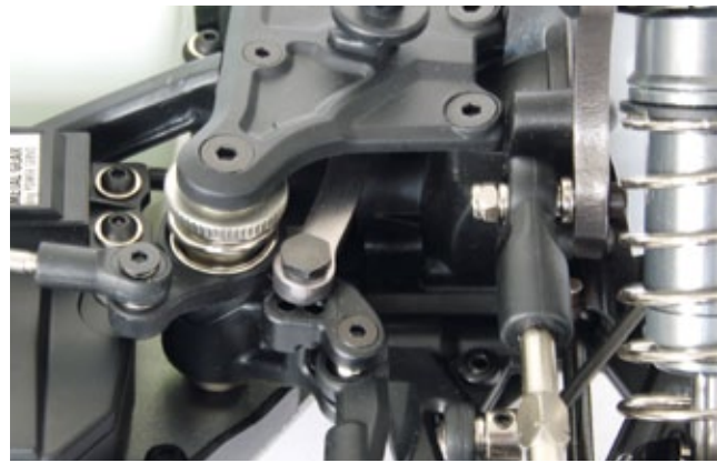
Der Ackermannwinkel lässt sich verstellen
