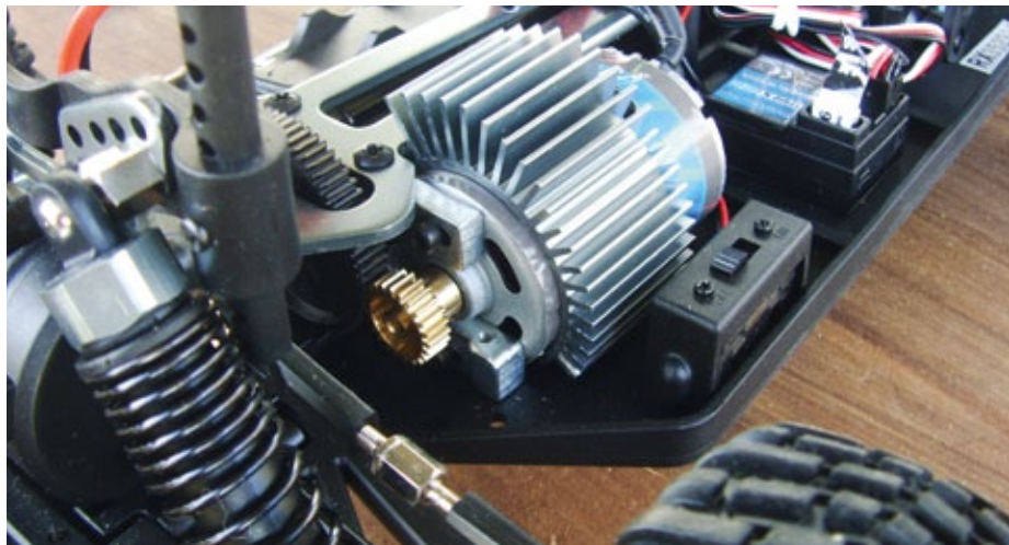
Die Kühlrippen und die Motorhalterung aus Alu sorgen für Wärmeableitung
