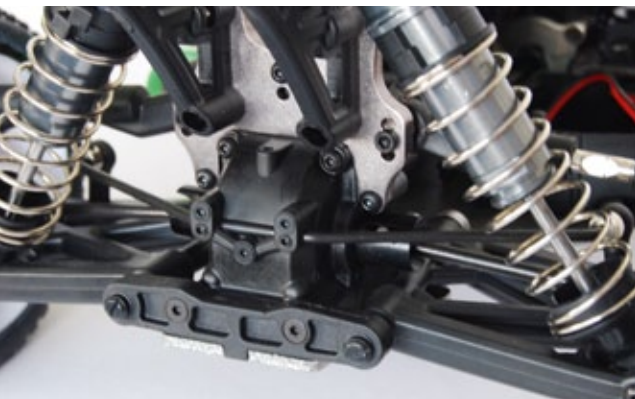
Stabilisatoren an Vorder- und Hinterachse vermindern das Rollmoment bei Kurvenfahrten
