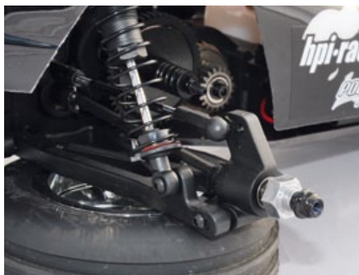
Sowohl an der Vorder- als auch an der Hinterachse sind Sechskantradmittennehmer montiert
