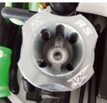
Der Motor freut sich über eine heiße, normale Kerze, die noch zusätzlich benötigt wird
