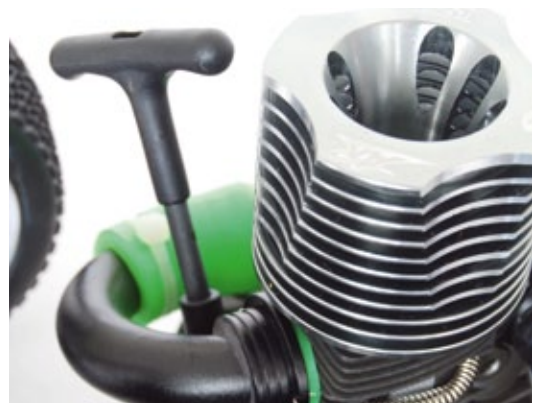
Ein Seilzugstarter erspart die sonst nötige Startbox
