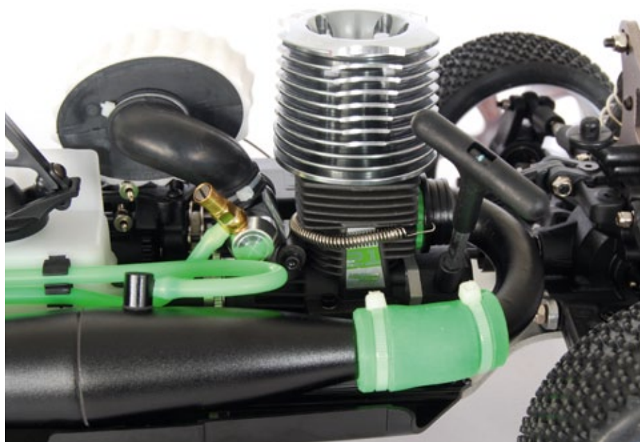
Der AR-21RS mit 3,5 Kubikzentimeter Hubraum bietet ordentliche Leistung
