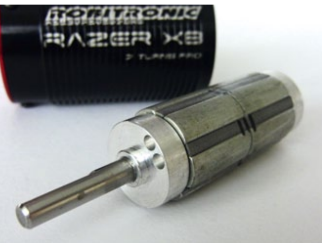
Der Robitronic-Rotor hingegen hat diese Bohrungen in den Alubuchsen vor und hinter den Magneten
