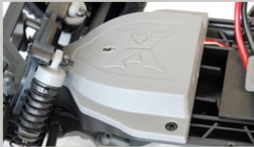
Der Empfänger sitzt gut geschützt in seiner Box. Lediglich das Antennenröhrchen ist noch zu montieren
