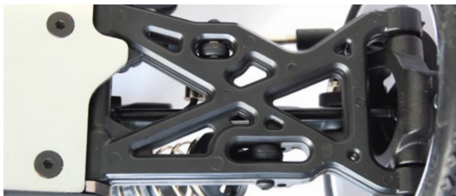
Die relativ breiten Querlenker sorgen für ein steifes Fahrwerk
