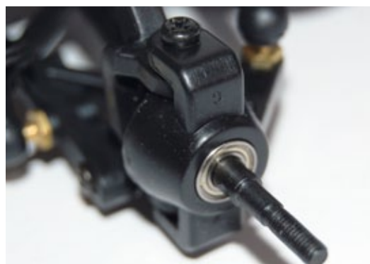
Kugellager sorgen für einen reibungsarmen Lauf der Räder
