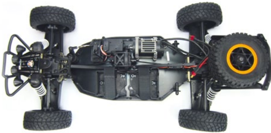
Ganz deutlich sind hier die Buggygene zu erkennen. Der verlängerte Radstand kommt der Laufruhe zu Gute
