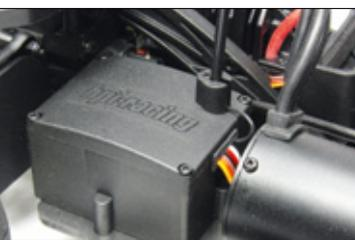
In der komplett abgedichteten RC-Box ist ein winziger 2,4-Gigahertz-Empfänger untergebracht
