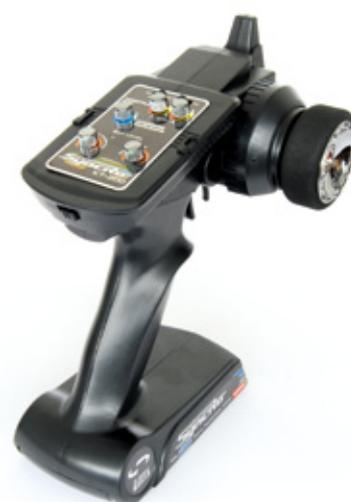
Die KT-200 von Kyosho ist eine 2,4-Gigahertz-Fernsteuerung, die alle relevanten Einstelloptionen bietet. Zum Betrieb der Anlage werden vier Mignonzellen benötigt
