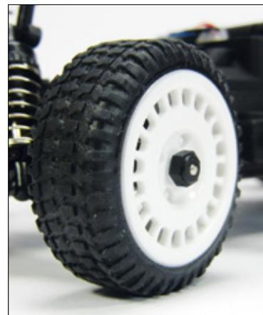
Die Rallye-Style-Felgen sind mit Hohlkammerreifen ausgestattet. Das aggressive Profil ermöglicht den Einsatz auf feinem Schotter, Asphalt, Teppich und anderen Untergründen
