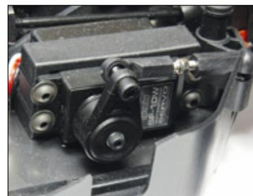
Das SF-10W-Lenkservo ist wasserdicht und wird durch einen Servosaver vor ungewollten Lenkstößen geschützt
