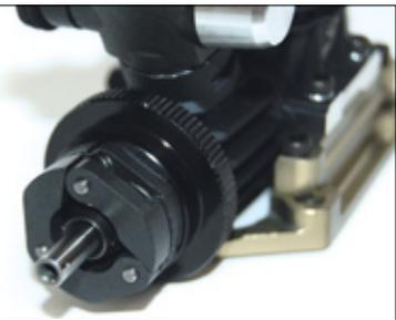
Die werkseitig beiliegende Dreibacken-Kupplung ist eine alte Bekannte aus den Vorgängermodellen des D812. Sie funktioniert nach wie vor prima
