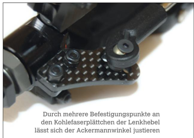
Durch mehrere Befestigungspunkte an den Kohlefaserplättchen der Lenkhebel lässt sich der Ackermannwinkel justieren
