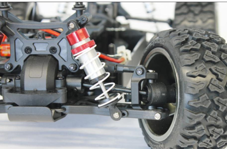
Die Achsen des RAGE VE basieren auf soliden Doppelquerlenkern, Aluminium-Öldruckstoßdämpfern und Stahlknochenwellen
