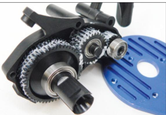
Das Getriebe des BMAX2 kann optional neben dem beiliegenden Kugeldiff auch mit einem Kegelraddifferential bestückt werden. Die Verzahnung ist in beiden Fällen stabil und kann auch mit stärkeren Motoren wartungsarm betrieben werden
