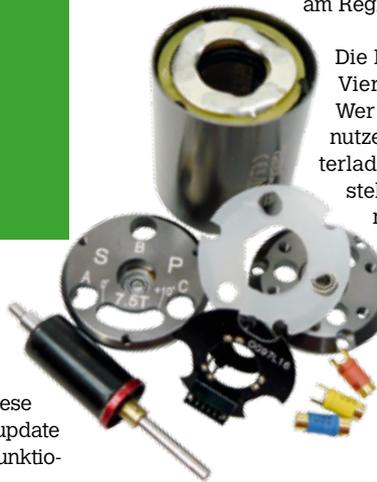
Der Speed Passion 7,5-Turns-Motor besteht aus sehr passgenauen und sauber gefertigten Teilen. Je nach Version hat das Gehäuse keine Kühlöffnungen, was gerade im Offroad-Bereich ein gern gesehenes Detail ist
