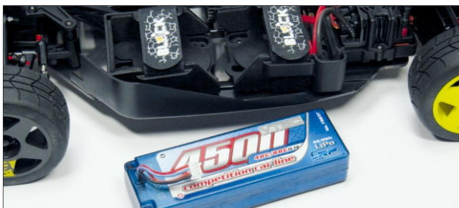
Der WR8 Flux kann nicht nur mit 2s-LiPos, sondern auf großen Flächen auch mal mit 11,1 Volt betrieben werden. Der LRP VTEC 3s-LiPo mit 4.500 Milliampere-stunden Kapazität und einer Entladerate von 40C ist dafür bestens geeignet
