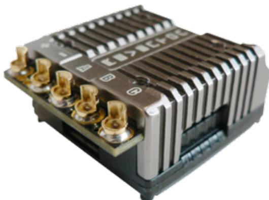
Die klare Beschriftung auf dem aus einem Block gefrästen Aluminiumgehäuse vereinfacht die Verkabelung, wohingegen die Lötstellen die vertikale als auch horizontale Anbringung der Kabel erlauben
