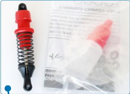
Ein Upgrade, das dringend nötig war: Die Stoßdämpfer lassen sich nun auch mit Öl befüllen. Das benötigte Material liegt dem Set bei
