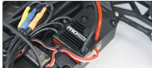
Der R10 One-Regler wiegt lediglich 38 Gramm, ist wasserdicht und für einen Dauerstrom von 25 Ampere ausgelegt
