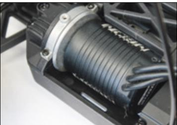
Die spezifische Drehzahl des NEONone-Brushlessmotors beträgt 2.400 Umdrehungen pro Minute und Volt. Das Aggregat ist ab Werk mit dem Regler verbunden
