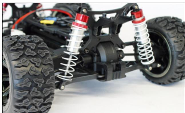
Die Stoßdämpfer an der Hinterachse sind relativ steil angestellt. Dies lässt sich über verschiedene Befestigungspunkte ändern
