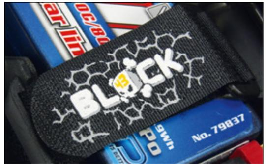
Der Akku wird beim HPI WR8 Flux mittels Klettbandern befestigt. Diese sind bei der Ken Block-Edition natürlich mit dem entsprechenden Logo versehen
