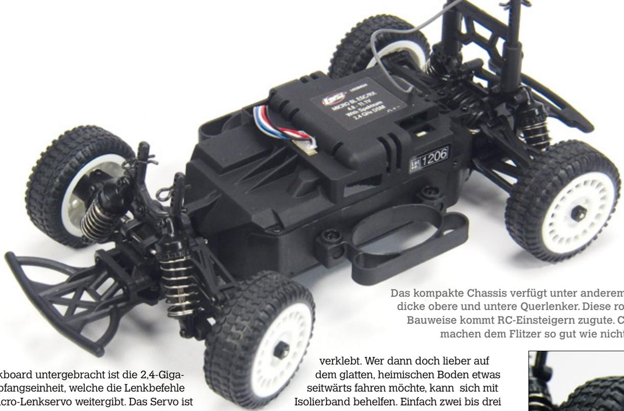
Das kompakte Chassis verfügt unter anderem über dicke obere und untere Querlenker. Diese robuste Bauweise kommt RC-Einsteigern zugute. Crashes machen dem Flitzer so gut wie nichts aus
