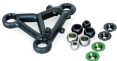
Die Dreiecks-Querlenker vorne und hinten sind standardmäßig auf Kunststoff-Kugeln gelagert. Nach dem Tuning glänzen hier Alu-Teile
