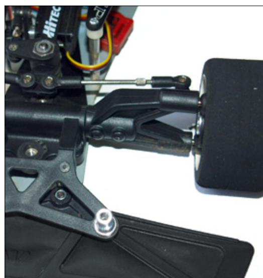
Spur und Sturz lassen sich vorne über die Pivot-Ball-Aufhängung und Rechts-links-Gewindestangen einstellen
