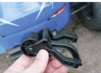
Der G2 kann mit der beiliegenden Wheeliebar ausgerüstet werden. Im 6s-Betrieb ist dies sehr sinnvoll
