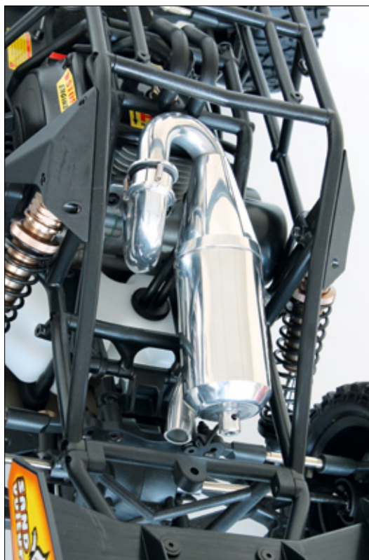
Was bei vielen Herstellern auf der Tuning-Teileliste steht, gibt es bei CS serienmäßig. So auch den Resonanz-Auspuff
