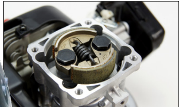
Eine Standard-Kupplung mit zwei Backen nimmt auf der Kurbelwelle Platz. Beim Testmuster war sie bereits montiert
