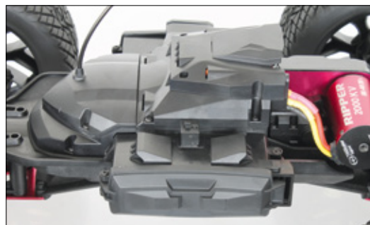
Ein Highlight des e-MTA-Chassis ist das komplett in faserverstärkten Kunststoff gefasste Mittelteil, das die elektronischen Komponenten schützt
