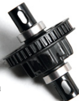
An der Hinterachse tut ein Kegeldifferenzial seinen Dienst. Es hat die bis vor wenigen Jahren gebräuchlichen Kugeldifferenziale als Standardbauteil abgelöst
