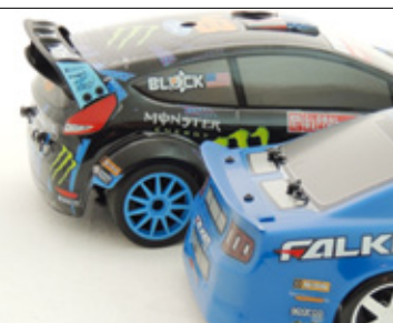
Kleiner Unterschied: Beim Ken Block-Fiesta sitzen die Karosseriehalter hinten, beim Mustang oben
