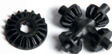
An der Hinterachse tut ein Kegeldifferenzial seinen Dienst. Es hat die bis vor wenigen Jahren gebräuchlichen Kugeldifferenziale als Standardbauteil abgelöst
