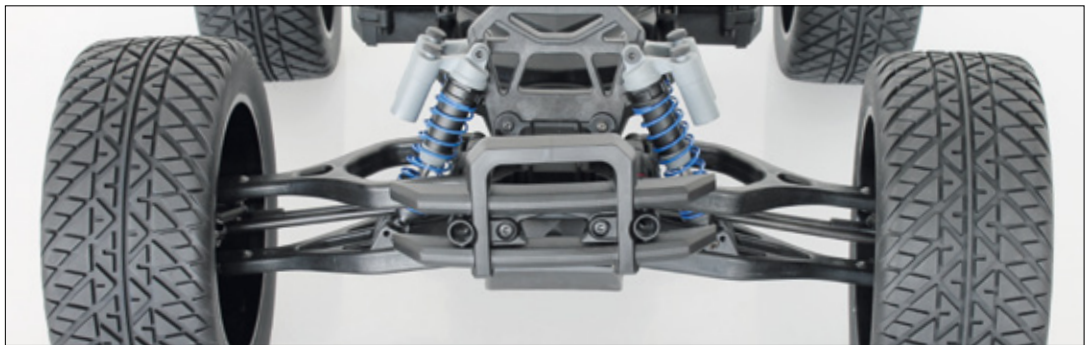
Die Vorderachse verfügt über Doppelquerlenker und CVD-Wellen, die das Diff mit den Radachsen verbinden
