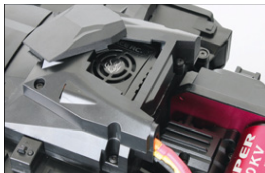
Mit 150 Ampere kann der aktivgekühlte-Regler des Typs ACE RC BLC-150C belastet werden
