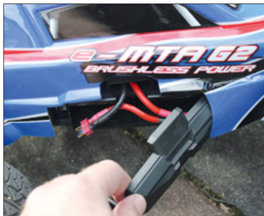
Der Akkuschacht ist bei aufgesetzter Karosserie zugänglich. Das Y-Kabel vom Regler ist mit Deans-Steckern versehen
