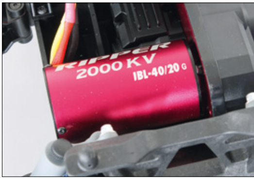
Der Ripper IBL40/20-Brushlessmotor ist quer zur Fahrtrichtung verbaut und hat eine spezifische Drehzahl von 2.000 kv
