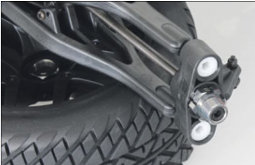
Die Einstellung der Achsgeometrie erfolgt über eine Pivot-Ball-Aufhängung. Auf den Radmitnehmern werden die neuen Straßenkomplettäder platziert
