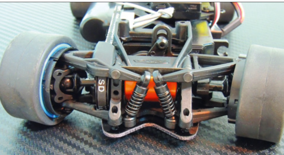
Die Vorderachsfederung mit Doppelquerlenkern und innenliegenden Federbeinen funktioniert erstaunlich gut
