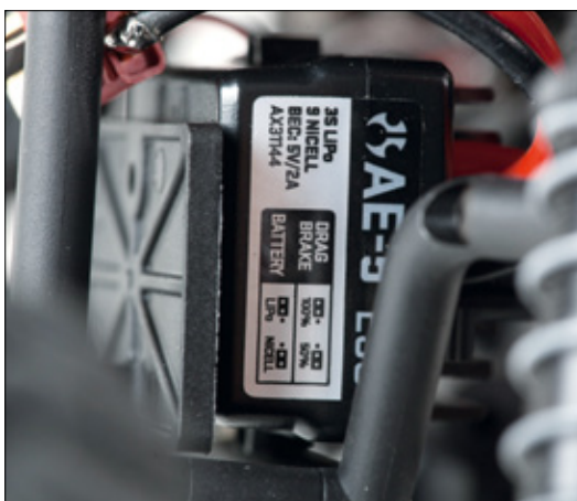
Der AE-5-Regler ist versteckt hinter einer Befestigungsplatte, unter der Fahrerfigur montiert. Leider ist die Halterung mit nur einer Schraube befestigt
