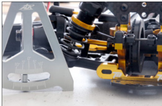
Bei einem größeren Nachlaufwinkel von 6 Grad ändert sich der Sturz mehr in Kurven. Gut für Asphaltstrecken, wo man immer nach mehr Lenkung sucht
