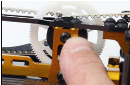
Diese Aluminiumscheiben sind maßhaltiger als die Plastikscheiben aus dem Baukasten. Es gibt sie in verschiedenen Stärken
