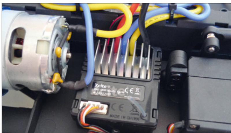
Regler und Empfänger sind in einem Bauteil untergebracht. Das macht einen Austausch oder eine Anpassung schwierig
