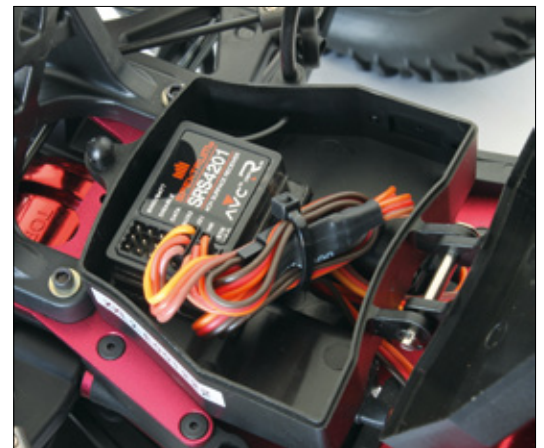
In der bekannten RC-Box ist viel Platz. Der Spektrum-Empfänger hat AVC an Bord
