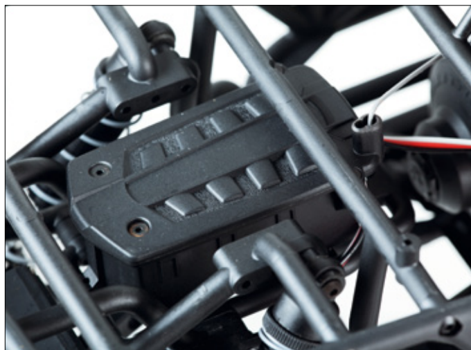
Unter der Motorhaube verbirgt sich die wasserfeste Empfängerbox. Wasserdurchfahrten zeigten, dass die Box wirklich dicht ist
