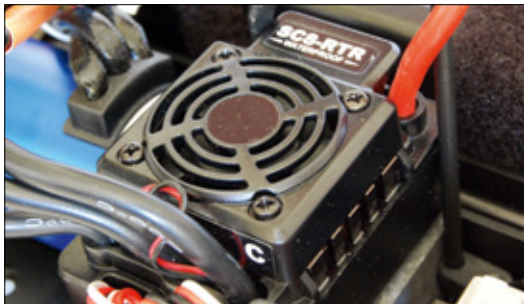
Mit der Bezeichnung SC8-RTR deutet der spritzwassergeschützte Fahrtenregler zumindest an, welchem Maßstab er eigentlich entstammt
