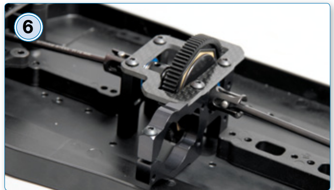
6 Der Slipper sitzt in der Mitte des Fahrzeugs. Alternativ kann man an seiner Stelle ein Kegeldifferenzial einbauen, das separat erhältlich ist
