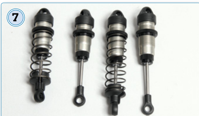
7 Die Big Bore-Stoßdämpfer des XB4. Sie sind gut verarbeitet und lassen sich mit den Tipps in der Anleitung luftfrei bauen
