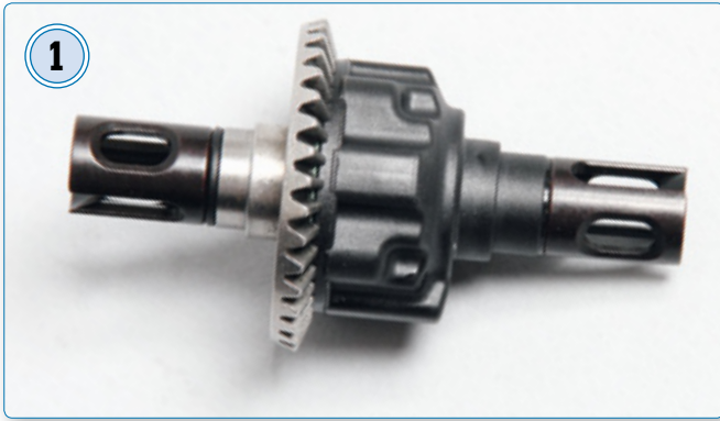
1 Eines der Kegeldifferenziale. Das Stirnrad ist aus massivem Stahl gefertigt. Die Ausgänge ebenfalls
