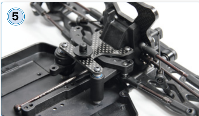
5 Die montierte Lenkung im Chassis. Eine kleine Kohlefaserplatte dient als Versteifung und als Befestigung für den vorderen Karosseriehalter
