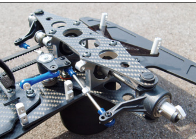
Vorne befindet sich eine Pendelachse mit Freilauf
