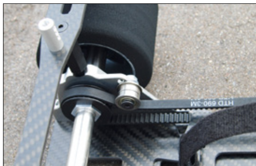
Über einen Riemen wird die Motorleistung von der Hinterachse nach vorne übertragen
