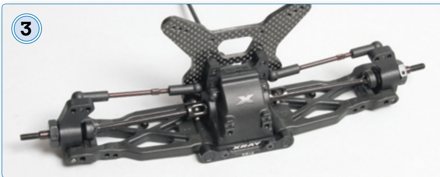
3 Die komplette Hinterachse. Die Kunststoffeinsätze am RR-Block und RF-Block (nicht sichtbar) verstellen die Vorspur und Spurbreite. Die oberen Querlenker verstellen den Radsturz und können an verschiedenen Punkten an Radträgern und Dämpferbrücken montiert werden
