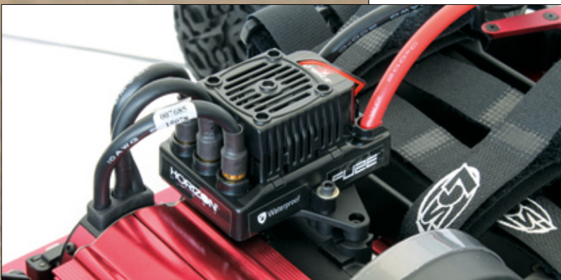
Der wassergeschützte 90-Ampere-Regler ist mit einem Lüfter ausgestattet und wird im Fahrbetrieb nur leicht warm
