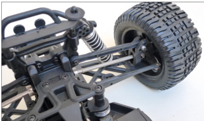
Die soliden Doppel-Querlenkerachsen bieten zwar keine Einstellmöglichkeiten, richten sich jedoch auch an Einsteiger, wo so etwas nicht unbedingt notwendig ist
