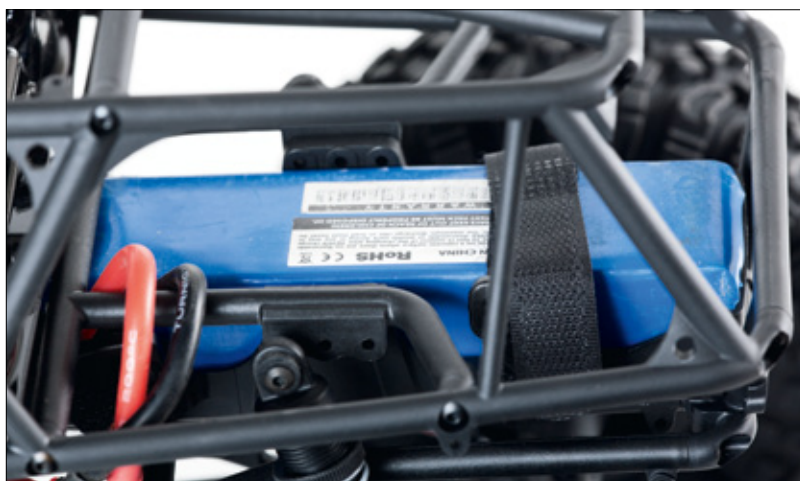
Ein starker 3s-LiPo mit einer Kapazität von 5.000 Milliamperestunden findet spielend Platz im Akkufach
