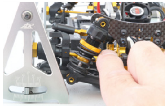
Hier sind 5 Millimeter innen am oberen Querlenker unterbaut. Voll eingefedert ändert sich der Sturz (Grundeinstellung 1,5 Grad) kaum
