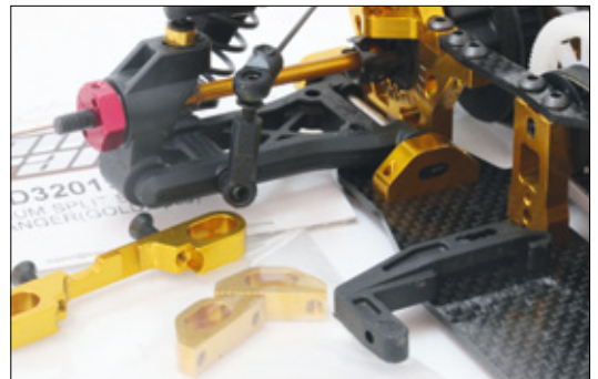
Hier sind die geteilten Spurböcke (TD320192) montiert, die für mehr Flex sorgen. Daneben liegt der originale Spurblock
