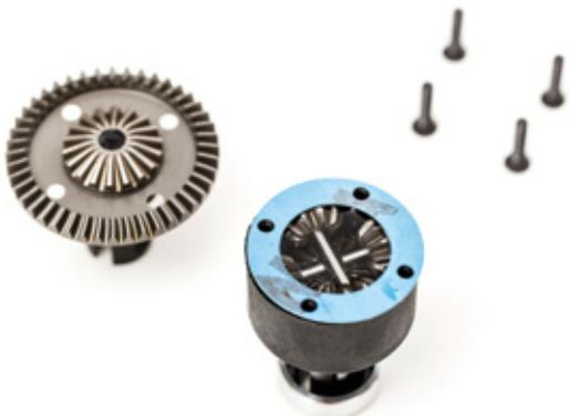
Eine Papierdichtung hält das Kegeldifferential dicht. Gut zu sehen sind die Kegelräder aus Stahl
