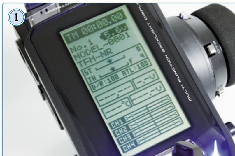
Alle wichtigen Parameter direkt im Blick: Möglich macht dies das große, hintergrundbeleuchtete LC-Display der T4PV
