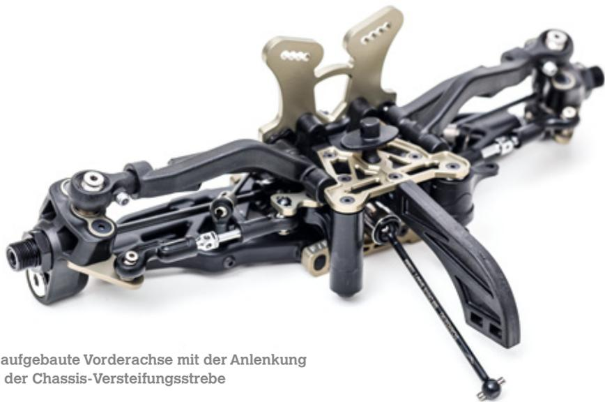
Die aufgebaute Vorderachse mit der Anlenkung und der Chassis-Versteifungsstrebe
