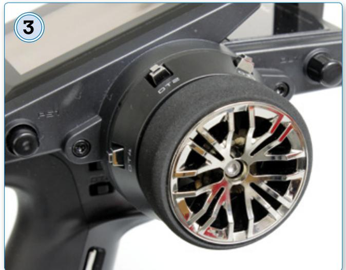
Das Lenkrad mit Moosgummi-Überzug ist in Multispeichen-Optik ausgeführt. Rundherum sind insgesamt vier Taster platziert
