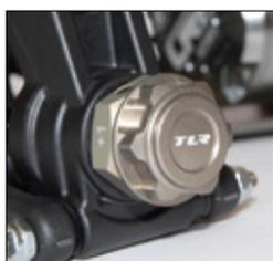
Losis geschlossene Radmuttern sind serienmäßig im Lieferumfang enthalten. Sie verhindern das Eindringen von Schmutz in die Radachse und damit in die Madenschraube der Radmitnehmer-Fixierung
