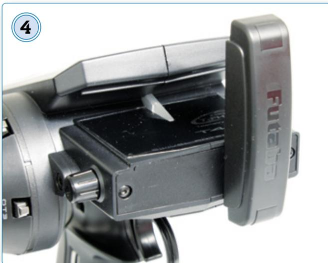
Die Antenne der T4PV ist um 90 Grad schwenkbar. Klappt man sie nach unten, schließt sie bündig mit dem Sendergehäuse ab
