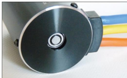
Das hintere Lager lässt sich mit Aluminiumklebeband optimal vor Schmutz und Staub schützen, ansonsten verfügt der Motor über keine im Offroad-Bereich hinderlichen Kühlöffnungen
