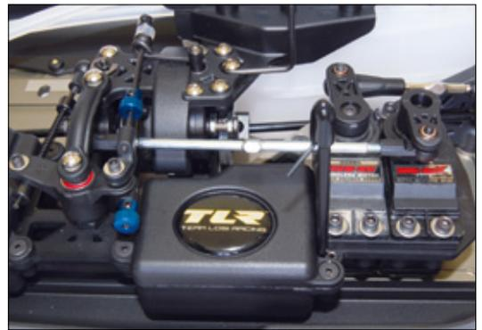
Durchaus speziell erscheint die Konstruktion der Elektronikbox. Die zwei parallel platzierten Servos erfordern neben der Lenkmechanik auch ein Gestänge für Gas und Bremse. Gut zu erkennen ist die kurze, bogenförmige Strebe links im Bild. Sie sorgt dafür, dass die Elektronikbox beim Bremsen nicht zum Mitteldiff gezerrt wird
