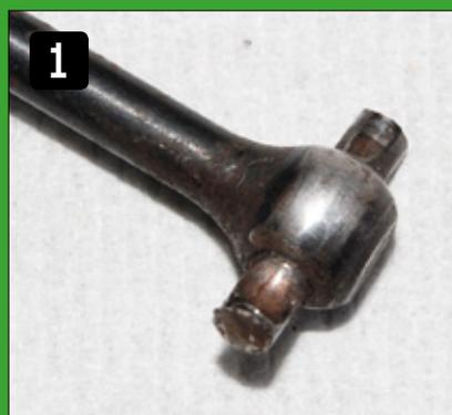
Typischer Anblick: So oder so ähnlich sehen Knochengelenke früher oder später aus. Besonders auf der Seite, die beim Beschleunigen belastet wird, verliert der Splint mehr und mehr an Materialstärke, bis er irgendwann bricht. Ein solches Verschleißbild bedarf der Abhilfe. Verloren ist eine solche Welle noch lange nicht
