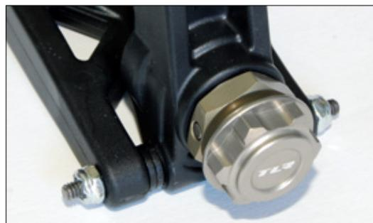
17-Millimeter-Radmitnehmer sind bei Offroadern dieses Maßstabs obligatorisch. Dazu spendiert Losi dem 8ight-T geschlossene Radmuttern, die das Eindringen von Schmutz in die Radachsen unterbinden
