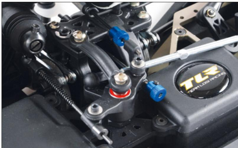
Der bekannte Umlenkhebel für die Ansteuerung von Gas und Bremse ist nun kugelgelagert und zusätzlich zur Bremseinheit verstrebt
