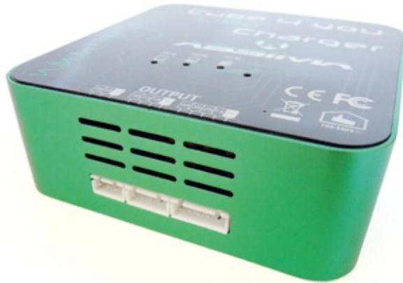
Der direkte Anschluss des Balancerkabels ist zugleich auch der Ladeanschluss beim kleinen Cube 4 You, es ist allerdings immer nur einer der Anschlüsse nutzbar, nicht zwei gleichzeitig
