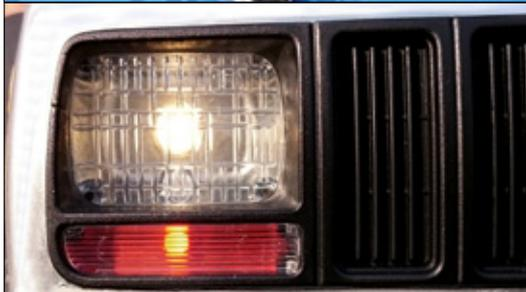
Die Frontmaske ist für den Einbau von LED vorgerüstet. Durch die verschraubbaren Abdeckungen kommt kaum Streulicht ins Innere des Cherokee. Nachdem der Lampenspiegel des Scheinwerfers silber lackiert wurde, kommt die Streuscheibe an ihren Platz. Dadurch entsteht ein realistisches Erscheinungsbild
