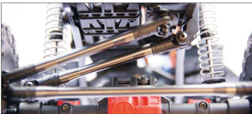
Beim Panhardstab erkennt man die optimale Position der Anschlagpunkte. Sie verhindern, dass die Achse beim Ein- und Ausfedern seitlich versetzt
