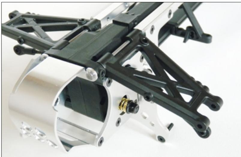
Die veränderte Konstruktion der neuen Differenziale sorgt vor allem an der Hinterachse für eine deutliche Verbesserung bei der Stabilität und Belastbarkeit
