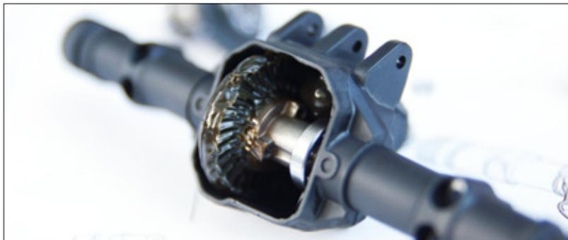
Die einteilige Achse beherbergt das gesperrte Differential. Hier sollte man mit dem Fett nicht sparen. Abgedichtet wird das Diff von einem stramm sitzenden, roten Differentialdeckel, der mit der Achse verschraubt wird
