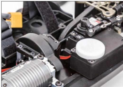
Leider ist die Empfängerbox etwas klein geraten. Um Platz für die Empfängerkabel zu schaffen wurde ein Loch in den Deckel gebohrt und mit Heißkleber eine kleine Abdeckung befestigt
