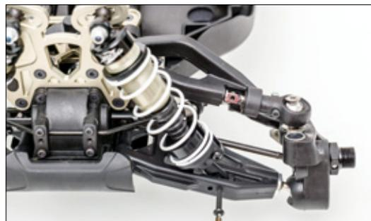
Die Vorderachsaufhängung im Detail. Für den Stoßdämpfer gibt es oben fünf und unten zwei Befestigungspunkte
