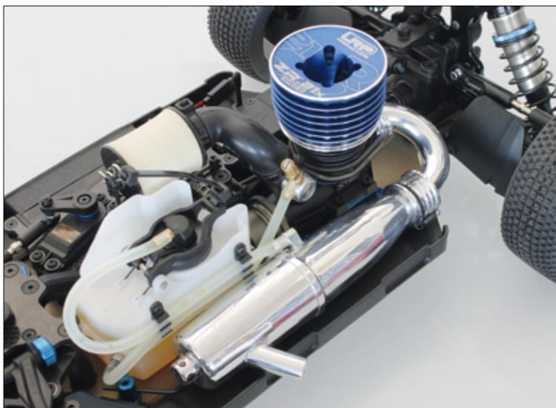
Für ordentlich Vortrieb des Buggys sorgt der LRP ZR.21x Spec 3-Motor mit Screamer 93-Reso-Rohr
