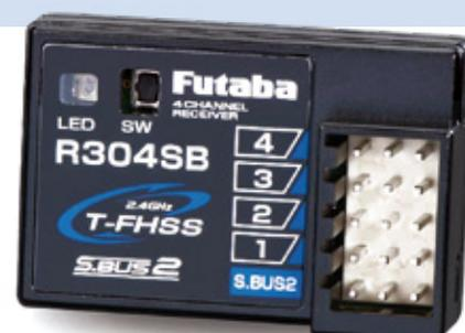
Zum Lieferumfang der T4PV gehört ein Vierkanal-Empfänger des Typs R304SB
