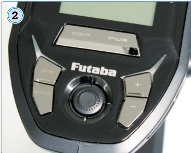
Die Menüführung erfolgt über den zentralen 3D-Button sowie die angrenzenden Taster. Darüber befindet sich der Ein-aus-Schalter
