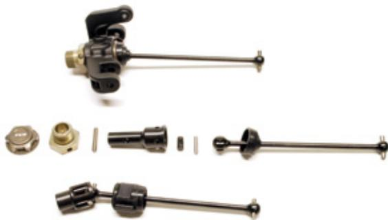
Während die beiden zentralen Antriebswellen als klassische Knochen ausgeführt sind, kommen an den Radachsen CVD-Gelenkwellen zum Einsatz. In beiden Fällen verhindern sogenannte Dog-Bone-Boost das Verschmutzen der schwer beanspruchten Gelenke
