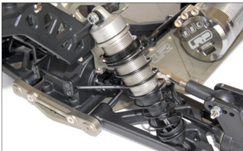
Den Stoßdämpfern eines Offroaders werden elementare Aufgaben zuteil. Sie sorgen dafür, dass die Räder möglichst durchgehend Kontakt zum Untergrund erhalten. Die Dämpfer des 4.0 lassen sich sowohl im Bladder-, als auch im Emulsions-Verfahren bestücken
