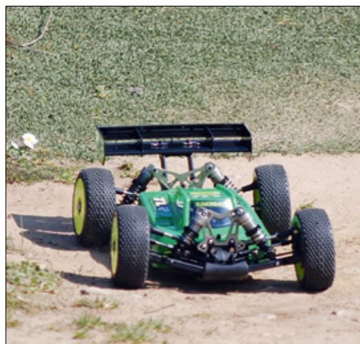
Selbst hohe Belastungen wie beispielsweise beim Landen nach einem Sprung stecken die Aluminium-Stoßdämpfer mit ihren langen Arbeitswegen locker weg
