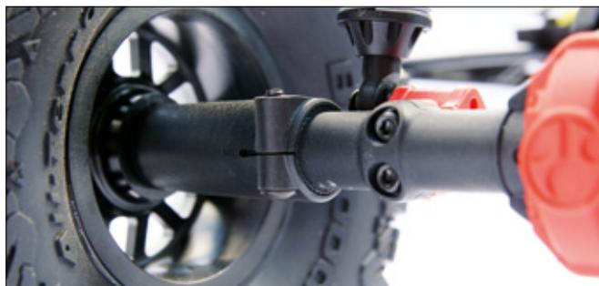
Die hinteren Lockouts und vorderen C-Hubs werden auf einer Längsverzahnung montiert und mit je einer Schraube gesichert
