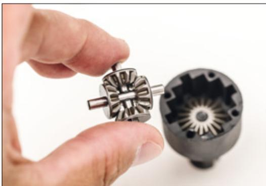
Vierspider-Kegelräder in die Nuten einsetzen
