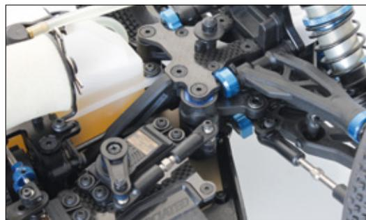
Die beiden Sanwa-Servos vom Typ ERS-962 passen perfekt zum RC8B3. Die gesamte Lenkmechanik des Buggys ist kompakter als beim Vorgänger-Modell
