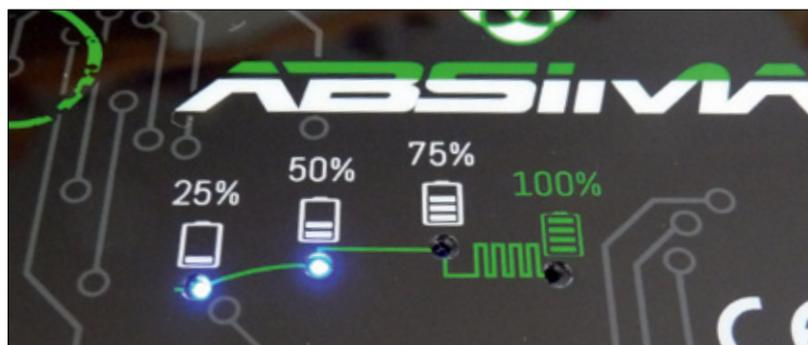
Ab einem Ladestand von 75 Prozent wird vom CC- auf das CV-Verfahren umgeschaltet. Benötigt man rasch einen möglichst vollen Akku, lohnt es sich, diesen beim Aufleuchten der 75-Prozent-LED abzuklemmen, real sind dann bis zu 85 Prozent eingeladen
