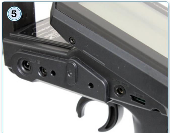
Auf der linken Senderseite finden sich eine Reihe von Ports: ein Servo-Anschluss, eine Kopfhörer- sowie die Ladebuchse
