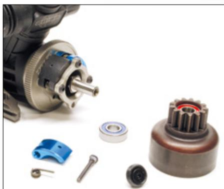
TLRs erprobte Vierbacken-Kupplung ist serienmäßig mit zwei Alu- und zwei Composite Backen bestückt
