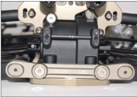
Die tragenden Teile der Aufhängung bestehen aus sauber gefrästem Aluminium
