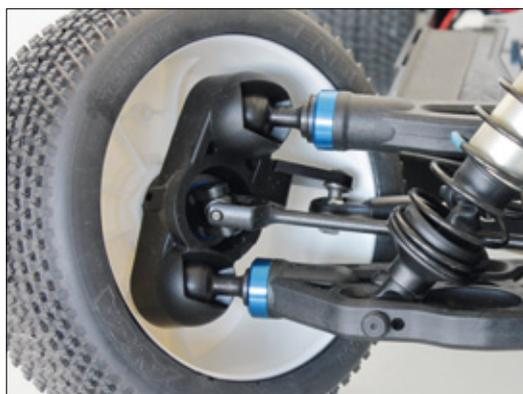
Eine der markantesten Neuerungen am RC8B3 ist das Pivot-Ball-System an der Vorderachse
