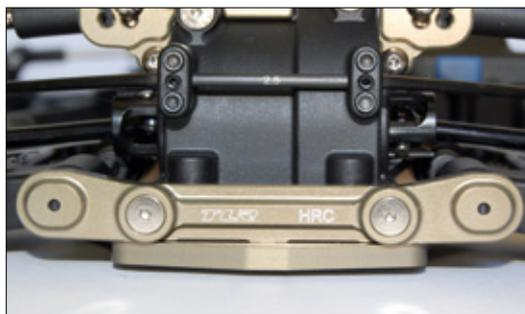
Im Bereich der Aufhängung setzt Losi auf unsere Querlenkerhalter aus Aluminium. In ihnen findet darüber hinaus ein Buchsensystem seinen Platz, mit dem die zentrale Fahrwerksgeometrie abgepasst werden kann
