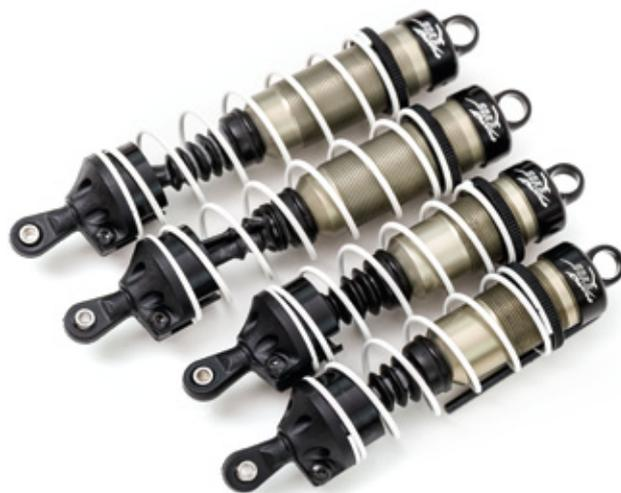
Die komplett montieren Stoßdämpfer. Der untere Federteller ist mit der Kugelpfanne gegen Verdrehen mit einer Schraube fest verbunden
