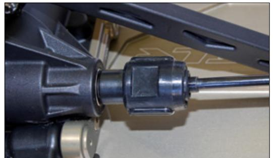
Gummitüllen über den Gelenken der Antriebswellen ermöglichen die Versorgung mit Fett. Dadurch sinkt die Reibung und die Wellen halten deutlich länger
