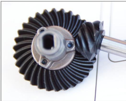
Der hypoid-verzahnte Antrieb in den Achsen lässt eine Achsuntersetzung von 30:8 (3,75:1) gegenüber dem ersten SCX10 mit einer Untersetzung von 38:13 (2,92:1) zu. Diese höhere Untersetzung vermindert den Torquetwist des Modells
