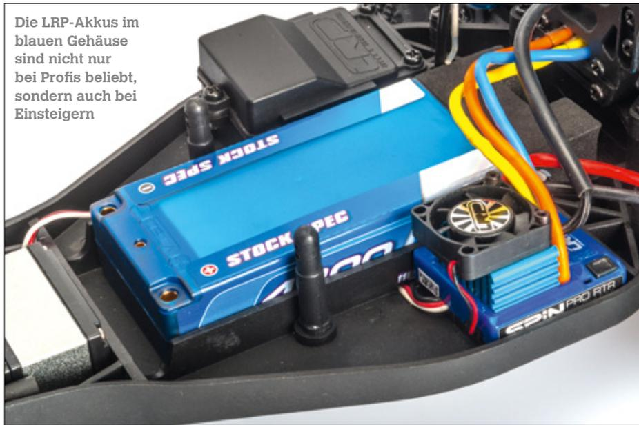
werdenden Akkutechnologie, die diese hohen Ströme überhaupt erst erlaubt. Die Akkus haben mittlerweile so geringe Innenwiderstände, dass sehr hohe Peakströme möglich sind. Diese sind aber für die Akkus schädlich. Braucht ein RC-Modell viel Strom, liefert der Akku diesen – egal ob es ihn überlastet. Die Herausforderung besteht darin, die Akkus so zu konzipieren, dass sie sich nicht selbst schaden.
