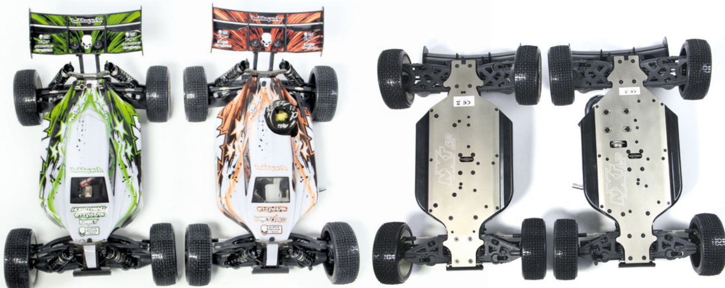
Auf der Chassis-Unterseite sind alle Innensechskantschrauben versenkt, bei der Nitroversion (rechts) ist eine zusätzliche Öffnung für die Schwungscheibe vorhanden
