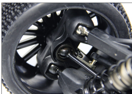
An der Vorderachse der Buggys sorgen CVD-Antriebswellen für eine perfekte und spielarme Kraftübertragung an die Räder
