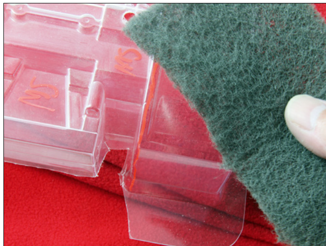
Links im Bild kann man erkennen, dass hier schon angeschliffen ist, rechts im Radlauf noch nicht
