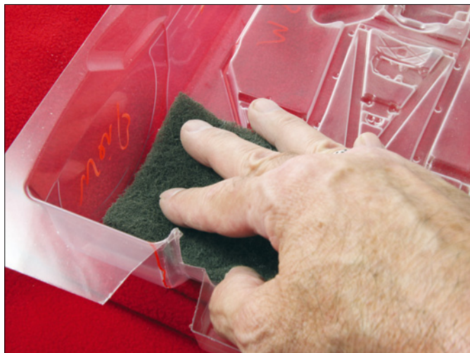
Mit Schleifvlies wird die Innenseite der Karosserie angeraut, so haftet die Farbe besser
