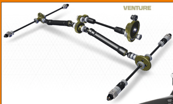
Der Bürstenmotor treibt über den stabilen Antriebsstrang alle vier Räder an
