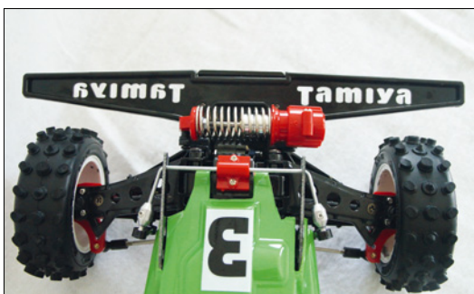
Leider laufen die Differenziale nur in Messinggleitlagern
