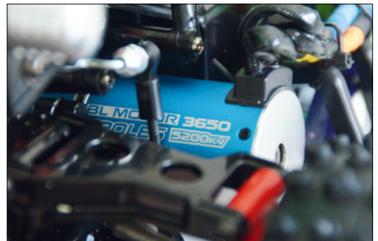
Ein Brushlessmotor mit 5.200 kv sorgt für enormen Vortrieb in jeder Lage
