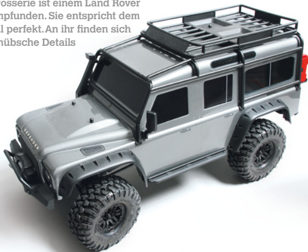
5 Die beiden Starrachsen verfügen über sperrbare Differenziale und sind ebenfalls recht vorbildgetreu gestaltet
