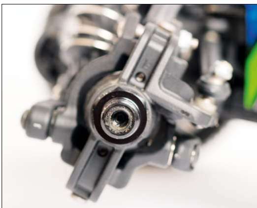
An der Vorderachse kommen solide C-Hub-Konstruktionen zum Einsatz
