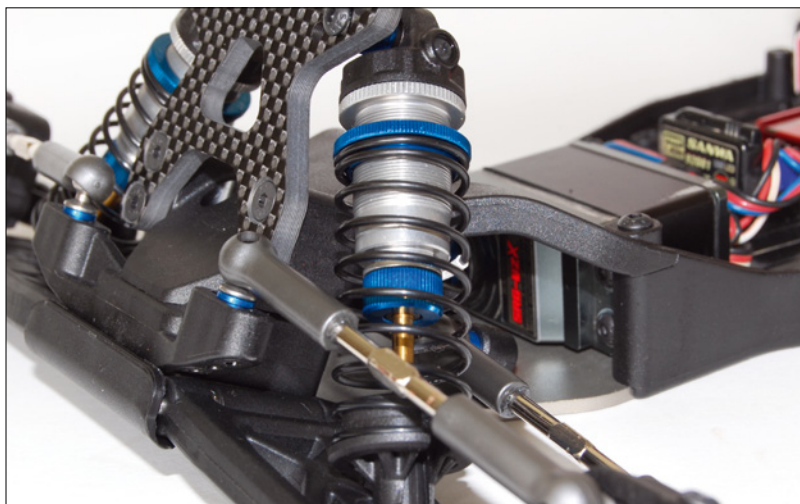
Stoßdämpfer zählen zu den wichtigsten Baugruppen eines Offroaders. Beim Asso finden sich präzise gefertigte Ausführungen in kurz für die Front und zwei längere Pendants am Heck
