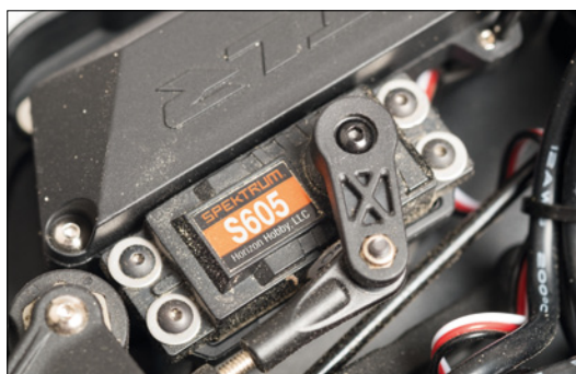
Hinter dem Servo ist die Empfänger-Box verbaut. Sie ist mit einer Dichtung versehen, um Wassereintritt zu verhindern
