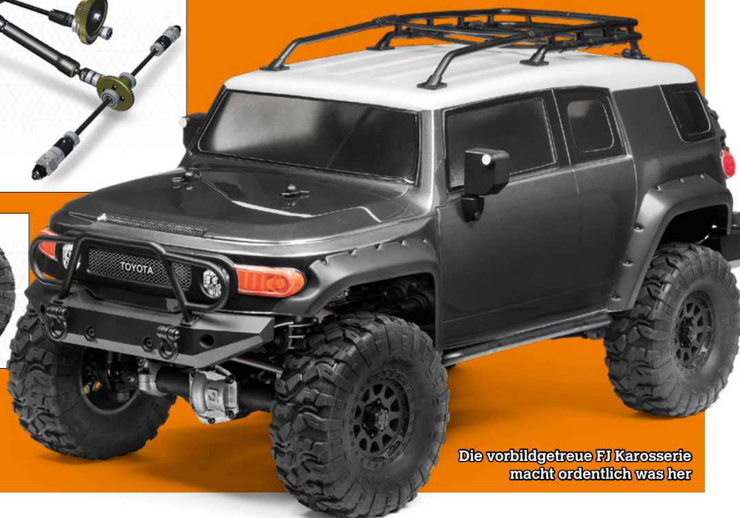
Der Bürstenmotor treibt über den stabilen Antriebsstrang alle vier Räder an
