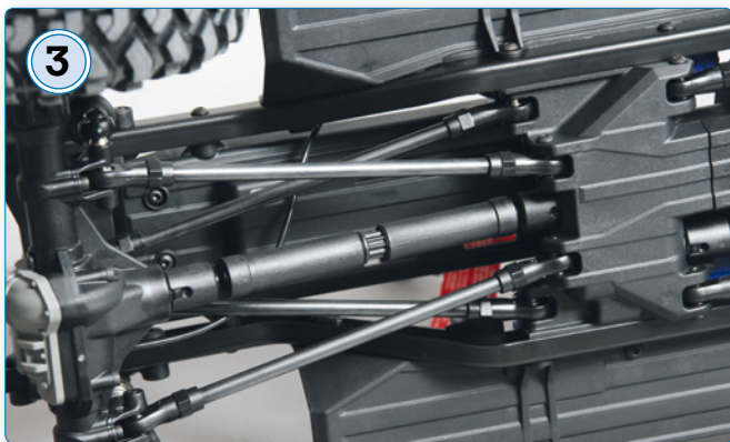
3 Der Antriebsstrang des TRX-4 ist Scaler-typisch mit Teleskopantriebswellen ausgestattet
