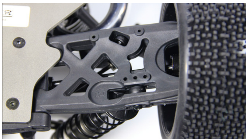
Die unteren Querlenker der Hinterachse machen ebenso einen sehr guten Eindruck und bieten drei Aufnahmen für die Stoßdämpfer und den Stabilisator, der hier ebenfalls zur Ausstattung gehört
