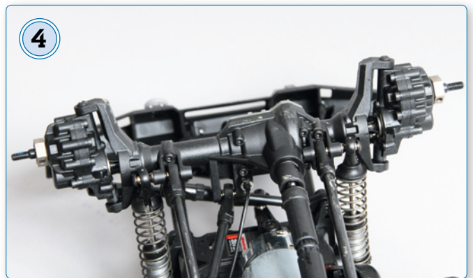
4 Die vordere Portalachse mit den beiden Unterstellungen zwischen Antriebswelle und Felgenmitnehmer
