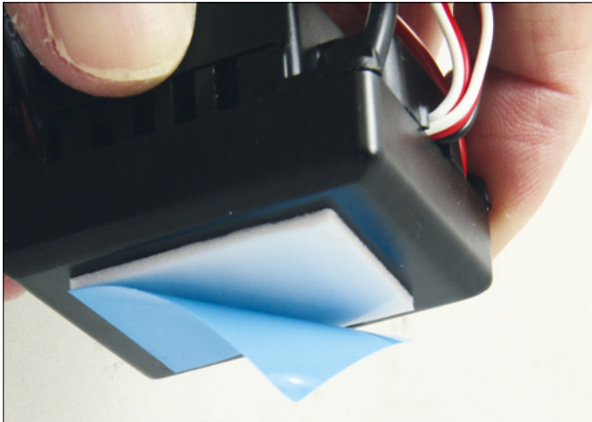
Üblicherweise wird doppelseitiges Klebeband verwendet, um Regler und Empfänger im Chassis zu fixieren
