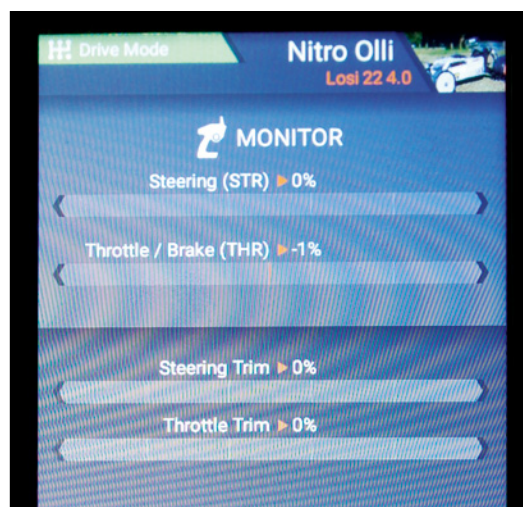
Per Monitor-Funktion lassen sich die eingestellten Arbeitswege und Nullpunkte der Servos kontrollieren
