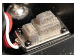
Der vor Staub und Spritzwasser geschützte Schalter ist neben dem Regler zu finden. Es ist etwas fummelig ihn bei montierter Karosserie zu betätigen. Dazu ist es nötig, die Karosserie etwas zur Seite zu biegen
