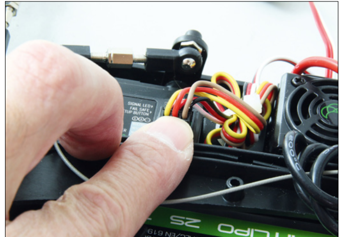
Die Kabel von Servo und Regler werden mit braunem beziehungsweise schwarzem Kabel Richtung Minus gesteckt
