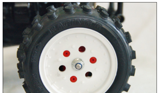
Weißer Felgen mit griffigen Noppenreifen verleihen dem Hot Shot im Gelände ausreichend Grip. Die Verbindung zur Radachse funktioniert mit einer roten Plastikträgerplatte. Der Einsatz anderer Felgen ist daher nur schwierig möglich
