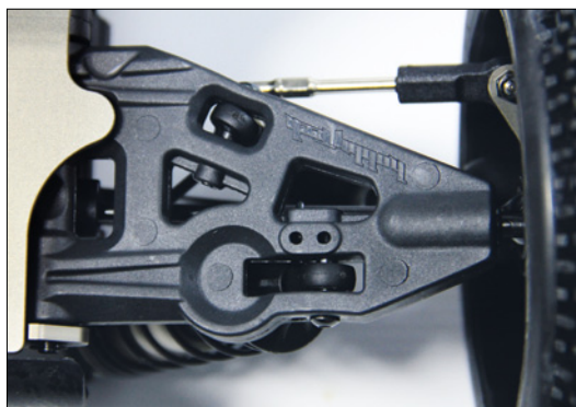
Die vorderen Doppel-Querlenker sind bei beiden Fahrzeugen schön massiv und leicht elastisch, hier gibt es nur zwei Befestigungspunkte für die Dämpfer und ein Stabilisator ist ebenso verbaut
