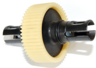
Das serienmäßige Kugeldiff funktioniert grundsätzlich gut, verlangt aber nach viel Aufmerksamkeit. Hier hätten wir uns ein weniger kompliziertes Kegeldiff gewünscht
