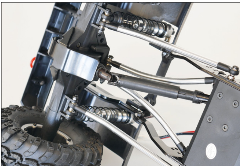
Kunststoff-Teleskopwellen übertragen die Kraft vom Verteilergetriebe zu den Achsen. Die Kardangelenke sind aus Stahl gefertigt
