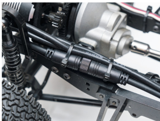
Leider ist die Steckverbindung des Sensorkabels im Vergleich zu herkömmlichen Leitungen relativ klobig
