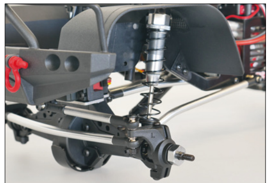
Ein Blick auf die Vorderachse. Insgesamt kommen vier Aluminium-Öldruckstoßdämpfer zum Einsatz
