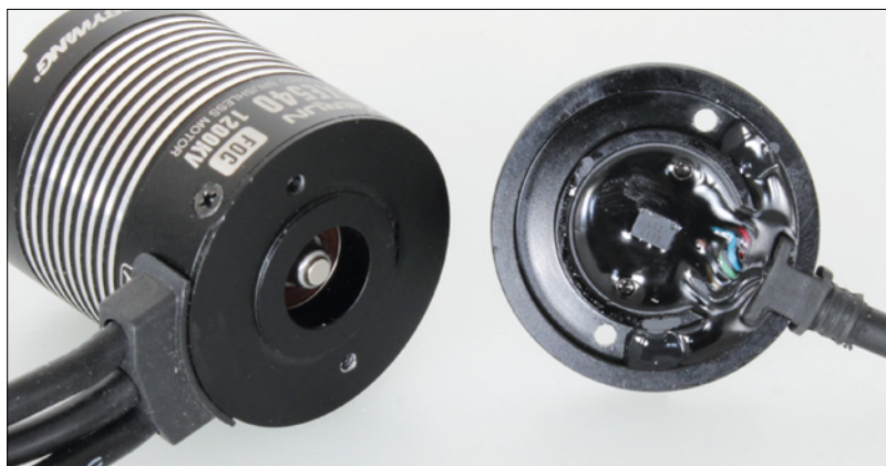
Auf der Rückseite des Motors befindet sich der Sensor. Schön zu sehen: Alles ist wasserdicht vergossen
