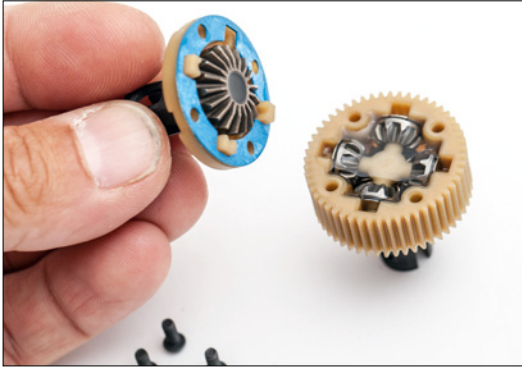
Das Diffgehäuse wird montiert. Die Bohrungen müssen übereinander stehen
