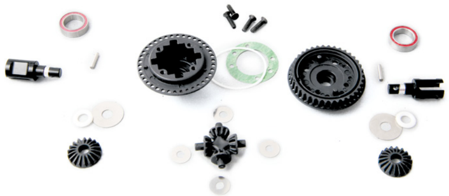
Die Teile des Kegelraddifferenzials. Gefüllt wurde es mit 500.000er-Öl, die O-Ringe sind mit Greenslime eingeschmiert worden
