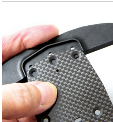
So passt der untere Teil des Frontrammers nicht an die Chassisplatte
