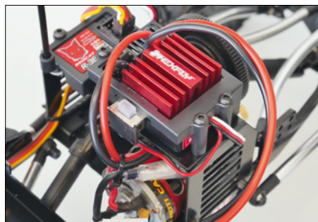
Der Hexfly-Regler kommt aus dem Hause Hobbywing und verfügt über eine dreistufig einstellbare Drag-Brake
