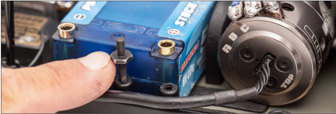
Mit diesem Bolzen wird die Höhe so eingestellt, dass die Akkuhalterung den Akku genau fixiert und nichts wackeln kann
