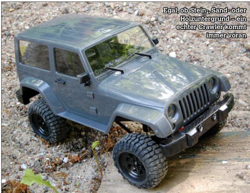
Die Stoßdämpfer tragen ihren Namen zu Unrecht. Hier wird nicht gedämpft, sondern nur gefedert
