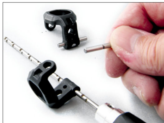
Ein C-Hub ist schon bearbeitet mit montiertem Achsstift, der andere ist auch gleich fertig
