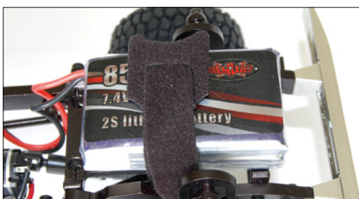
Mit seinen 850 Milliamperestunden Kapazität sorgt der beiliegende 2s-LiPo für gute Fahrtzeiten. Weniger erfreulich ist die Tatsache, dass er nicht über einen Balanceranschluss verfügt, was früher oder später zu unterschiedlich geladenen Zellen führt
