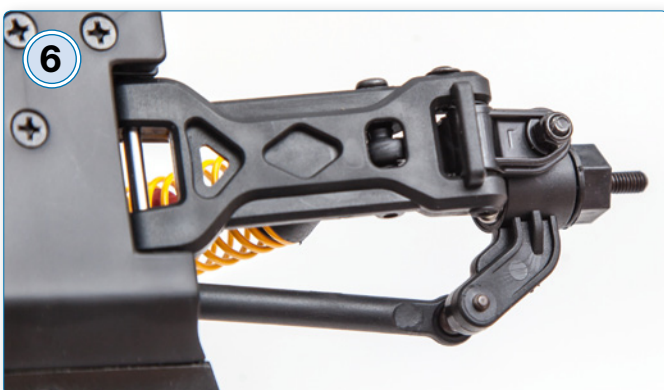
Sämtliche Fahrwerksteile sind aus schlagzähem Kunststoff gefertigt. Das ist leicht und bricht nicht so schnell
