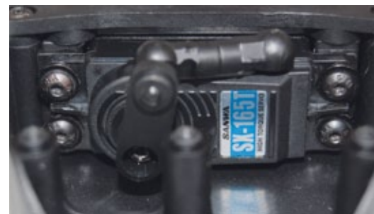
Durch den Einbau des Sanwa SX-165T-Lenkservos wird einer der wenigen Schwachpunkte des Blitz ausgemerzt
