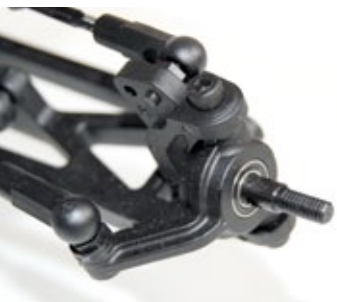
Die Lenkung basiert auf der bekannten C-Hub-Konstruktion
