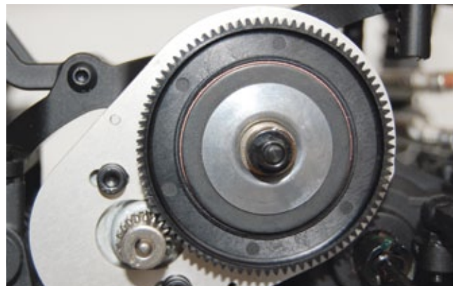
Belastungsspitzen werden durch einen einstellbaren Slipper kompensiert
