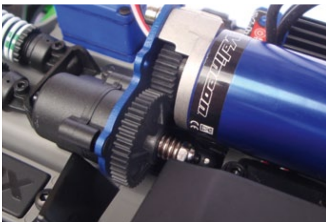
Der einstellbare Slipper schützt Getriebe und Antrieb gleichermaßen. Die Abdeckung beider Zahnräder wurde hier zu Anschauungszwecken entfernt
