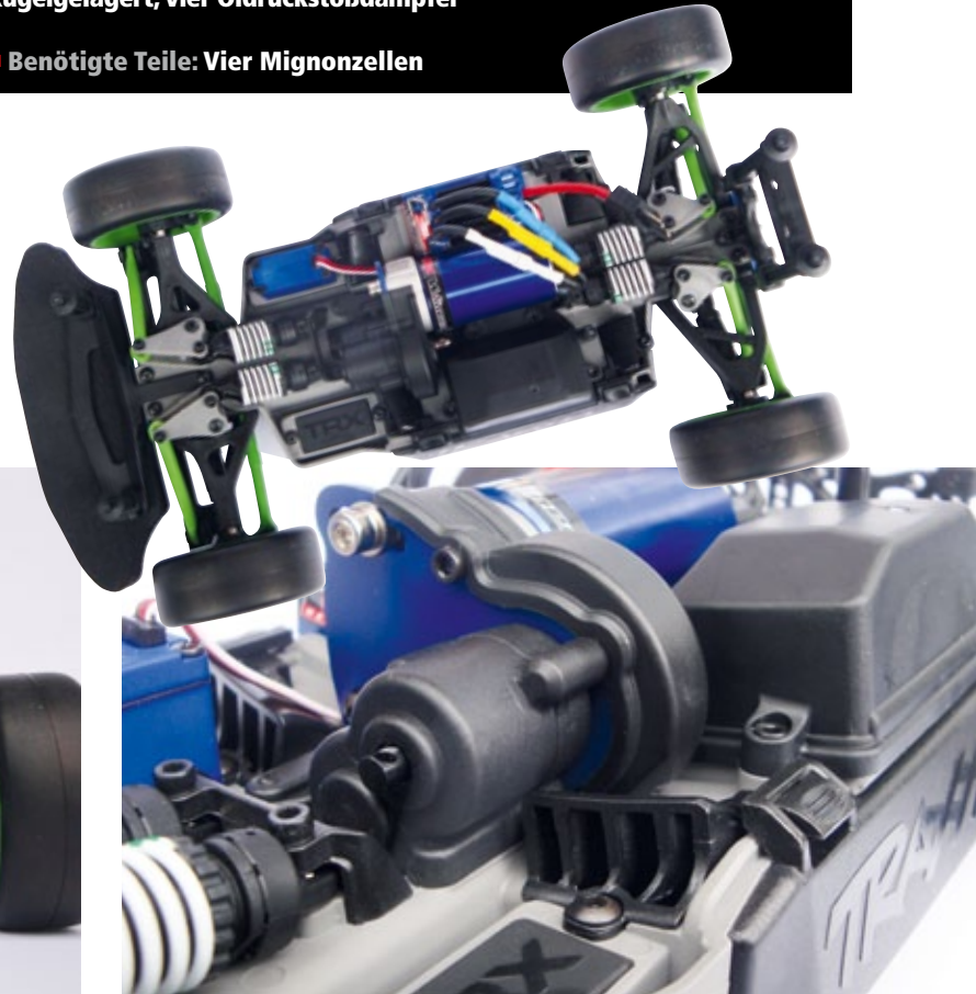
Kleine Lufthutzen über den Akkuschächten erlauben es, dass der Fahrtwind die Akkus kühlen kann
