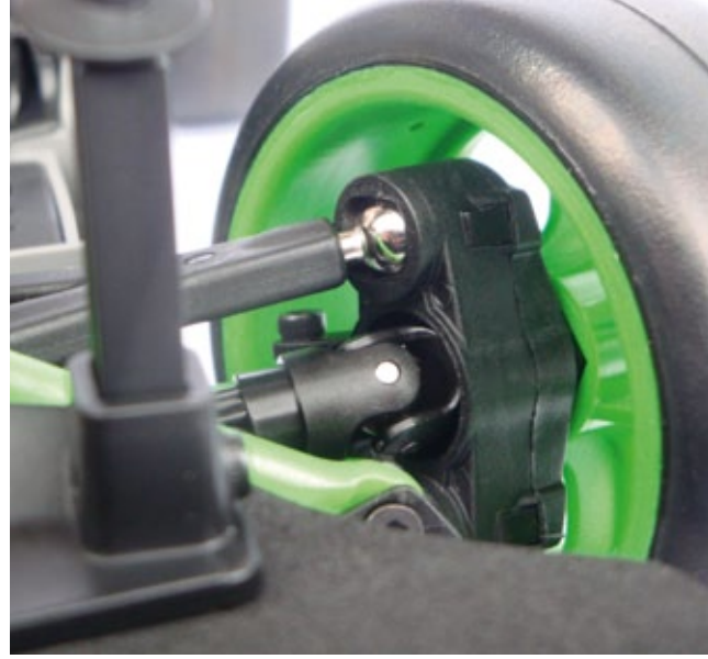
An beiden Achsen finden sich Pivotball-Aufhängungen und Kardantriebswellen aus Kunststoff
