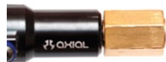
Die Spurverbreiterungen sind aus Messing und sorgen für einen besseren Kurvenhalt
