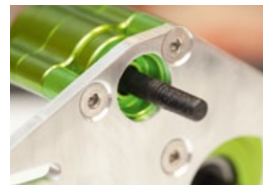
Die aus edlem Aluminium gefräste FoFF-Motorplatte von Billet Design Works ist Pflicht, wenn das Getriebe halten soll. Hier verbiegt sich nichts
