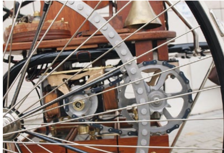
Der Elektromotor treibt über ein Vorgelege-Kettengetriebe eine festgelegte Rollenkette an
