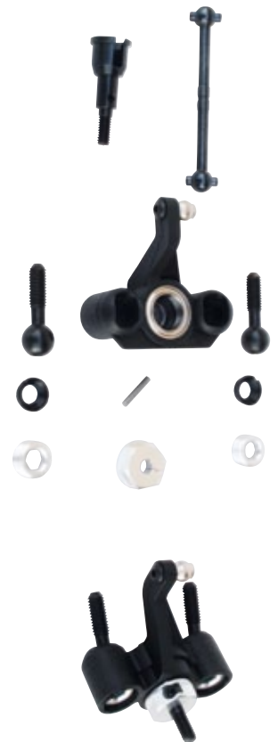
Die Lenkhebel werden in bewährter Pivotball-Bauweise montiert. Radmitnehmer aus Alu sind Programm, CVD-Antriebswellen sucht man hingegen vergebens
