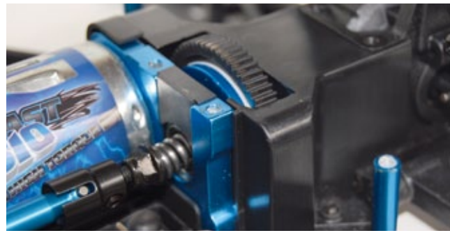
Im Gegensatz zu anderen Angehörigen der Blast-Familie wird das Hauptzahnrad des SC von Sand und Steinchen abgeschirmt
