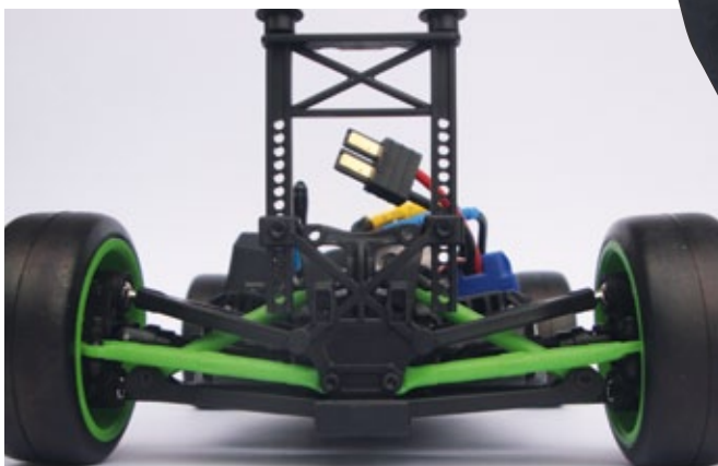
Leider lassen die festen Spurstangen keinerlei Einstellungen von Vor- oder Nachspur an beiden Achsen zu. Lediglich der Sturz lässt sich über die Pivotball-Aufhängung beeinflussen
