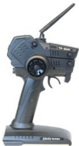
Erfreulich ist die 2,4-Gigahertz-Modulation des neuen HPI-Coltsenders. Ein griffiger Moosgummi-aufsatz für das Lenkrad fehlt leider
