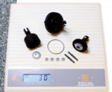
Das hintere Differenzial mit Feinverzahnung bringt gerade einmal 30 Gramm auf die Waage, allerdings entpuppte es sich auch als Schwachstelle des V-One R4
