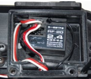
Der kleine RF-20-Empfänger sitzt in einer gummigedichteten Empfängerbox
