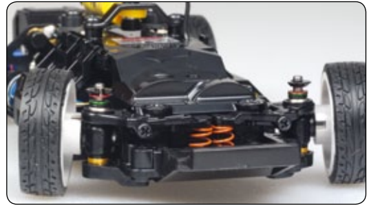
Natürlich verfügt das Chassis über die innovative Vorderachskonstruktion des MR-03 mit den über eine Querlenkerwippe angelenkten Federn
