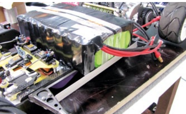
Die schweren Akkus müssen in jeden Fall mit Seitenleisten gestützt und mit Klett- oder Klebeband vor der Fahrt fixiert werden
