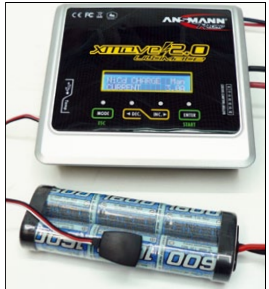
Solche Aufbauten sieht man immer seltener, denn die Erkennung des vollen Akkus mittels Temperaturfühler ist nur bei akribischer Handhabung recht genau
