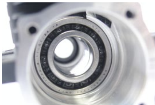
Spezielle Keramik-kugellager sind in den O.S. Speed-Motoren Standard
