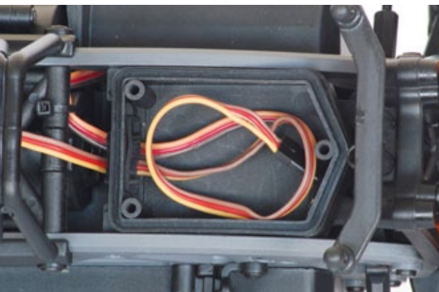
Beide Modelle bieten eine durch Gummidichtungen komplett vor Wasser geschützte RC-Box
