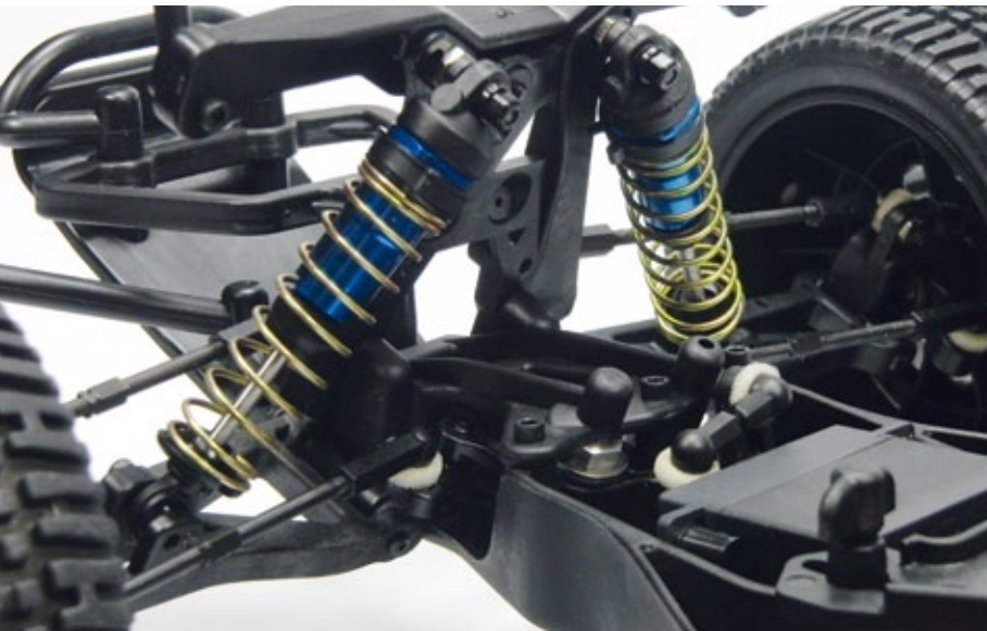
Die blau eloxierten Dämpfer lassen sich mittels Vorspannklipsen einstellen. Rechts-links-Gewindestangen erlauben die Verstellung von Sturz und Spur
