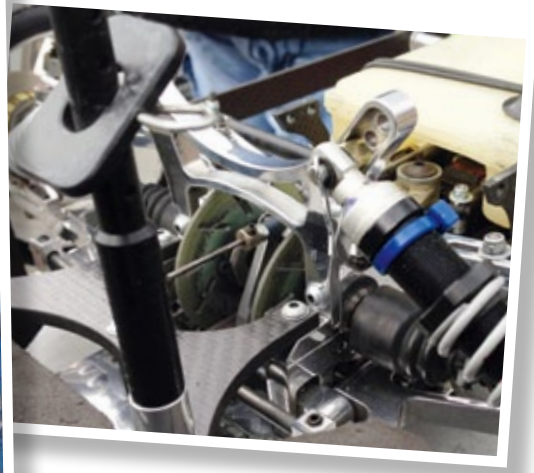
Der Xandi-X1-Tourenwagen zeigte technische Innovationen – die innenliegenden Bremsscheiben in der Mitte der Radachse sorgt für einen zentraleren Schwerpunkt und schützen die Bremsscheiben
