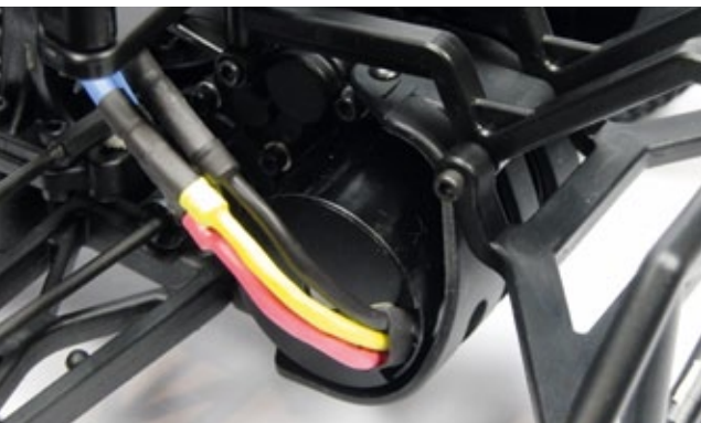
Einen bürstenlosen Motor findet man im Heck des SC10 RS. Er leistet 3.300 Umdrehungen pro Minute und Volt. In Verbindung mit einem 3s-LiPo wird das Modell zu einer wahren Rakete
