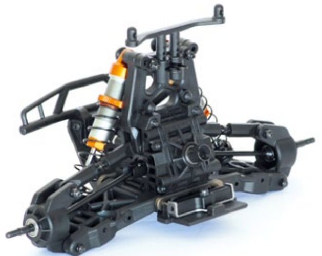
Die Achsten sind in Savage-typischer Manier aufgebaut und fast unkaputtbar. Die günstigere RTR-Version hat keine Rechts-links-Gewindestangen zur Einstellung des Sturzes, die SS-Variante (hier im Bild) schon
