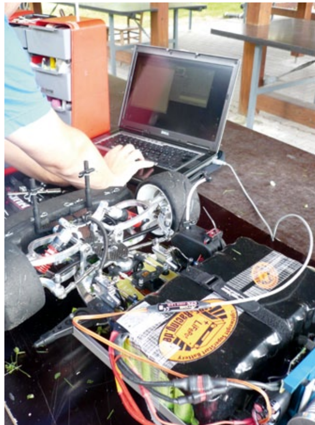
Das Regulieren der Reglersoftware und damit der Motorleistung eines Elektromodells erfolgt per USB-Schnittstelle am PC
