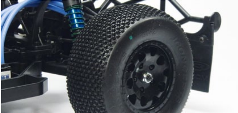
Die Felgen vom SC10 4x4 kommen auch beim Race Spec zum Einsatz. Anders als beim originalen SG10 findet man hier Mitnehmer mit 12-Millimeter-Sechskanten an allen vier Ecken
