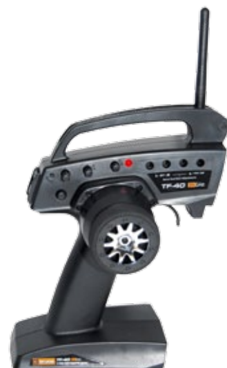
HPIs TF-40-Coltanlage arbeitet mit 2,4 Gigahertz und bietet auch sonst all das, was man von einer modernen Einsteiger-Funke erwarten darf. Sie liegt dem RTR-Savage bei
