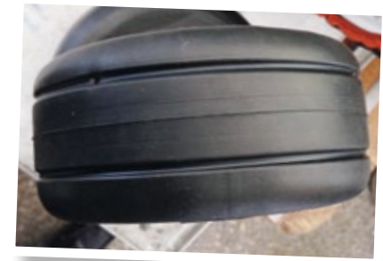
Neue Reifen konnten im Fahrerlager gesichtet werden – der GRP F1-Pneu ist kein reiner Slick mehr und kommt mit zwei beziehungsweise drei Rillen auf Vorder- und Hinterachse. Letztere ist im Vergleich zum Slickreifen 6 Millimeter breiter geworden
