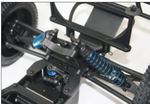
Sturzsstreben und Lenkstangen sind nicht verstellbar
