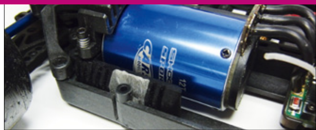
Der Motorhalter aus Aluminium wurde an entsprechender Stelle ausgespart. Er verleiht zusätzliche Stabilität in diesem Bereich
