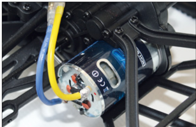
Beim Antriebsaggregat handelt es sich um einen grundsoliden Bürstenmotor
