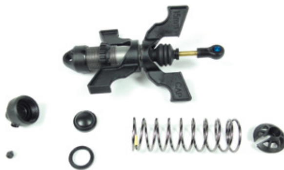
Spezielles Werkzeug liegt dem Kit bei, damit man die großen Bigbore-Stoßdämpfer einfacher zusammenbauen kann. Außerdem hat man die Wahl zwischen Emulsionsdämpfern (mit dem O-Ring abgedichtet), oder einer Membrandichtung, womit ein Volumenausgleich geschaffen wird
