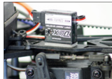
Die D-Box stabilisiert das Modell elektronisch durch einen Kreisel. Wenn die Wirkrichtung nicht stimmt, muss man sie auf dem Kopf montieren
