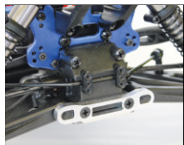
An der Hinterachse ist sogar ein Stabilisator verbaut
