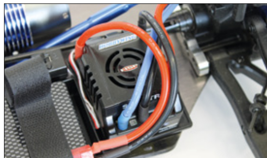
Ein Hobbywing-Regler mit 80 Ampere Belastbarkeit regelt die Leistung des Sea Rover zuverlässig
