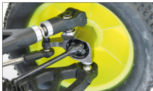
Kardanhalbwellen und Alu-Lenkhebel sind nicht selbstverständlich in dieser Preisklasse
