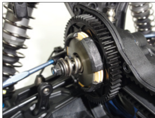
Der neue VTS-Slipper hat jetzt eine Reibscheibe mehr. Er lässt sich so um einiges feiner justieren
