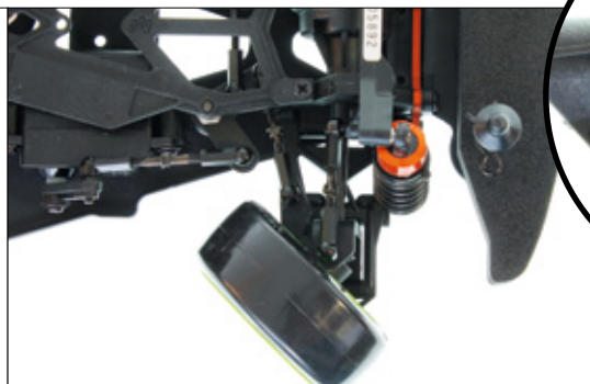
Um den Lenkausschlag zu vergrößern, muss man die Lenkhebel bearbeiten
