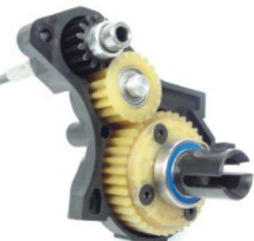
Die Getriebe an Vorder- und Hinterachse sollten besondere Beachtung finden. Hier ist es wichtig, die einzelnen Zahnräder richtig herum zu installieren
