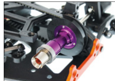
Das Vorderachsdifferenzial wird durch einen Freilauf ersetzt. Er ermöglicht eine Handbremsfunktion
