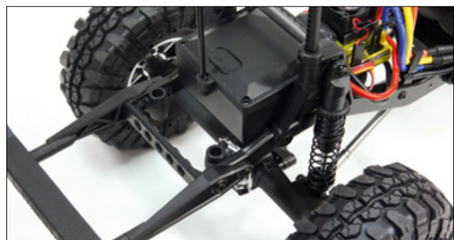
Hinter der Empfängerbox findet sich ein weiteres paar Karosseriehalteraufnahmen. So können auch Karosserien im Pickup-Style auf dem Ascender ihr Zuhause finden
