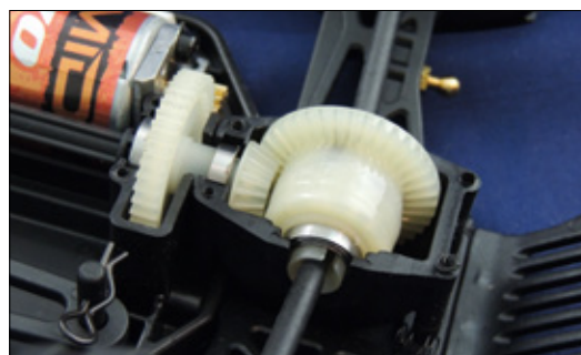
In den Achsen arbeiten solide Kegelrad-Differenziale. Kugellager minimieren die Reibung
