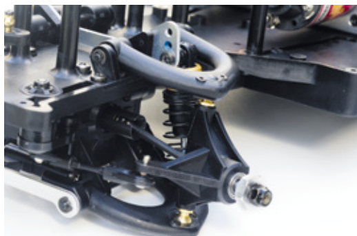
Aufwändig gestaltete Vorderachsaufhängung mit viel Ähnlichkeit zu den großen Vorbildern
