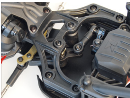
Das Servo des Typs KS203 ist mit einem Servosaver versehen, die Lenkmechanik zieht sich angenehm spielfrei
