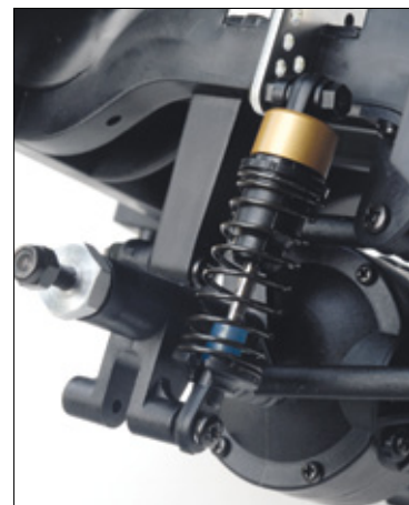
Die hier eingesetzten Stoßdämpfer wurden mit längeren Kolbenstangen versehen und ein Stück Benzinschlauch auf der Kolbenstange sorgte für den weichen Endanschlag
