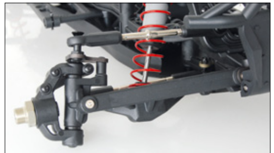
Für ein Modell in 1:7 sind die Doppelquerlenker und die Öldruckstoßdämpfer ordentlich dimensioniert
