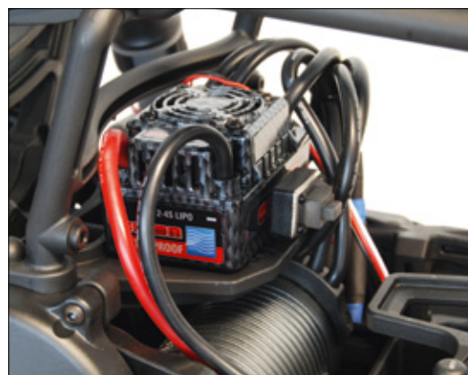
Direkt vor der Hinterachse sitzt der Regler. Er ist mit 130 Ampere belastbar und bereits mit dem Motor verbunden
