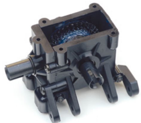
Das Vorderraddifferenzial fand eine Aufnahme in einem separaten Getriebekasten
