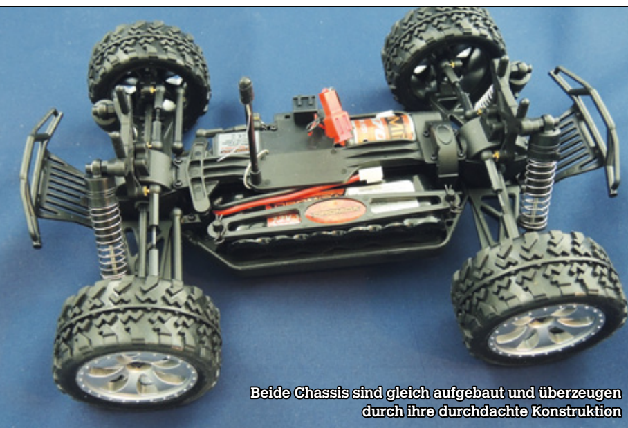
In den Achsen arbeiten solide Kegelrad-Differenziale. Kugellager minimieren die Reibung
