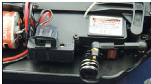
In der wasserabweisenden RC-Box sitzen Regler und Empfänger. Das Servo ist mit einem Servosaver ausgestattet
