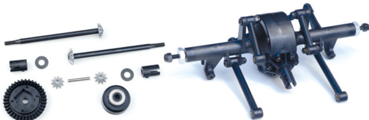
Einzelteile des hinteren Differenzials mit den langen Achsen, die ihre Führung im Gehäuse der hinteren Starrachse fanden
