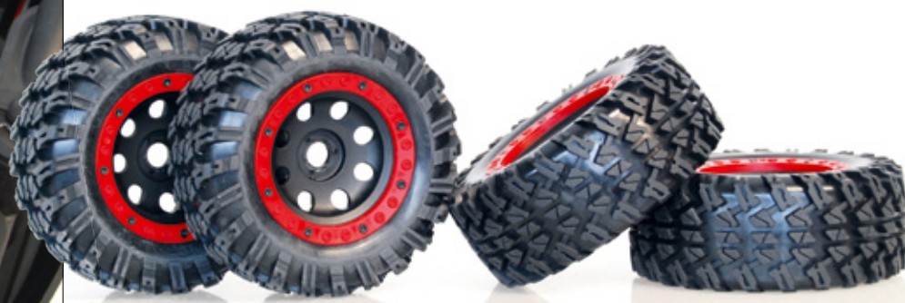
Die stark profilierten Pneus sind mittels Beadlock-Ringen auf schwarzen Kunststoffelgen befestigt
