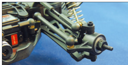
Der Sturz der Achsen lässt sich über Gewindestangen einstellen, die Spur jedoch nicht
