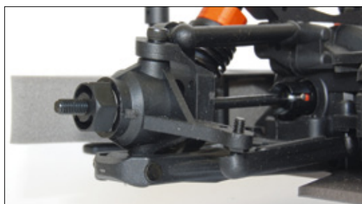
Viel einzustellen gibt es nicht an Fahrwerk, Aufhängung und C-Hub-Lenkung
