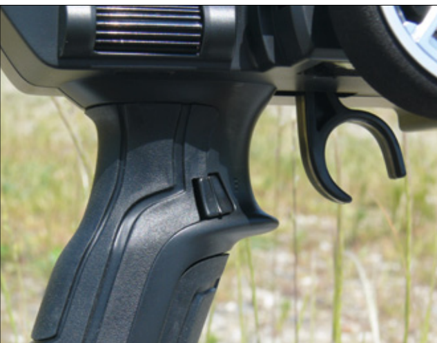
Der fünfte Schalter ist sehr gut mit dem Daumen zu erreichen
