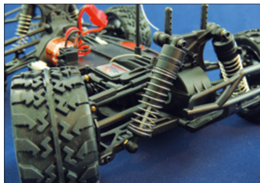
Die Feder-Vorspannung an den Öldruckstoßdämpfern wird über C-Klipse eingestellt
