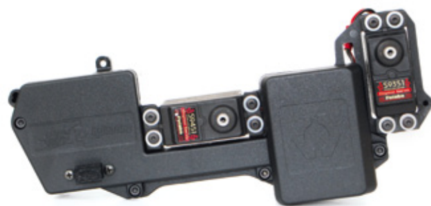
Die neue RC-Box ist nicht nur praktisch und einfach zu demontieren, sie bietet auch viel mehr Platz. Vor allem für den Einbau eines LiPo-Akkus
