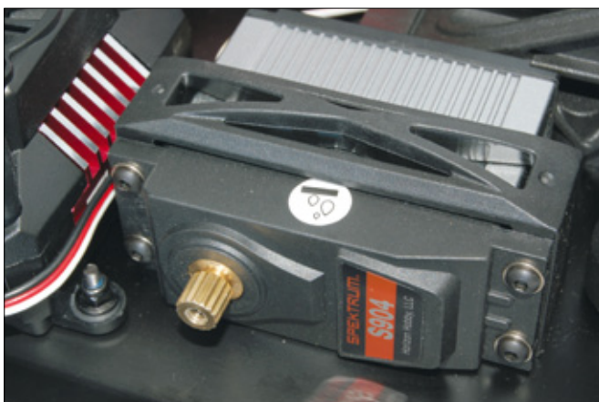
Spektrums S904-Lenkservo bietet ausreichend Kraft und ist darüber hinaus gegen Spritzwasser geschützt. Per Metallgetriebe wird die nötige Widerstandskraft geschaffen
