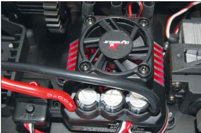
Durch drei Kondensatoren wird stets eine stabile Spannungslage sichergestellt
