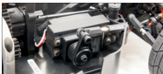
Das HPI SF10W-Lenkservo ist locker in der Lage, die kleinen Räder in jeder Situation in die richtige Richtung zu dirigieren. Zudem ist es wasserdicht
