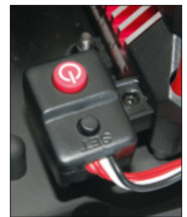
Abrufen und Anpassen der insgesamt sechs Einstelloptionen des Reglers wird über den Setup-Knopf im Ein-aus-Schalter vollzogen. Zur Kontrolle gilt es, LED-Blinkfolgen zu zählen
