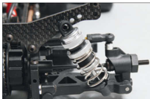
Vier verschiedene Bohrungen stehen in der hinteren Dämpferbrücke zur Montage der Dämpfer zur Verfügung
