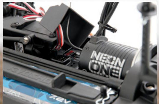
Der Empfänger wird mit einer Gummikappe gegen Spritzwasser und Staub geschützt
