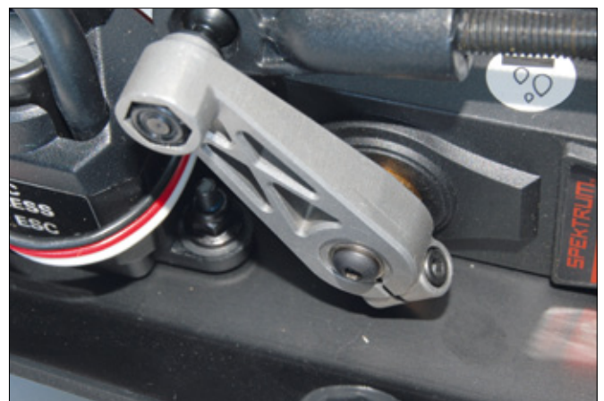
Beim Servohorn ging man herstellereitig auf Nummer sicher und fixierte es zusätzlich zur zentralen Befestigungsschraube noch mit einer Spannschraube
