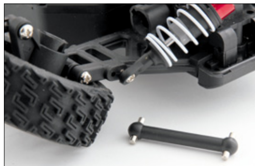
Kunststoff-Knochen mit Querstiften aus Metall übertragen die Kraft zu den Rädern
