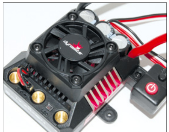
Die Kopfarbeit der Fuze-Kombo übernimmt der aktiv gekühlte 160-Ampere-Regler
