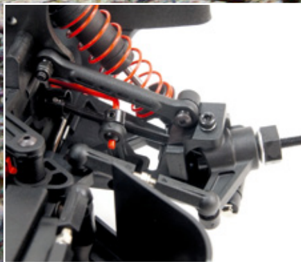
Beim Fahrwerk setzt HPI auf einstellbare Spurstangen. Der Sturz ist allerdings nicht variabel
