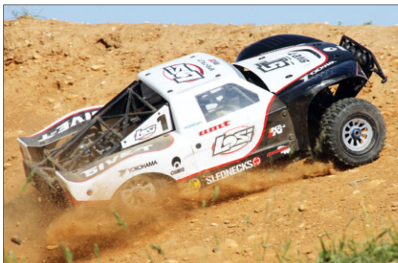
Beim 4WD-Offroader sorgen alle vier Räder für Vortrieb. Gut daran zu erkennen, dass die Räder sowohl an der Vorder- als auch an der Hinterachse Dreck aufwirbeln
