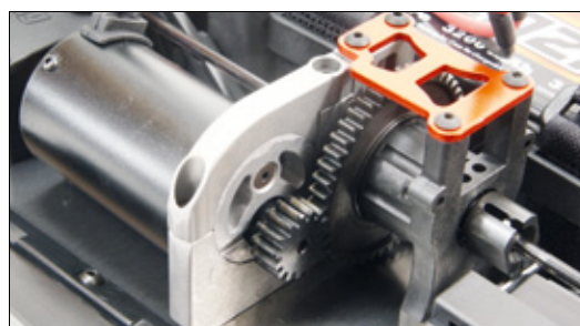
Der Vektor Brushlessmotor mit 4.000 Umdrehungen pro Minute und Volt wird in einem exzentrischen Motorhalter fixiert. Das Ritzespiel lässt sich so spielend leicht perfekt einstellen
