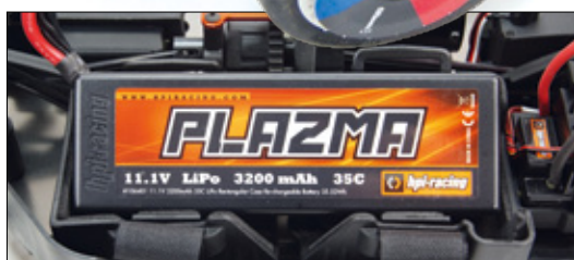
Der perfekte Energieriegel von HPI kommt aus der Plasma Serie und stellt mit seinen drei Zellen 11,1 Volt Nennspannung zur Verfügung
