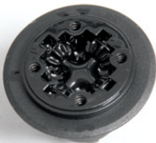
Das geöffnete Differenzial. Die Viskosität des Öls ist leider nicht bekannt
