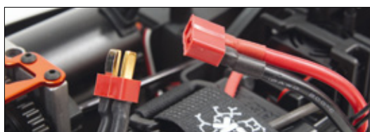
Hochstromstecker in Form von T-Kontakten sichern den hohen Stromfluss bei 3s-Betrieb
