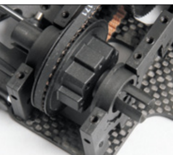
Das Differenzial verfügt genau wie die Starrachse vorne über haltbare Stahlausgänge
