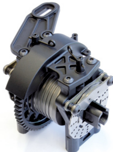
Das Mitteldiff fertig zur Montage auf dem Chassis. Das Differenzialgehäuse ist aus Alu, was mehr Stabilität und eine bessere Wärmeabfuhr ermöglicht
