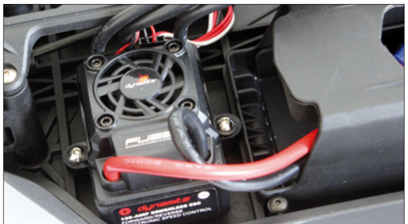
Der Fuze-Regler verkraftet einen Dauerstrom von 130 Ampere und kann in Kombination mit dem verbauten Motor an 3s betrieben werden
