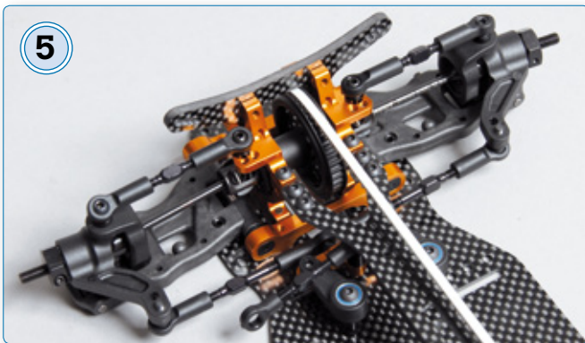
Die vollständig montierte Vorderachse. Über die Gewindeschrauben am oberen Querlenker kann der Radsturz variiert werden. Die Madenschraube im unteren Querlenker dient der Verstellung des Ausfederwegs
