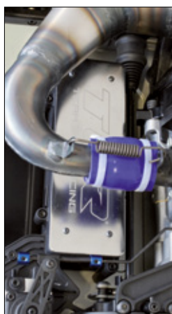
Der Auspuff läuft direkt über den Deckel der Akku-Box, was das Abnehmen des Deckels etwas fummelig gestaltet
