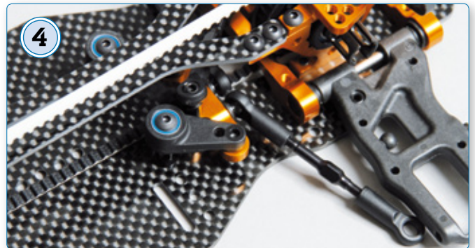
Die Lenkhebel des T4'17 sind identisch mit ihren Vorgängern. Die Kunststoffarme arbeiten leicht genug und schützen bei Crashes das Servo. Die Aluminium-Tuning-Lenkung ist nicht nötig, sieht aber gut aus
