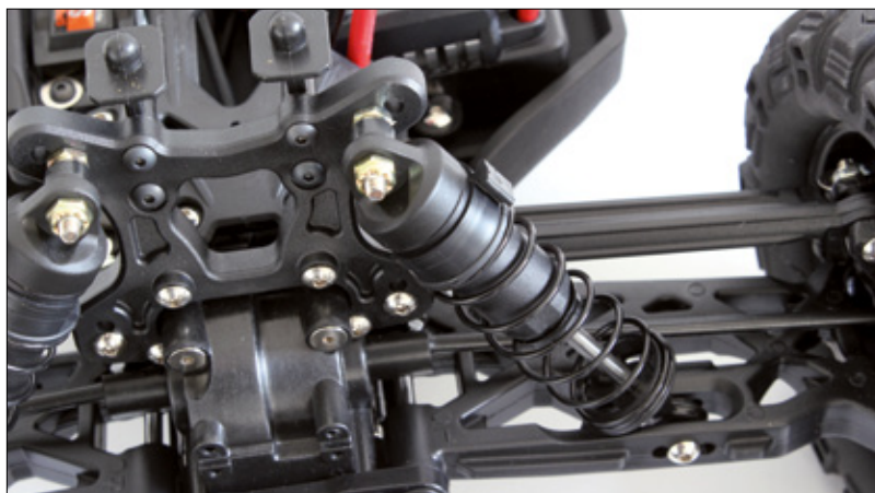
Die Federvorspannung der Stoßdämpfer lässt sich über C-Klipse einstellen. Rändelschrauben wären hier wünschenswert gewesen
