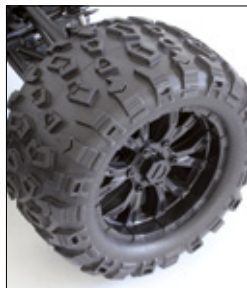
Dicke, grobstollige Reifen – verklebt auf Multispeichenfelgen: für einen Monstertruck ist das Pflicht
