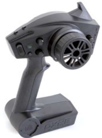
Die DX2E, ein einfacher Pistolensender, bietet alle erforderlichen Einstelloptionen. Ganz rechts: der Drehgeber für das Stabilisierungssystem AVC
