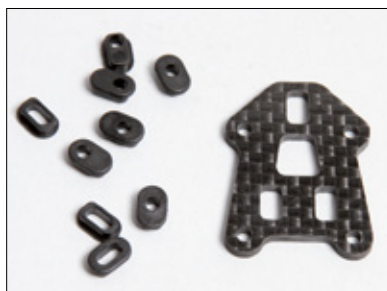
Mithilfe der Einsätze kann an dieser Platte der Radnachlauf verstellt werden
