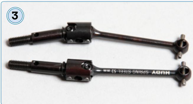
Die Doppelgelenkkardane werden an der Vorderachse eingesetzt. Sie sind sehr stabil und reduzieren im Vergleich zu normalen Kardans deutlich die Vibration
