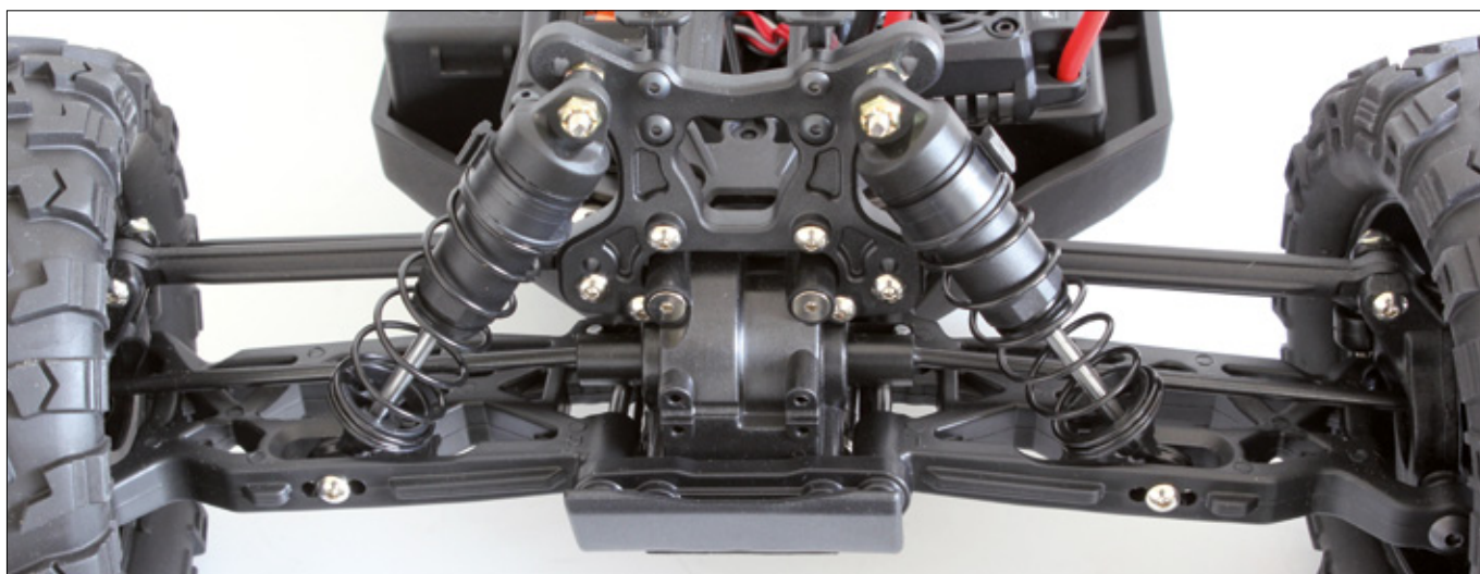
Die Achsen bieten aufgrund ihrer Bauweise kaum Einstellmöglichkeiten. Dafür sind die Einzelteile so konzipiert, dass sie auch größten Belastungen gewachsen sind
