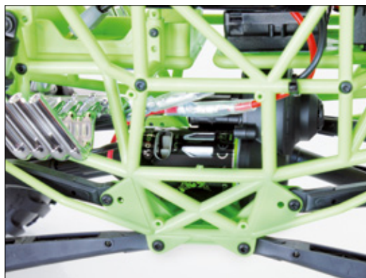
Zentral unter dem Chassis sitzt der 27-Turns-Bürstenmotor samt Getriebeeinheit
