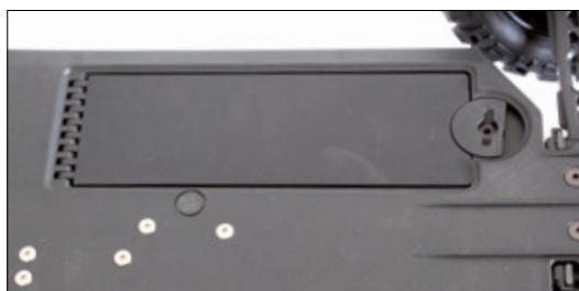
Akkus werden über eine Klappe auf der Chassisunterseite eingeschoben
