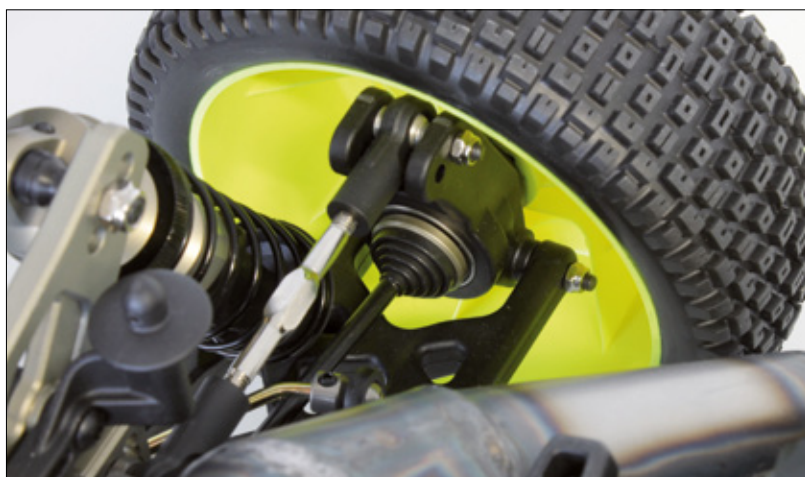
Ein sinnvolles Feature sind die Gummimanschetten an allen CVD-Gelenken. Die werden von den eloxierten Alu-Ringen sicher fixiert
