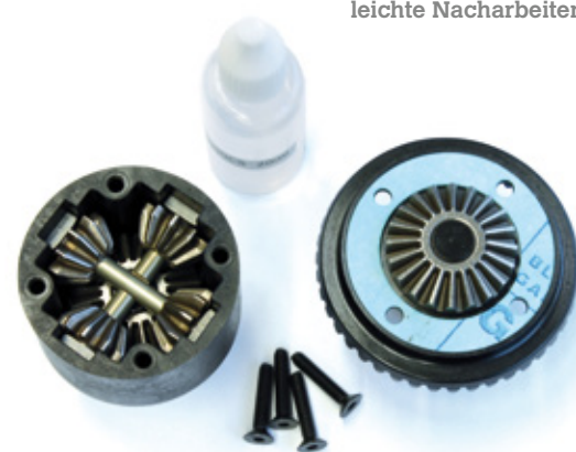
Die Differenziale entsprechen in ihrer Bauweise dem Standard der 1:8er-Klasse – nur eben zwei Nummern größer
