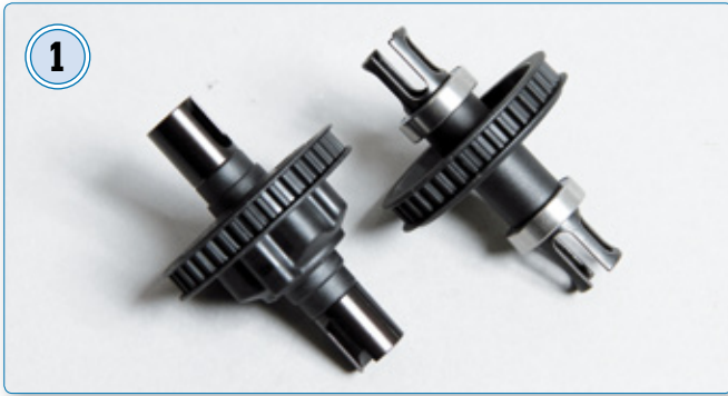
Das Kegeldifferenzial der Hinterachse (links) und die starre Vorderachse
