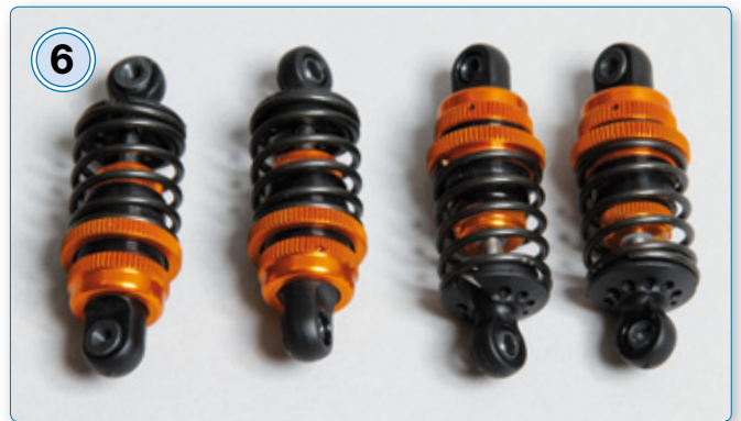
Die kurzen Big Bore-Stoßdämpfer. Sie lassen sich leicht luftfrei befüllen. Mit dem optionalen PSS (Progressive Shock System) bietet XRAY für die Stoßdämpfer eines der interessantesten Tuningteile für Tourenwagen auf dem Markt an
