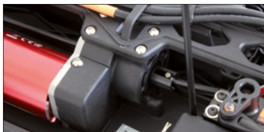
Motor, Ritzel und Mitteldiff sind vor eindringendem Schmutz gut geschützt
