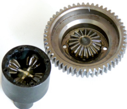
Ein Blick in das Innere des Differenzials: Dieses kann man mit unterschiedlich viskosem Öl abstimmen, um die Sperrwirkung zu beeinflussen
