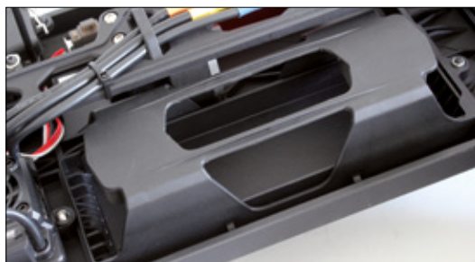
Der Akkuschacht ist groß dimensioniert. Hier finden verschiedene 2s- und 3s-LiPos problemlos Platz
