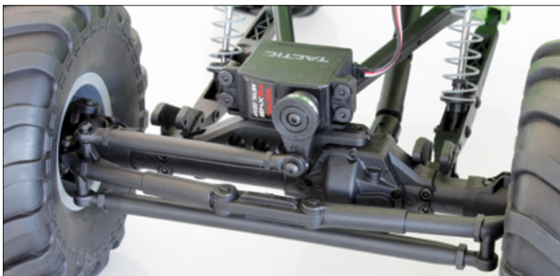
Das Servo ist den Herausforderungen im Offroad-Einsatz gewachsen und ist inklusive Servosaver ab Werk verbaut
