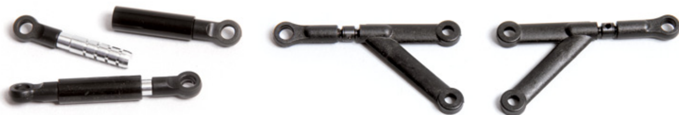
Die beiden Sidetubes. In die Rillen wird Silikonöl gefüllt
