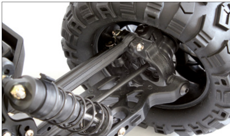
Den Kraftschluss zu den Rädern stellen Antriebsachsen in CVD-Bauweise her
