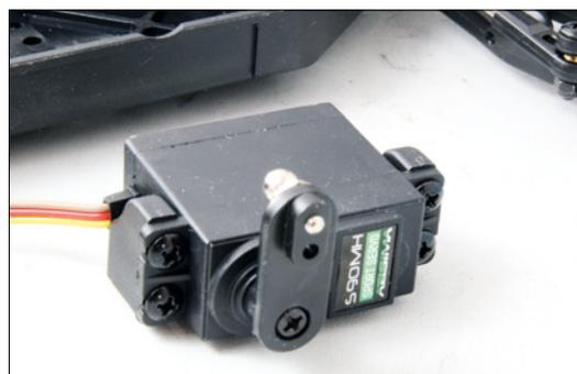
Das Servo mit dem passenden Horn vor der Montage
