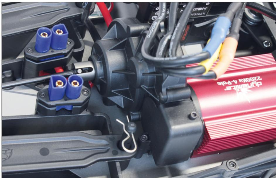
Der Motor überträgt seine Power über ein Zwischenzahnrad auf das Mitteldiff
