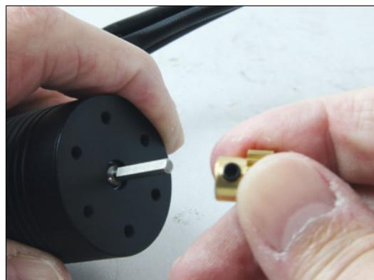
Montiert man das Ritzel, muss man drauf achten, dass die Madenschraube auf den flachen Teil der Motorwelle trifft. So löst sich später nichts
