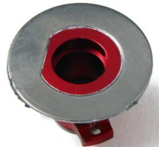
Diese Diffscheibe war eine Stunde im Einsatz. Mit Gear Lube und Keramikugeln ist kein Verschleiß erkennbar
