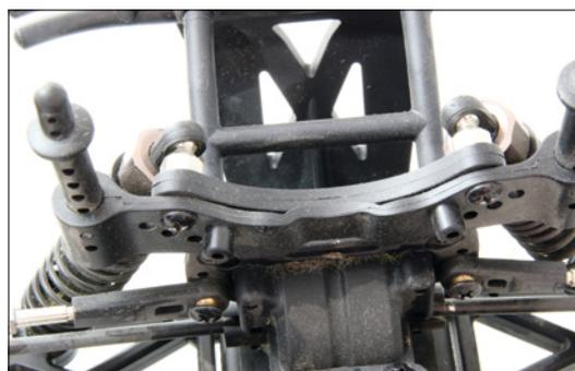
Der Karosseriehalter biegt sich bei korrektem Zusammenbau leicht – technisch hat das jedoch keine Auswirkungen
