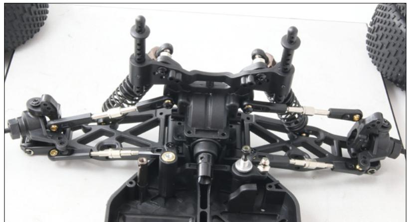
Die Vorderachse ist komplett, nur die Spurstangen und oberen Querlenker müssen noch verschraubt werden
