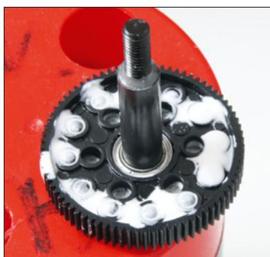
Kleine Überholung des Kugeldifferenzials mit Gear Lube. Zugegeben, es sieht eklig aus, aber läuft absolut genial und hält den Dreck auf Distanz
