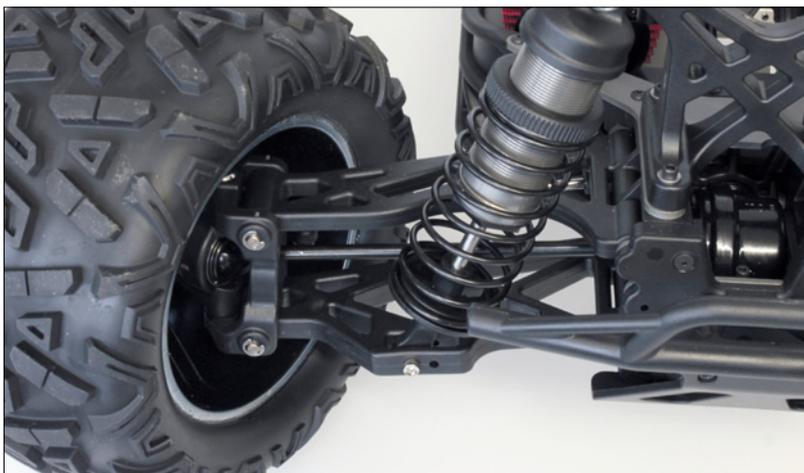
Die soliden Doppelquerlenkerachsen sind bereits von älteren Losi LST-Modellen bekannt
