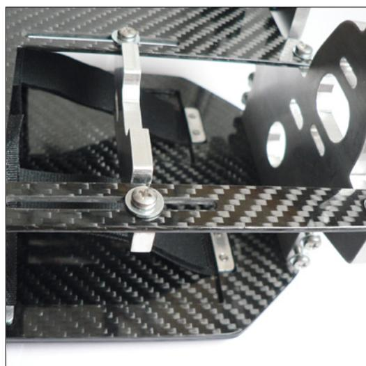
Um das Aufbrechen des Motorgehäuses zu verhindern, verfügt der Halter über einen hinteren Teil, der den Motor zusätzlich sichert. Da sowohl der nutzbare Motordurchmesser als auch die Untersetzung veränderbar sind, muss der Halter vielfältig einstellbar sein
