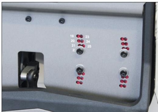
Das Ritzelspiel wird über verschiedene Befestigungsbohrungen des Motorhalters eingestellt
