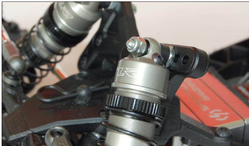
Neben unterschiedlichen Silikonölen lassen sich die Stoßdämpfer auch mechanisch justieren wie durch die Rändelschrauben zur Anpassung der Fahrwerksfeder-Vorspannung oder variable Befestigungspunkte an der Dämpferbrücke. Die Entlüftungsschraube in der Dämpferkappe ist notwendig, da bei den Stoßdämpfern des 22 4.0 auf eine Membran in der Kappe verzichtet wurde
