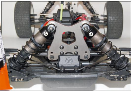
Im Gegensatz zu seinem Wüsten-Bruder stehen die vorderen Stoßdämpfer des BX8SL deutlich steiler
