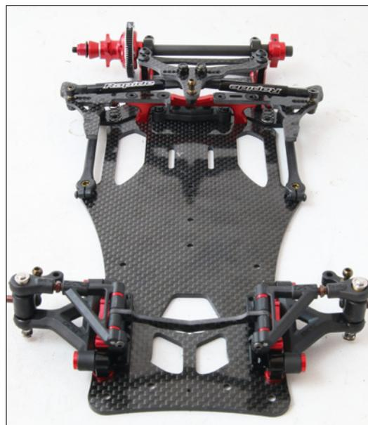
Der Roche ist fertig bis auf die Montage des Servohalters und des Dämpfers
