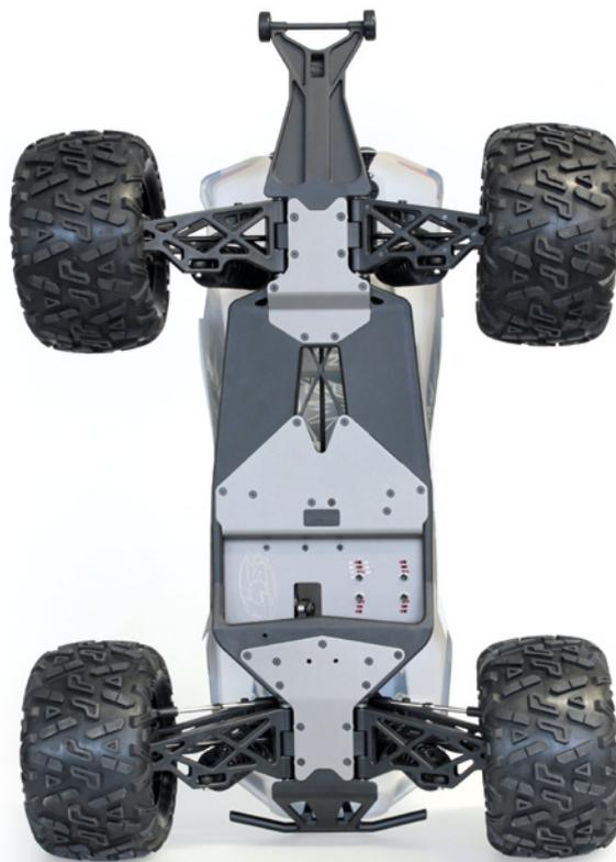
Zentraler Bestandteil des neuen LST-Elektrochassis ist eine große Kunststoffwanne mit Aluminiumplatten an stark belasteten Stellen
