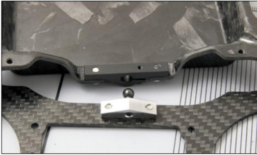
Sehr schön gelöst: An der Wanne befindet sich eine zylindrische Aufnahme, am Pod ein Kugelkopf. Die Links und der Dämpfer führen das Heck
