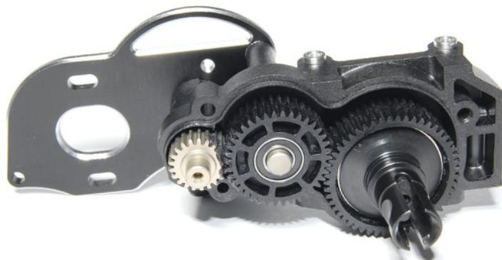
Um die unterschiedlichen Drehzahlen der Hinterräder in Kurven auszugleichen, ist ein Kugeldifferenzial Teil des dreistufigen Getriebes. Diese Bauweise ist zwar stufenlos und präzise einstellbar, dafür aber auch deutlich fehleranfälliger als ein robusteres Kegeldiff. Letzteres hätten wir daher eindeutig bevorzugt
