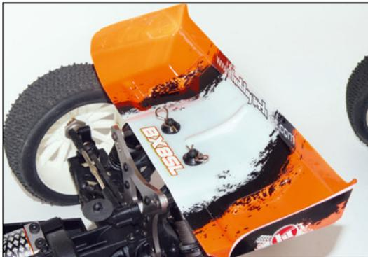
Der Lexan-Heckspoiler des BX8SL sorgt für eine Verbesserung des aerodynamischen Anpressdrucks auf die Hinterachse. Das Ziel: möglichst viel Traktion
