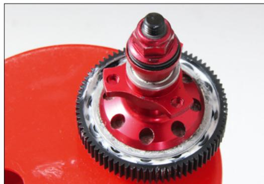
Das überholte Diff ist fertig und muss nur noch eingebaut und eingestellt werden
