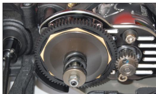
Ein exakt und stufenlos einstellbarer Slipper sorgt dafür, dass der Antriebsstrang keine übermäßigen Belastungsspitzen abbekommt. Die Einstellschraube ist selbst mit aufgesetzter Karosserie problemlos erreichbar. Die hier abgebildete Trägerplatte aus Aluminium platziert Getriebe und Motor flach hintereinander. Eine zweite Platte mit hochgesetztem Getriebe und nach hinten gerücktem Motor ist ebenfalls im Lieferumfang enthalten
