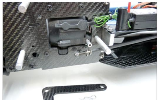
Direkt unterhalb des hochkant verbauten, hinteren Akkupacks befindet sich das Bremsgestänge mit Zugriff auf die doppelte Scheibenbremse, um den immerhin bis zu 6.500 Gramm schweren Truck sicher stoppen zu können
