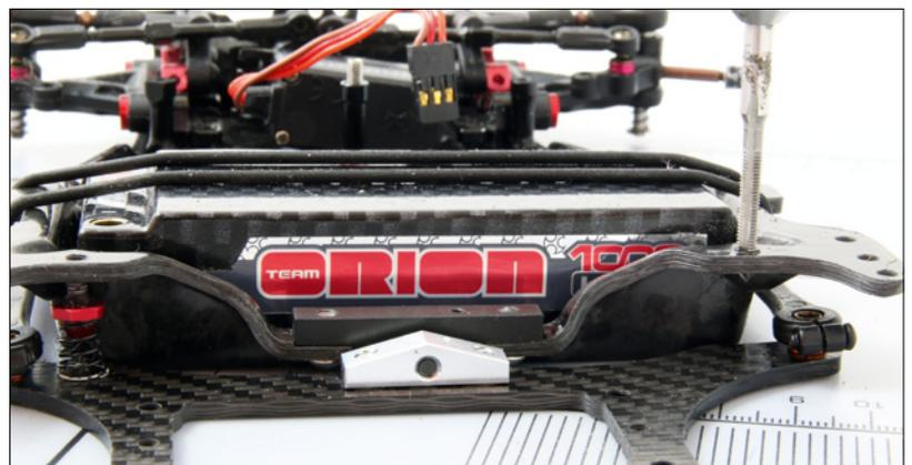
Die Podplatte steckt in ihrer Führung, die Links sind montiert, jetzt werden die Gewinde geschnitten für die Seitenfedern
