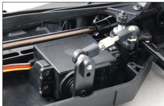
Das Servo ist montiert und mit der Lenkung verbunden
