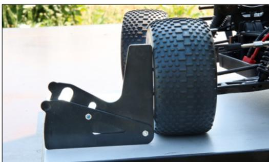
Mit diesem einfachen Werkzeug kann man die Sturzwerte kontrollieren und entsprechend korrigieren
