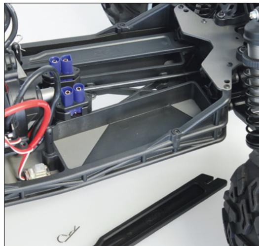
Die Akkus werden von einem Plastikriegel mit Karosseriesplint gehalten
