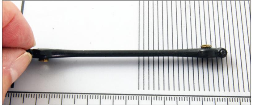
Die Pivotkugeln im Link müssen nach vorne hin umgedreht werden, da die Schraube von oben eingeschraubt wird
