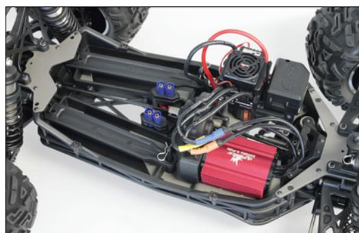
Das speziell auf Brushlessantrieb ausgelegte Chassis wirkt aufgeräumt und senkt den Schwerpunkt
