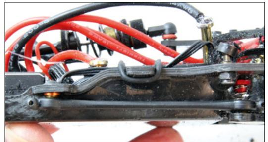
Hier sieht man die Ausrichtung der vorderen Pivotkugel. Zwischen Wanne und Pivotkugel muss eine 1-Millimeter-Scheibe verbaut werden
