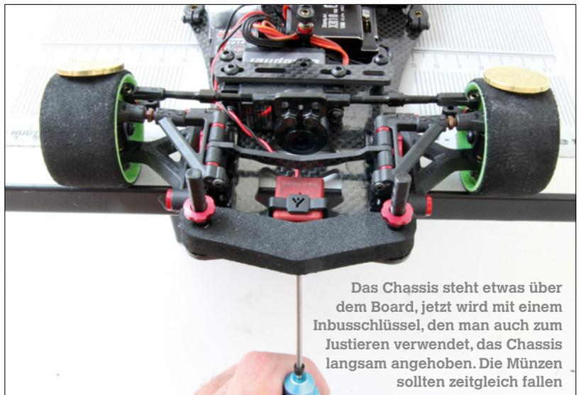
Das Chassis steht etwas über dem Board, jetzt wird mit einem Inbusschlüssel, den man auch zum Justieren verwendet, das Chassis langsam angehoben. Die Münzen sollten zeitgleich fallen
