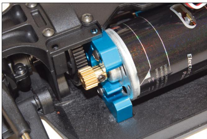
Entfernt man die zwei Schrauben der Schutzkappe, so gibt diese den Blick auf Motorritzel und Hauptzahnrad frei
