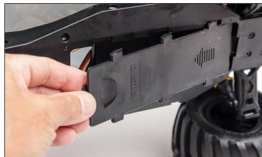
Durch einen Druck auf den Knopf wird das Akkufach auf der Unterseite des Modells entriegelt und kann geöffnet werden
