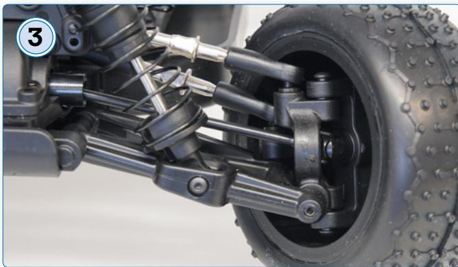
Die Kraftübertragung zu den Vorderrädern erfolgt über stabile Stahl-Kardanwellen
