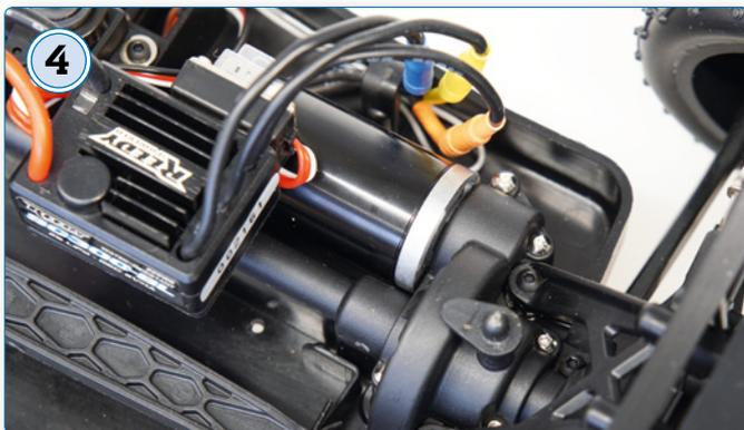
Der 4.500-kv-Brushlessmotor – längs im Chassis montiert – treibt die zentrale Alu-Welle an
