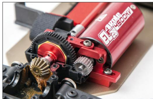
Gut zu sehen sind die verschiebbare Motorhalterung aus rot eloxiertem Aluminium und der Slipper mit dem montierten Kegelrad
