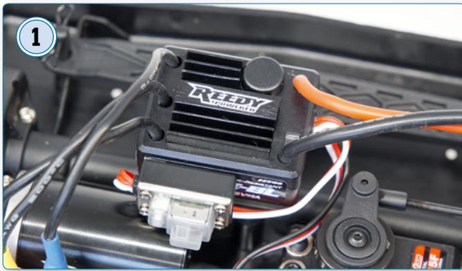
Der wassergeschützte Fahrregler sitzt mittig im Chassis und ist mit einem Deans-T-Stecker ausgestattet
