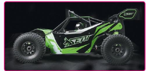
Servo liefert bestmögliche Lenkkontrolle. Alle Elektronikkomponenten sind spritzwassergeschützt. Das Fahrgestell ist aus 4 Millimeter starkem, ultraleichtem Aluminium gefertigt. Es beinhaltet drei Differenzialgetriebe, die mit CNC-gefrästen Kegelrädern ausgestattet sind, um die Kräfte aufzunehmen und eine perfekte Kraftverteilung für jedes Rad zu gewährleisten. Aluminium-Stoßdämpfer und eine Heckversteifung reduzieren die Fahrwerksveränderungen.
