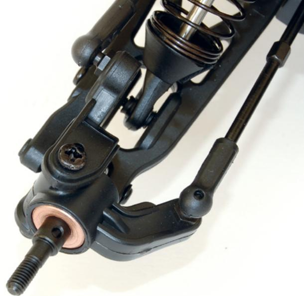
Die Lenkung in C-Hub-Bauweise entspricht gängigen Konstruktionsmerkmalen. Wer noch ein paar Euro übrig hat, der sollte zeitnah die Messingbuchsen der Radlagerung gegen Kugellager tauschen. Dadurch lassen sich Reibung und Spiel an den Radachsen deutlich reduzieren
