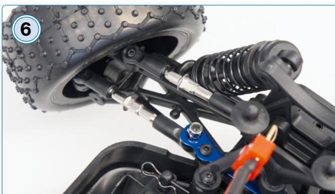
Wie bei einem Wettbewerbsmodell können Spur und Sturz über Rechts-links-Gewindestangen eingestellt werden
