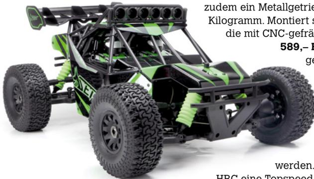
der elektronische Drehzahlregler, Servo, Sender und Empfänger enthalten. Alle Elektronikkomponenten sind laut Hersteller wasserdicht. Zur Inbetriebnahme muss der 4.300 Gramm wiegende Desert-Truck noch mit Akkus und Batterien für den Sender ausgestattet werden. Wird ein 4s-LiPo verwendet, verspricht HRC eine Topspeed von etwa 75 Kilometern pro Stunde.
