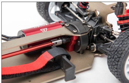
Vor dem gekapselten Hauptzahnrad verbirgt sich unter dem Top Deck die Sechskantmutter zur Einstellung des Slippers
