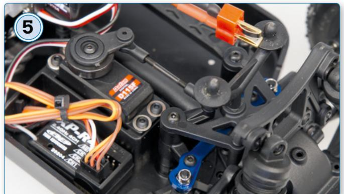
Das Lenkservo überträgt seine Power über eine Zwei-Pfosten-Lenkung auf die Vorderräder
