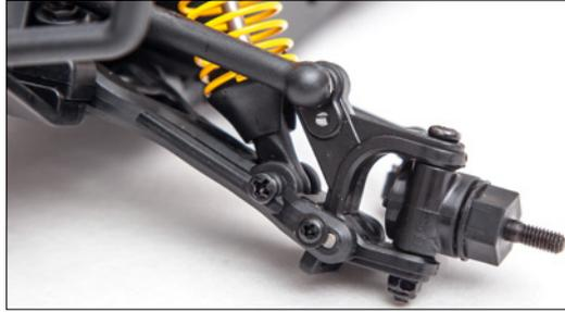
Die obere Spurstange der Vorderachse ist nicht einstellbar. Es gibt eine zweite Befestigungsmöglichkeit, wodurch sich der Sturz des Rads ändert
