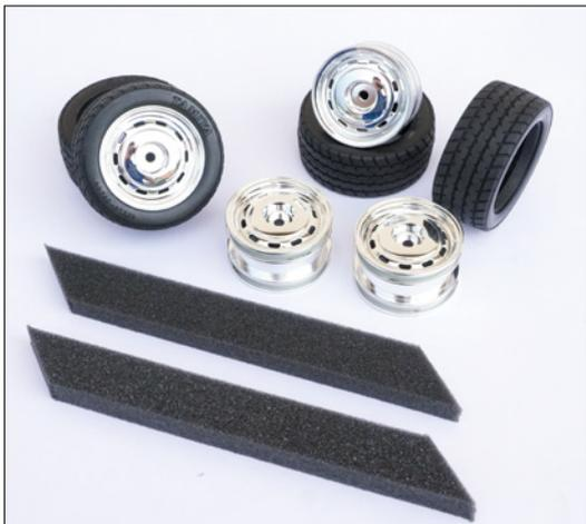
Die profilierten Hohlkammerreifen bieten erstaunlich guten Griff. Nach dem Einsetzen der Einlagen müssen die Reifen auf die Felgen geklebt werden
