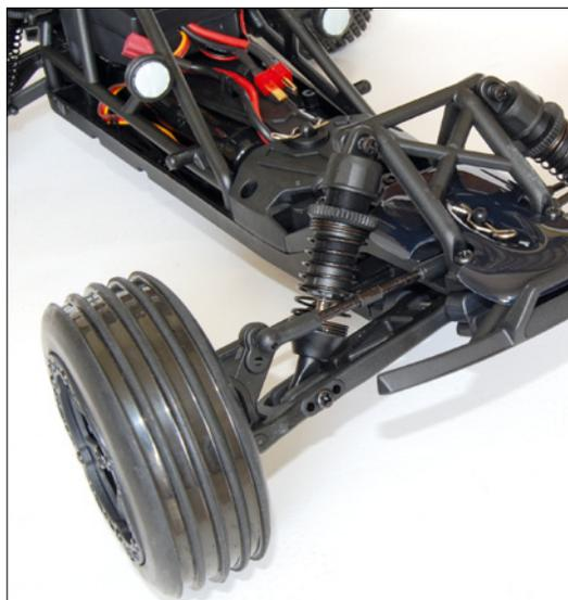
Rillenreifen und Rechts-links-Gewindestangen sind Bestandteil der Vorderachs-Komponenten
