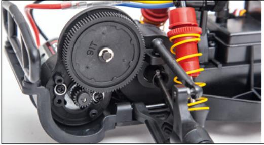
Mit zwei Schrauben ist die Getriebeabdeckung befestigt. Darunter verbirgen sich das Motorritzel und das Hauptzahnrad
