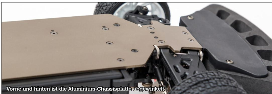
Vorne und hinten ist die Aluminium-Chassisplatte abgewinkelt
