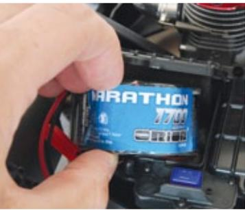
Ein 1.700-Milliampere-stunden-Nickel-Akku versorgt die Servos und die Empfangsanlage mit Strom. Hier ist er in der Standard-Akku-Box untergebracht
