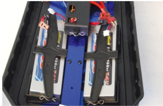
In den beiden Akkualterungen im hinteren Teil des FY5 sind bereits zwei 2s-LiPo-Akkus platziert. Auf dem Oberdeck befindet sich die Box für den Vierkanal-Empfänger
