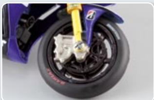
Der Nachlauf am Vorderrad kann eingestellt und damit das Lenkverhalten an die Streckenbedingungen und Setup angepasst werden.
