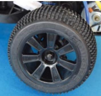
An der Hinterachse sorgen Kamikaze-Reifen von VTEC mit einem Durchmesser von 84 Millimeter bei einer Breite von 38 Millimeter für den nötigen Grip
