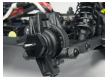
Die Radaufhängungen sind sehr stabil ausgeführt. Dank der 12-Millimeter-Mitnehmer lassen sich auch andere Räder montieren
