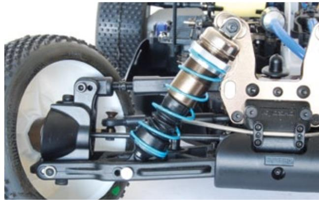
Die Aluminium-Öldruckstoßdämpfer verfügen über Rändelschrauben zur Einstellung der Federvorspannung
