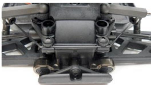
Die Hinterachse des neuen FS2 (unten) ist generell etwas solider gebaut, da einige Spritzgussteile verstärkt wurden. Eine deutliche Verbesserung ergibt sich bei der Montage der über Einsätze verstellbaren Querlenkerhalter aus hochwertigem Aluminium
