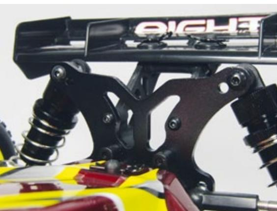
Unterschiedliche Fahrwerks-Setups lassen sich über Dämpferbrücken aus 2,5-Millimeter-Aluminium einstellen. Der massive Heckspoiler bringt den nötigen Anpressdruck auf die Hinterachse
