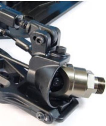
**Die C-Hubs bieten den Aluminum-Lenkhebeln Schutz**
