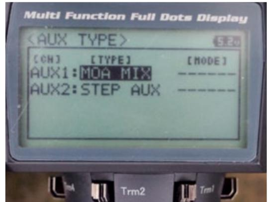
Über die MOA Mix-Funktion lassen sich Crawler mit zwei getrennten Motoren und Reglern ansteuern
