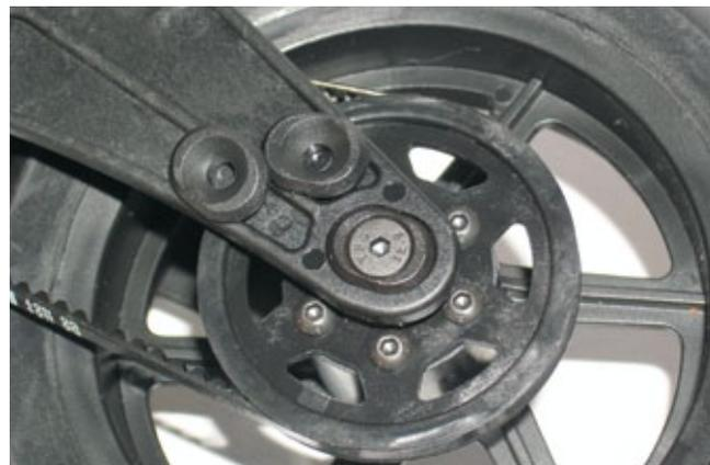
Die Riemenspannung wird durch Verschieben der Hinterradachse angepasst. Entsprechende Aufnahmen liegen dem Modell bei
