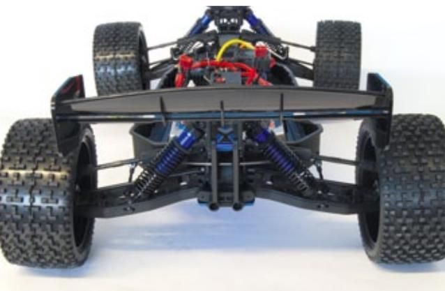
Die technische Ausstattung der Hinterachse kann überzeugen. Zwischen den Differenzial-Outdrives und den Rädern werkeln solide Antriebswellen in CVD-Bauweise und auch ein Stabi ist serienmäßig verbaut
