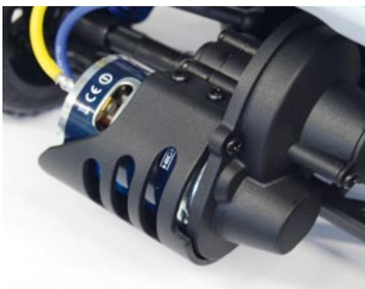
Der S10 Twister High Speed Motor leistet 23.500 Umdrehungen pro Minute und ist klassentypisch mitsamt der gekapselten Getriebeeinheit und einem Kegelraddifferenzial an der Hinterachse platziert
