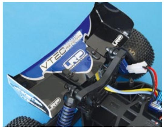
Ein großvolumiger Heckspoiler aus Kunststoff garantiert ordentlich Abtrieb auf der Hinterachse. Bei härteren Landungen kommen dem Spoiler jedoch die Hinterreifen in die Quere, gegen die er beim Einfedern gepresst wird
