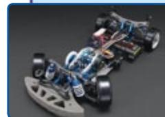
des DRB-Chassis sind ein Allradantrieb über zwei Riemen, ein sehr niedriger Schwerpunkt, voll einstellbare Aluminium-Öldruckstoßdämpfer, ein maximaler Einschlagwinkel der Vorderräder von
