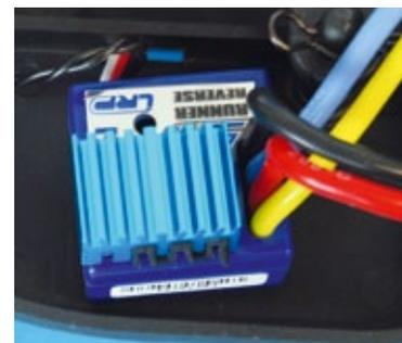
Der AI-Regler ist auf der linken Seite des Chassis verbaut. Er verfügt über Kühlrippen und ist mit einem Anschlusskabel samt Tamiya-Stecker für den Fahrakku versehen
