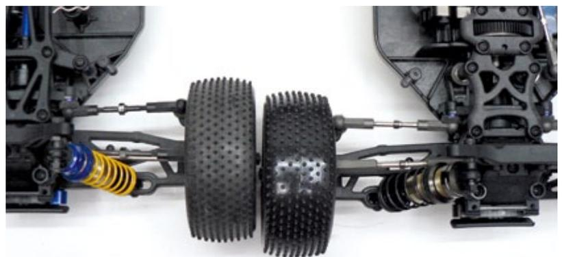
Der Radstand des FS2 (rechts) ist um fünf Millimeter gewachsen und die Rechts-links-Gewindestangen sowie die Kugelpfannen wurden überarbeitet
