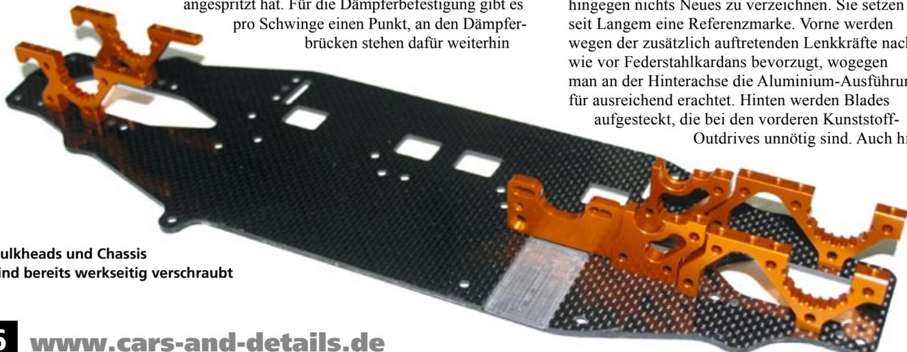
Bulkheads und Chassis sind bereits werkseitig verschraubt
