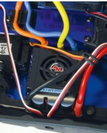
Eine Dauerbelastung von 80 Ampere verkräftet der Brushless-Regler, der serienmäßig mit einem Y-Kabel zum Anschluss von zwei 2s-LiPos versehen ist
