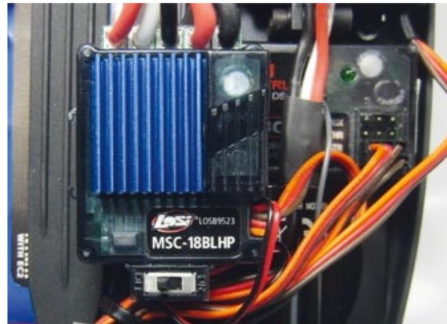
Die Reglereinheit MSC18 BLHP des 8ight Mini hat eine programmierbare LiPo-Cut-Off-Funktion. Der Kühlkörper sorgt für eine angenehme Betriebstemperatur
