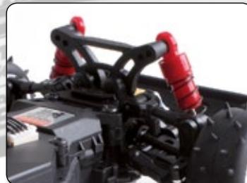
Hochwertige Öldruckstoßdämpfer mit einstellbarer Federvorspannung sorgen für das passende Dämpfungsverhalten am Mini-Z-Buggy. Die High-Grip-Offroad-Reifen garantieren den schlupffreien Kontakt auf jedem Terrain.
