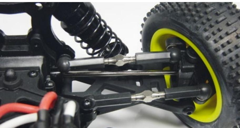
Dicke Rechts-links-Gewindestangen lassen eine Einstellung für Sturz und Spur zu
