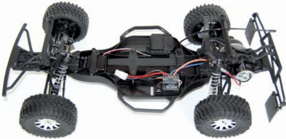
**Heckgetriebene Short Course-Trucks mit Elektroantrieb sind eine sehr gute Wahl für den Hobbyeinstieg. Erprobte, robuste Technik trifft auf einen breites Einsatzspektrum**
