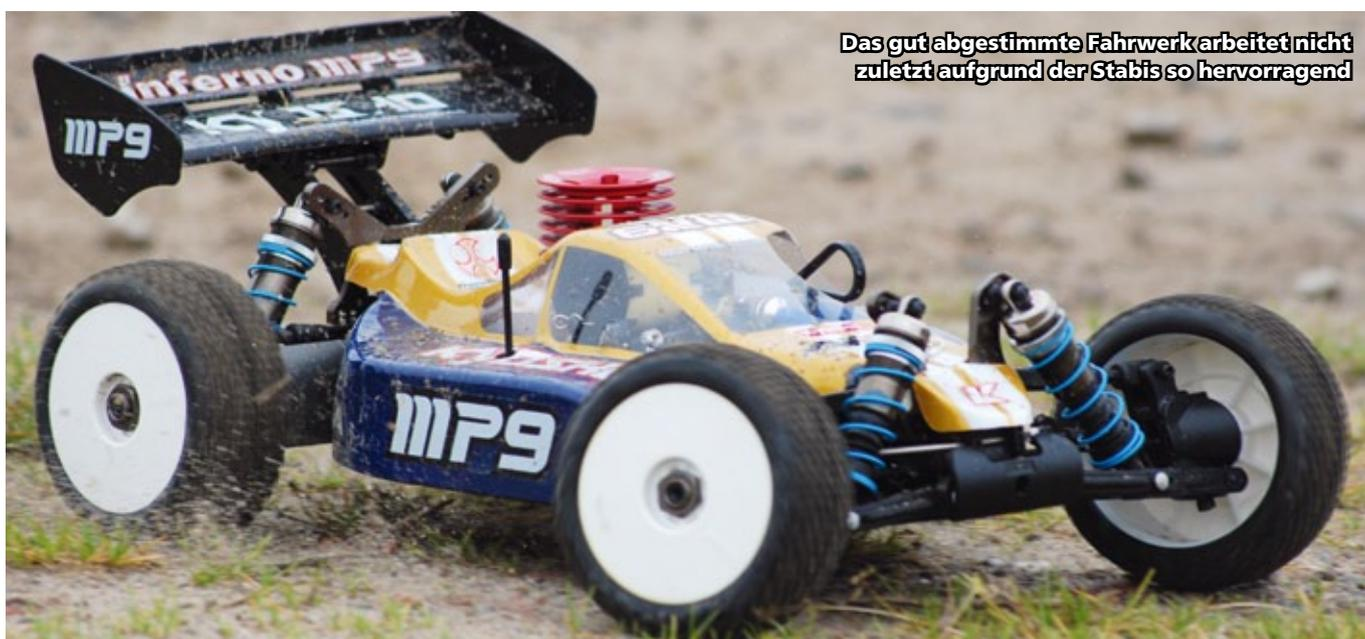
**Das gut abgestimmte Fahrwerk arbeitet nicht zuletzt aufgrund der Stabis so hervorragend**
