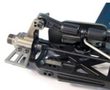
**Die unteren Querlenker sind vorne und hinten sehr robust ausgeführt. Die oberen Querlenker sind mit Rechts-links-Gewindestangen zur Einstellung des Sturzes ausgestattet**
