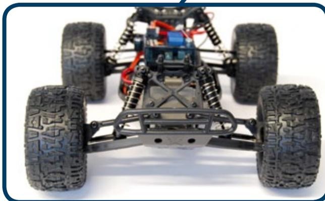
Die Kunststoff-Konstruktion der Vorderachse ist solide, aber flexibel genug, um bei Crashes nachzugeben. Da bricht nichts
