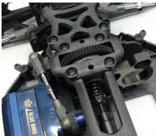
Die Slipper-Mutter ist in beiden Fällen gut erreichbar, der Slipper des FS2 (rechts) kann nach Lösen von nur vier Schrauben nach oben hin entnommen werden
