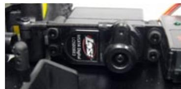
Das digitale Losi MSX14-Lenkservo im Miniformat hat einen wirksamen Servosaver montiert
