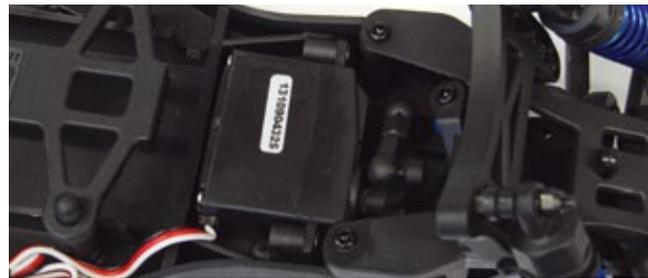
Das Lenkservo ist liegend hinter der Vorderachse verbaut
