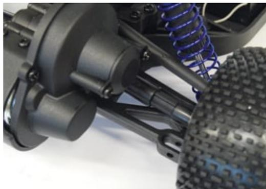
Teleskop-Kardans sorgen an der Hinterachse für die Weiterleitung der Motorkraft an die Räder
