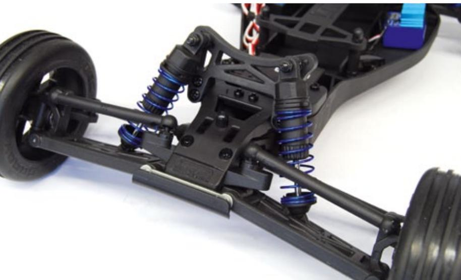
Kunststoff dominiert die Vorderachse des Twister. Sie basiert auf Doppelquerlenkern. Während unten Schwingen verbaut sind, handelt es sich bei den oberen Pendants um Kunststoffstreben, die beidseitig auf Kugelhöfen platziert sind
