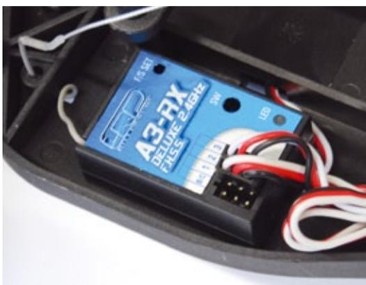
Auf der rechten Chassisseite befindet sich die Empfangseinheit der 2,4-Gigahertz-Anlage, die dem RTR-Set beiliegt. Hierbei handelt es sich um einen A3-RX-Dreikanalempfänger
