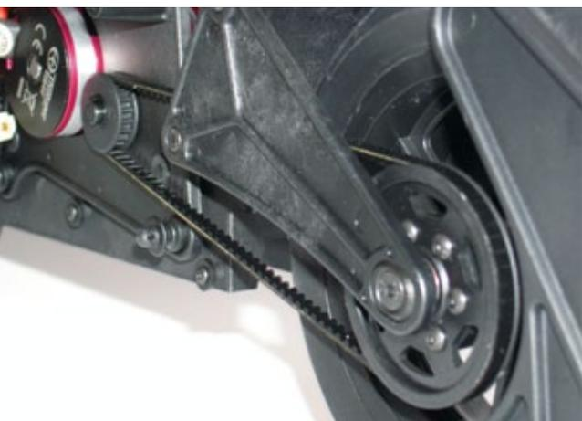
An der hinteren Doppelarmschwinge sorgt ein leichter Riemenantrieb für verlustarme Kraftübertragung vom kernigen Brushlessmotor zum mitunter etwas überforderten Hinterreifen
