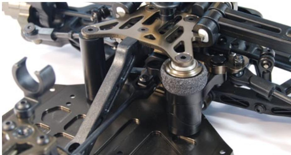
**Die Lenkung basiert auf einem Zwei-Pfosten-System. Der Servosaver ist stufenlos über eine Rändelschraube einstellbar. Ein Schaumstoffring schützt hier das Gewinde**
