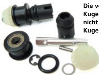
Die verwendeten Materialien und die Konstruktion der Kugeldifferenziale sowie der kleinen Kegelräder wurde nicht verändert, selbst Details wie die Teflon gedichteten Kugellager wurden übernommen
