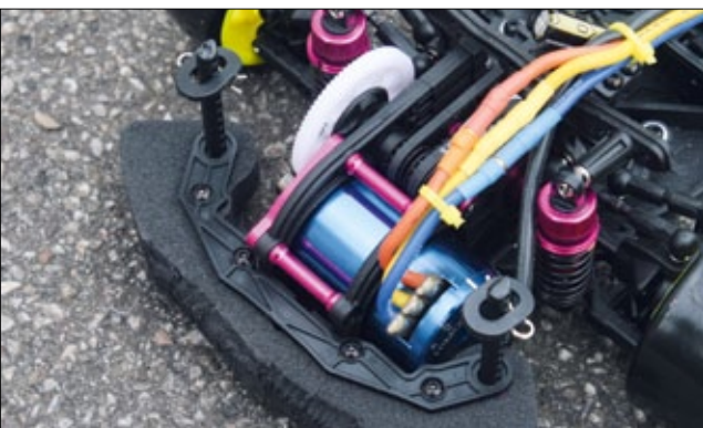
Weit vorne, eingebettet in den Frontrammer: das Antriebsaggregat
