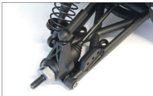
Die Sechskantmitnehmer sind verschraubt. Zum Schutz vor Dreck und Feuchtigkeit sind die Gelenke der Antriebswellen mit Gummimanschetten ausgestattet
