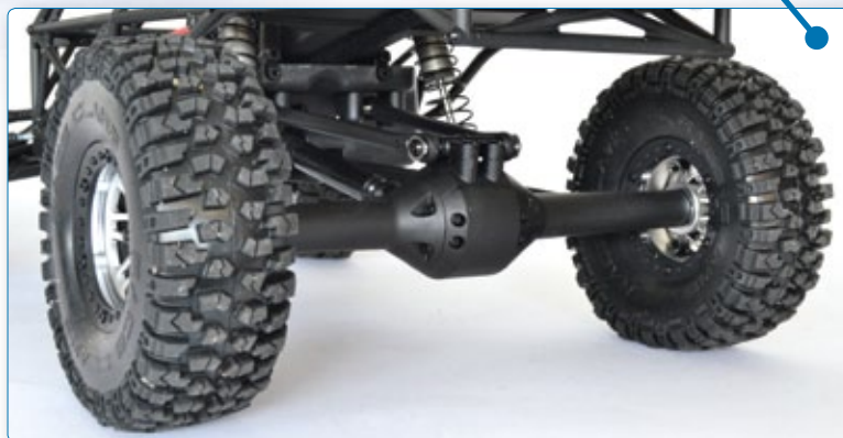
Als Kontrast zu vielseitig einstellbaren Vorderachse mit Doppelquerlenkern findet sich hinten eine Starrachse mit Vier-Link-Aufhängung. Das Differential ist komplett gesperrt
