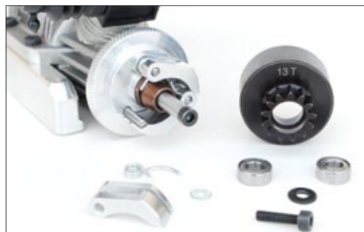
Eine Dreibackten-Alukupplung mit 0,9-Millimeter-Federn gehört zur Serienausstattung. Die 5 x 10-Millimeter-Lager der Kupplungsglocke sind die Achillesferse und benötigen entsprechend viel Aufmerksamkeit
