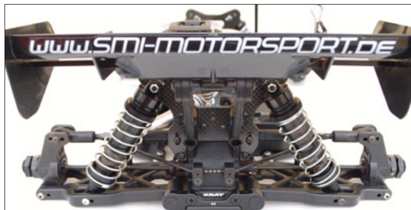
Die Laserkennzeichnung des Stabidrahts ist gut erkennbar. Der linke Dämpfer wird, ebenso wie der vorne rechts, mit einer Linksgewindeschraube befestigt
