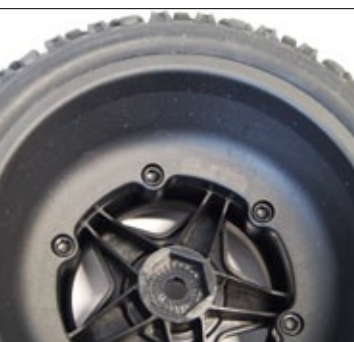
Beadlock mal andersherum. Die Felgen sind auf der Innenseite verschraubt
