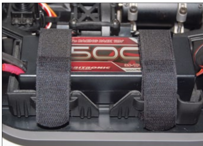
Gängige Akkuhalter von 1:8er-Modellen nehmen das 3s-Pack locker auf
