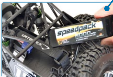
Der 2.000er-3s-LiPo kann längs oder quer über der Hinterachse platziert werden
