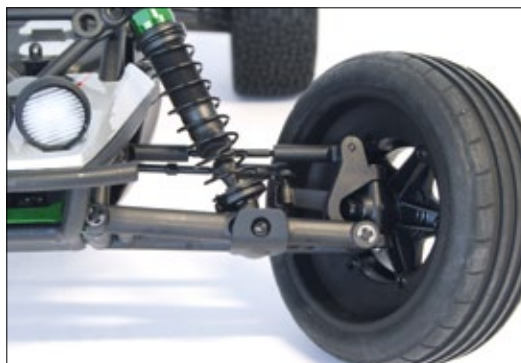
Die soliden Doppelquerlenker halten einiges aus
