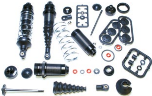
Prinzipiell sind die Dämpfer gut verarbeitet. Der Staubschutzbalg könnte allerdings etwas dicker sein, während die Rändelmutter auf dem Gehäuse schwergängiger sein dürfte
