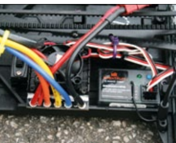
Für Fahrregler und Empfänger ist ausreichend Platz vorhanden
