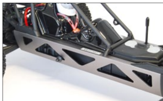
Das gezogene Aluminum-Chassis ist durch seine U-Form sehr verwindungssteif
