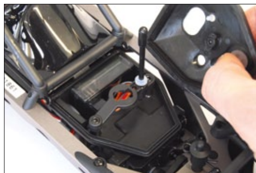
In der wasserdichten RC-Box sitzt ein Spektrum-Empfänger. Der Deckel lässt sich mit einem Drehverschluss leicht entfernen
