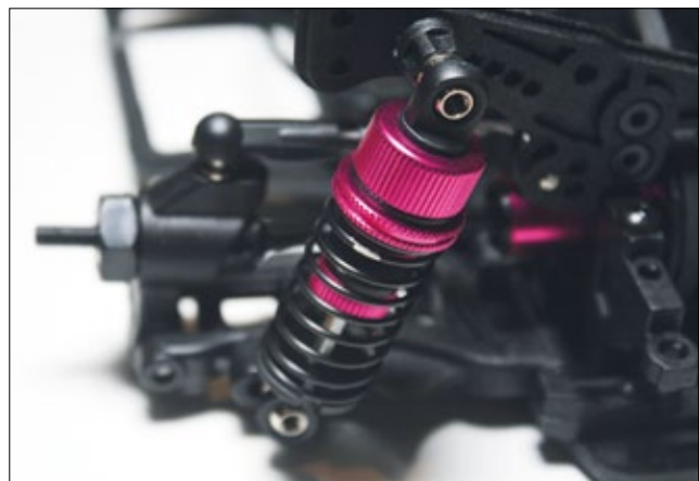
Per Rändelmutter lässt sich die Federvorspannung regulieren
