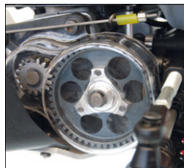
Ein Muss für TR4-Fahrer: der optionale Getriebeschutz. Er hält Schutz und Steinchen von den Zahnradern fern und erhöht somit die Lebensdauer. Ebenfalls empfehlenswert: die Nachrüstung des Stahl-Hauptzahnrad
