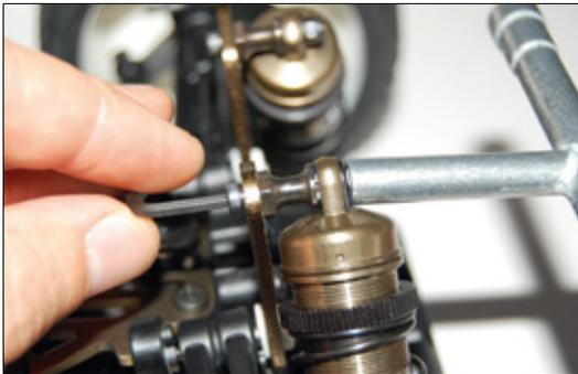
Zumindest die wichtigsten Schraubverbindungen sind vor der Inbetriebnahme zu checken. Dafür eignet sich auch das beiliegende Bordwerkzeug
