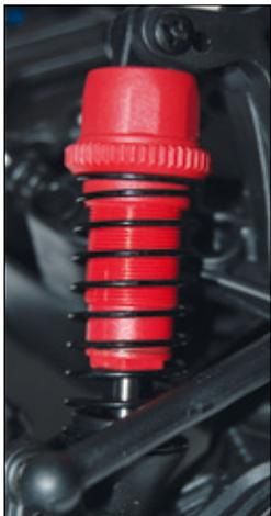
Mittels des beiliegenden Silikonöls lassen sich die Bigbore-Dämpfer befüllen und verdienen dann auch ihren Namen
