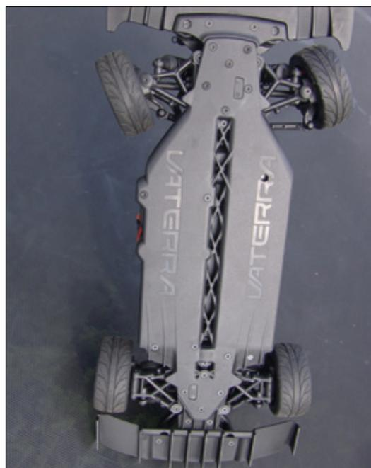
Die Chassis-Bodenwanne mit verstrebttem Mittelsteg sowie dem verschraubten Front- und Heck-Diffusor. Innensechskant-Senkkopfschrauben sorgen für eine glatte Unterseite
