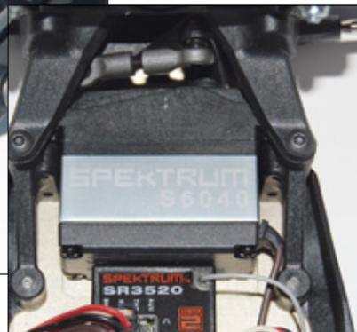
Als Lenkservo kommt ein schnelles und starkes Spektrum S6040 in Standard-Abmessungen zum Einsatz. Ein Low-Profile-Servo ist also nicht notwendig
