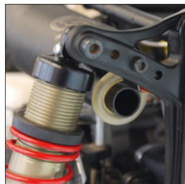
Die serienmäßige Halterung des Endrohrs passt auch beim Einsatz eines Resonanz-Schalldämpfers
