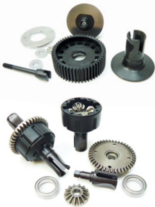
Die abgedichteten Kegeldifferenziale des DEX410R ermöglichen eine Abstimmung über unterschiedliche Ölviskositäten, während beim DEX210 ein Kugeldifferenzial (oben) zum Einsatz kommt
