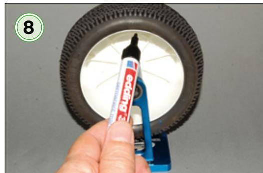
an, mit denen sich die Räder wuchten lassen. Dazu wird eins der Räder aufgespannt und mit der Hand in Rotation versetzt.
