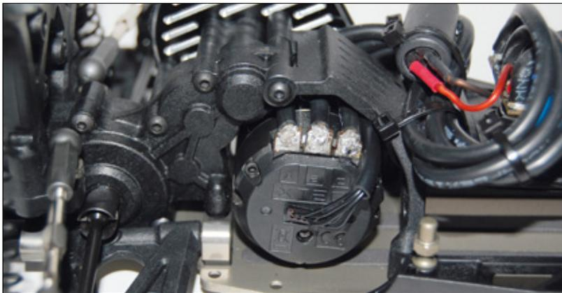
Moderne, heckgetriebene Buggys im Maßstab 1:10 setzen auf zwei verschiedene Einbaupositionen des Motors. Hier wurde der Platz vor der Hinterachse gewählt
