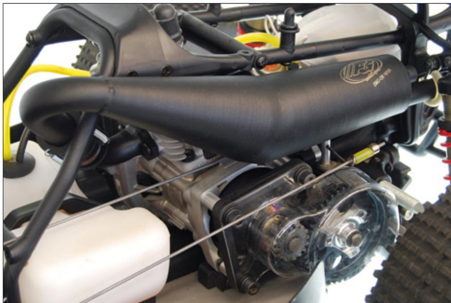
Das Tuning-Resorrohr passt optimal ans Chassis und erhöht die Leistung vor allem im oberen Drehzahlbereich
