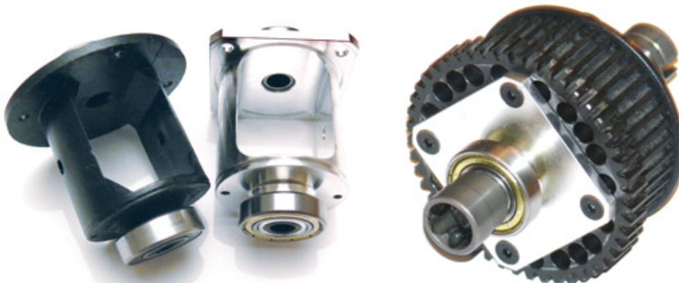
Das Differenzial-Gehäuse aus Kunststoff musste dem stabileren und haltbareren Aluminium-Pendant weichen. Einen Satz neue Lager gibt es ebenfalls
