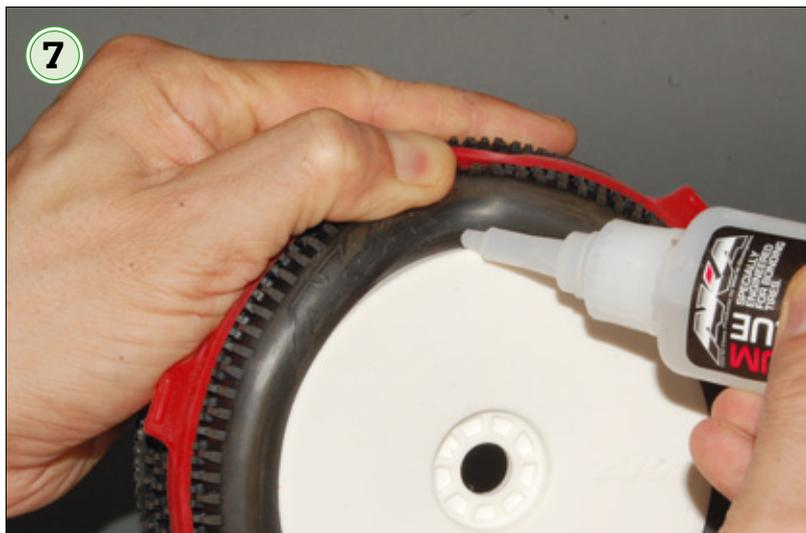
Je nachdem, ob die Reifen zuerst innen oder außen verklebt werden sollen, haben die Klebeflächen der Reifen und der Felgen auf der entsprechenden Seite möglichst bündig zu sitzen. Optimale Hilfe leisten dabei spezielle Reifenklebegummis aus dem RC-Zubehör. Es gilt: Je besser die Reifen unverklebt auf den Felgen sitzen, desto einfacher lassen sie sich später verkleben.
