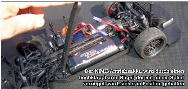
Der NiMH-Antriebsakku wird durch einen hochklappbaren Bügel, der mit einem Splint verriegelt wird, sicher in Position gehalten
