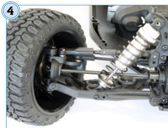
Doppelquerlenker, Rechts-links-Gewindestangen und Öldruckstoßdämpfer: Der Sandrail von XciteRC macht einen guten Eindruck
