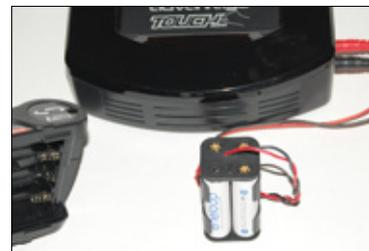
Statt in der Empfängerbox, dient der ursprüngliche Empfängerakkushalter jetzt als Ladefassung für die Senderakkus. Diese externe Umsetzung ist dem direkten Laden in der Fernsteuerung vorzuziehen
