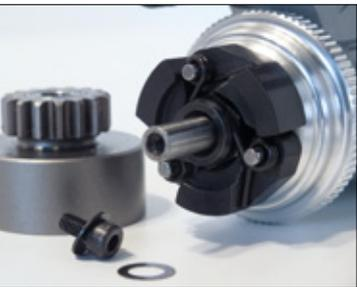
Mit der Dreibackten-Teflon-Kupplung verfügt der RC8.2 Race Spec nur über Standard-Equipment
