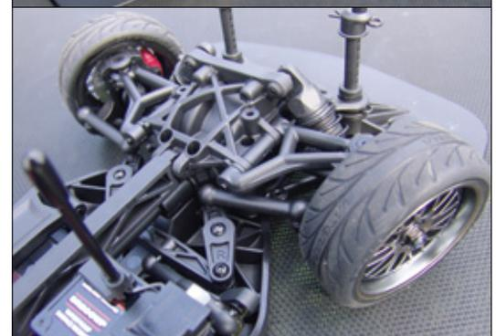
Vorderachse mit Einzelradaufhängung, Stoßdämpfern und gekapseltem Getriebe
