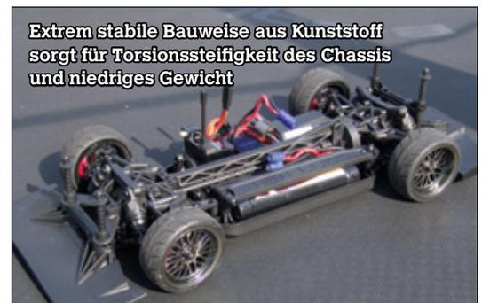
Extrem stabile Bauweise aus Kunststoff sorgt für Torsionssteifigkeit des Chassis und niedriges Gewicht
