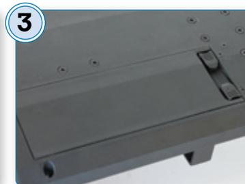
Zwar ist die Karosserie komplett verschraubt, doch der Akku lässt sich über eine Klappe auf der Chassis-Unterseite wechseln
