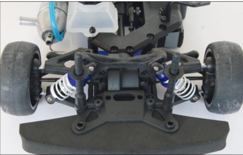
Vorne verfügt der FW-06 über eine Starrachse. Die Alu-Öldruckstoßdämpfer können an unterschiedlichen Punkten befestigt werden
