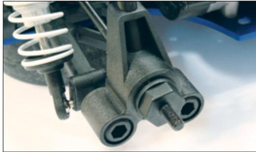
An der Hinterachse sind die Pivot-Aufnahmen horizontal angeordnet. Auf diese Weise kann die Vorspur feinjustiert werden
