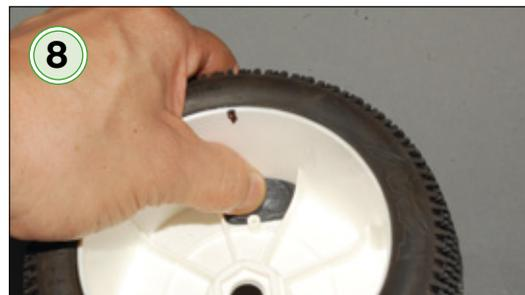
Nun werden das Rad aus der Wuchtvorrichtung gespannt und an der markierten Stelle spezielle Wuchtmasse platziert. Diese ist ebenfalls im Fachhandel erhältlich. Wie viel der Masse man anbringt und wie oft man den Wuchtvorgang wiederholt, ist ein reiner Erfahrungswert. Ziel der Übung ist es, dass das Rad auf der Auswuchtmaschine nicht immer in derselben, sondern in unterschiedlichen Positionen zum stehen kommt.
