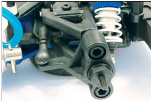
Die Pivotball-Aufhängung der Vorderachse ermöglicht die Einstellung des Radsturzes
