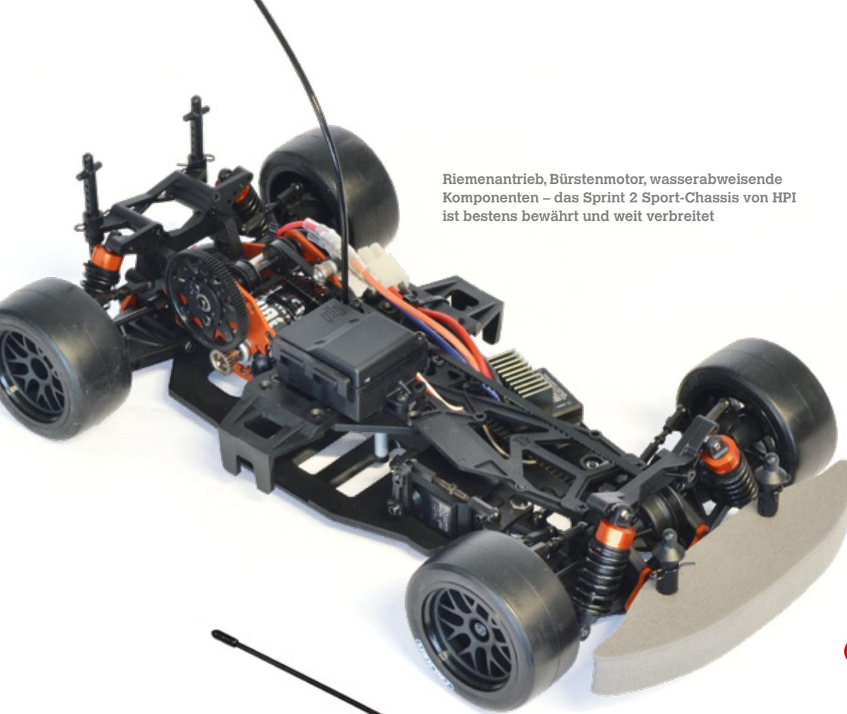
Riemenantrieb, Bürstenmotor, wasserabweisende Komponenten – das Sprint 2 Sport-Chassis von HPI ist bestens bewährt und weit verbreitet
