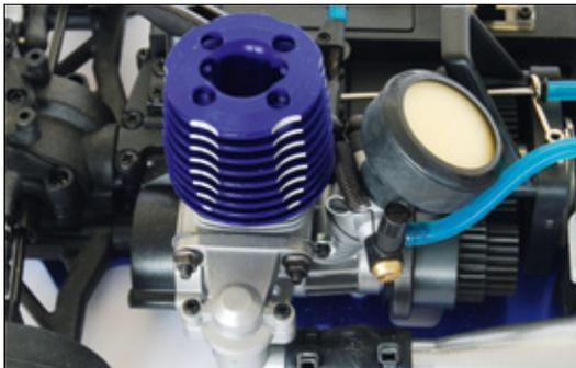
Angetrieben wird der FW-06 von einem GXR-15-Motor. Die Verschlauchung ist bereits ab Werk erledigt und das Modell damit betriebsfertig. Bei entsprechender hoher Geschwindigkeit, schaltet das Getriebe automatisch in den zweiten Gang. Der Schaltzeitpunkt ist einstellbar
