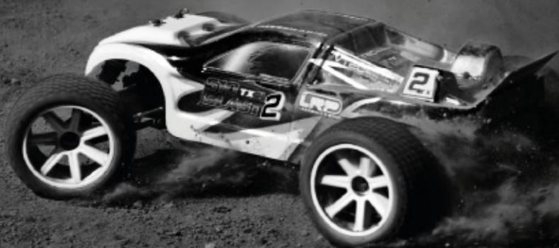
Die S10 Blast 2 Brushless Fahrzeuge sind mit einer extrem leistungsstarken Antriebskombo aus Vector K7 und Spin RTR Regler ausgestattet. Diese Kombination ist ideal für Highspeed-Fahrten und leichtes Offroad-Gelände. Wer unter deutlich erschwerten Bedingungen fahren möchte, sollte am Motor unbedingt den unter der LRP Artikelnummer #82515 erhältlichen Tuning-Lüfter montieren. Damit vermeiden Sie zu hohe Motortemperaturen und somit ein frühzeitiges Abschalten.
