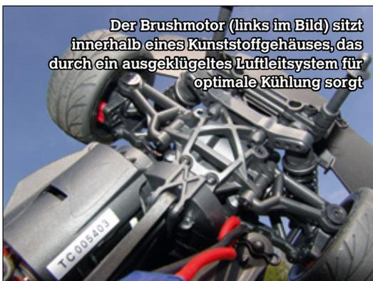
Der Brushmotor (links im Bild) sitzt innerhalb eines Kunststoffgehäuses, das durch ein ausgeklügeltes Luftleitsystem für optimale Kühlung sorgt
