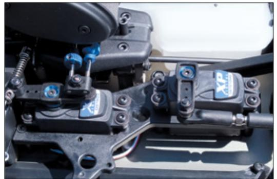
Das Oberdeck aus faserverstärktem Kunststoff bietet ausreichend Halt für die beiden stehend montierten Servos.
