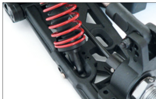
Die untere Halterung der Stoßdämpfer verhindert einen Verzug der Querlenker durch zu starkes Anziehen der Schrauben. Dadurch wird das untere Dämpferauge auch nach vielen Setup-Änderungen noch ohne Druck in die Aussparung passen
