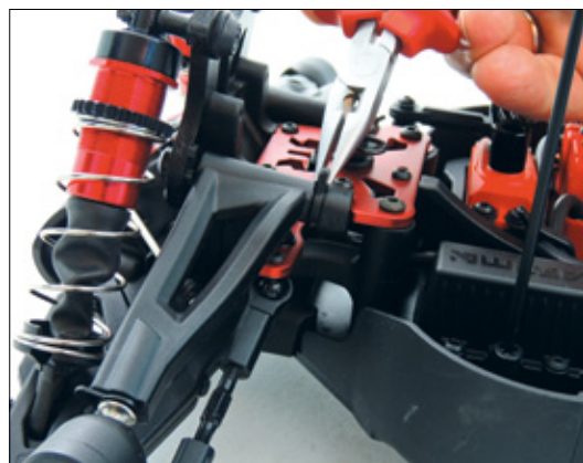
Das ganze Auto verfügt über vielerlei Einstellmöglichkeiten, wie zum Beispiel die Änderung des Nachlaufs der Vorderachse
