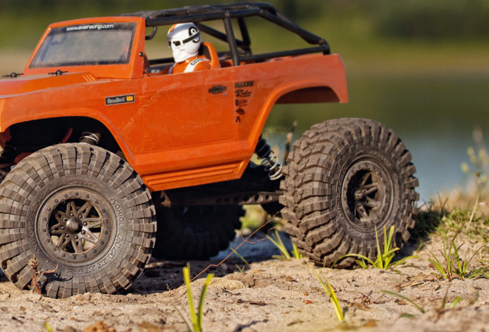
Solide Achsen mit Vier-Link-Aufhängungen leisten im Deadbolt gute Dienste
