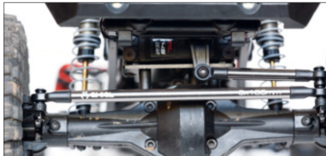
So wie es sich gehört: stabil und steif. Das Lenkgestänge aus Aluminium
