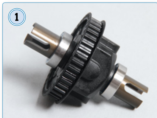
Der ARC wird – wie die meisten Tourenwagenchassis – mit einem wartungsarmen Kegelraddifferenzial ausgeliefert
