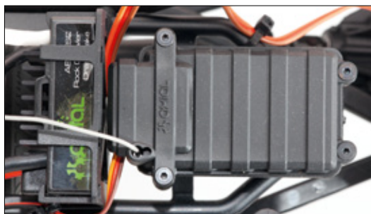
Der kleine Empfänger findet wohlbehütet in der Staub- und Spritzwasser-Geschützten Radio-Box Platz
