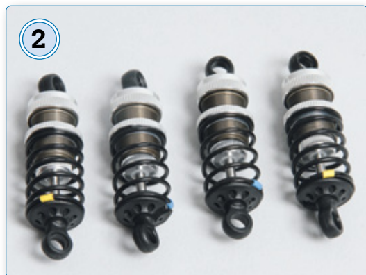
Die Stoßdämpfer sind neu und deutlich länger als zuvor. Auch die neuen Dämpferfedern sind länger. Es können aber auch noch die kurzen Federn verwendet werden
