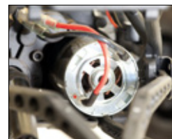
Ein 20-Turns-550er-Bürstenmotor treibt den Deadbolt an
