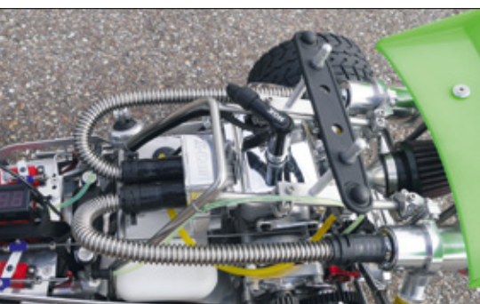
Der Zenoah G290RC-Motor wurde durch TGN X-can-Schalldämpfer und zwei DDM-Silencer erweitert
