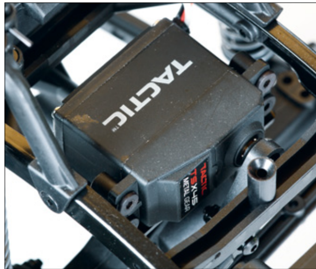
Das doppelt kugelgelagerte Lenkservo Tactic TSX45 ist mit Metallzahnradern ausgestattet
