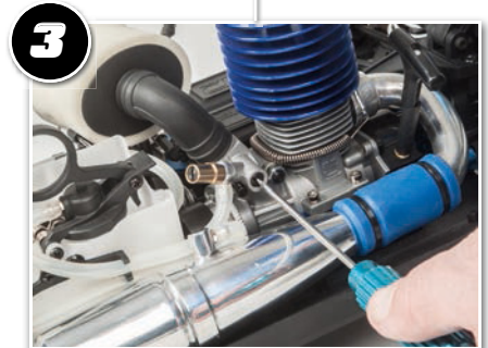
3 An der Düsennadel für den unteren Drehzahlbereich wird die Beschleunigungsphase des Motor eingestellt.
