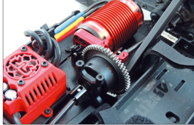
Langlebigkeit ist Trumpf. Stahl gibt es sogar beim Hauptzahnrad. Man beachte auch die massive Motorhalterung aus eloxiertem Aluminium
