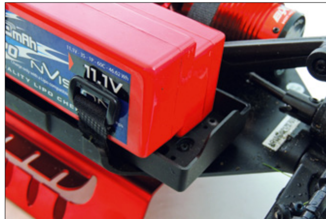
Trotz Verwendung relativ schmaler 3s-LiPos wird es im Akkuschacht zu eng
