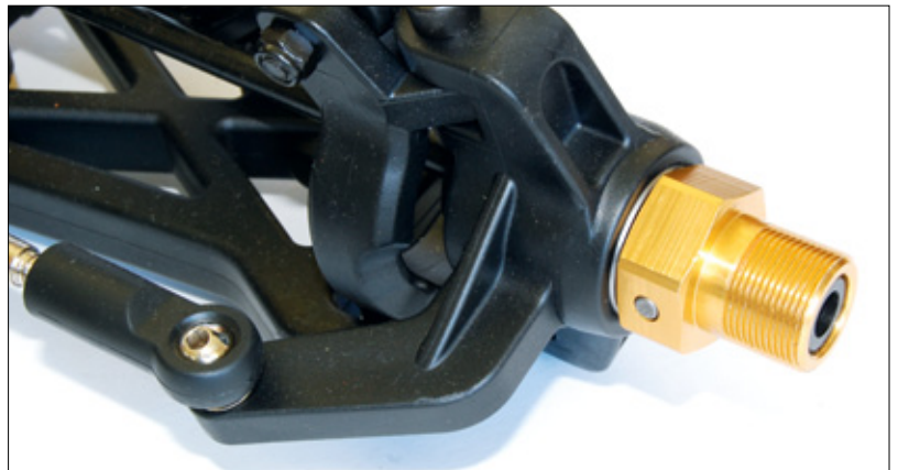
Gefräste Sechskant-Mitnehmer sorgen für eine verlustfreie Kraftübertragung zu den Rädern
