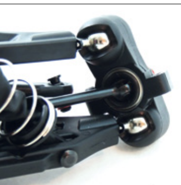
Ausgesprochen große Kugellager und CVD-Kardanwellen finden sich an der Vorderachse
