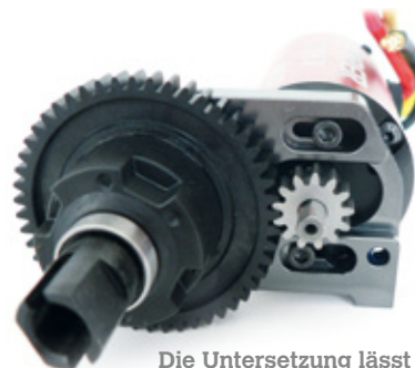
Die Untersetzung lässt sich nur in einem recht kleinen Bereich variieren und sollte wie die Schrauben vor dem ersten Start überprüft werden. Die nahezu ideale Zahnradpaarung (Stahlritzel zu Kunststoffhauptzahnrad) benötigt keinerlei Fett und arbeitet verschleißarm
