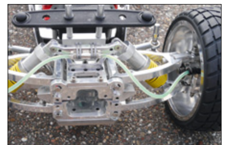
An der Vorderachse sorgt eine hydraulische Bremsanlage von Mecatech für gute Verzögerungswerte
