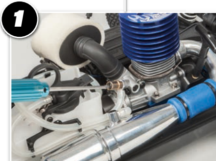
1 Die Nadel für den hohen Drehzahlbereich befindet sich oben am Vergaser. Hier wird die maximale Leistung des Motors eingestellt.
