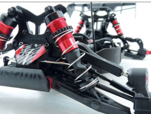
Die Big-Bore-Dämpfer funktionieren bestens und sind ab Werk mit Außengewinde und Dämpfersocken ausgerüstet
