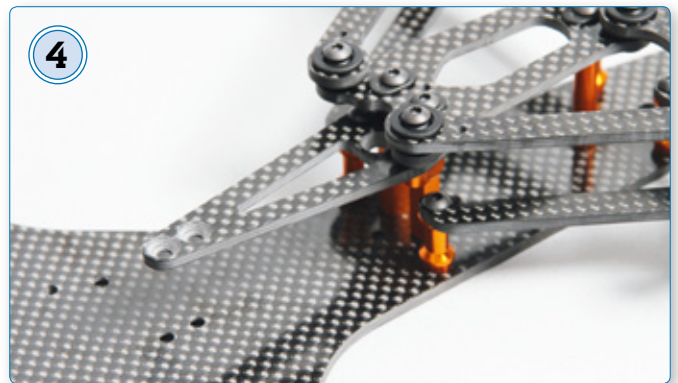
4 Der Servohalter wird an der Vorderachse montiert. Das Servo kann an ihm schwebend verschraubt oder alternativ wie im Vorgänger auf der Chassisplatte befestigt werden
