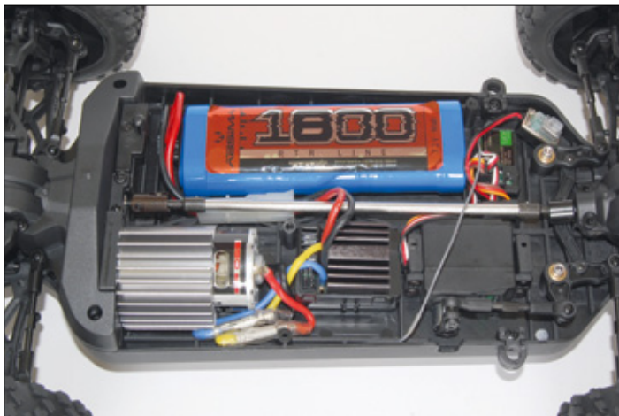
Offenherzig: Ohne den zusätzlichen Schutz zeigt der Absima seine Komponenten
