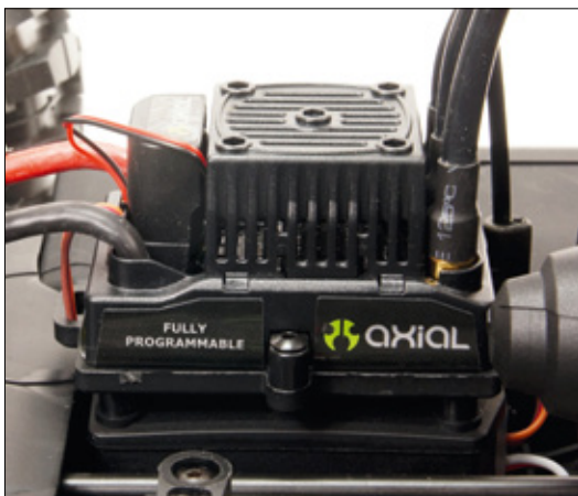
Der Vanguard AE 4-XL-Regler ist wasserdicht und nimmt es mit bis zu 6s-LiPos auf. Er ist zwangsgekühlt und voll programmierbar
