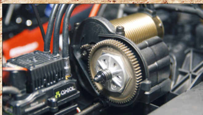
Der einstellbare Slipper weist Beläge aus Metall auf – bei der Power des Motors ist das auch unbedingt erforderlich
