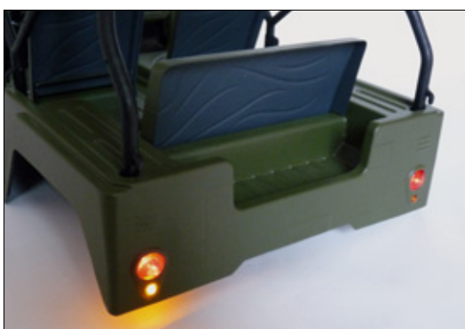
Die Blinkfunktion erfordert beim Warrior etwas Nacharbeit der hinteren Halterung, da ab Werk eigentlich gar keine Blinkfunktion vorgesehen ist
