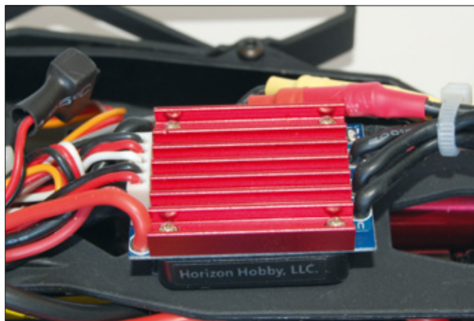
Der Fahrregler kommt mit einer passiven Kühlung aus und bietet ein präzises Regelverhalten
