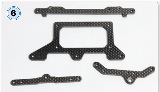
6 Die Kohlefaserenteile aus dem hinteren Teil des Fahrzeugs. Sie sind nun breiter, um die Tubes aufnehmen zu können
