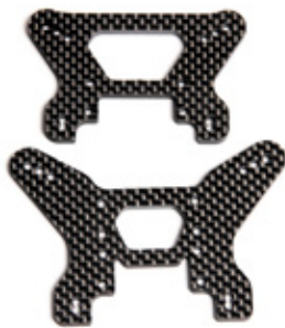
Die Stoßdämpferbrücken sind aus Kohlefaser und bieten verschiedene Anschraubpunkte
