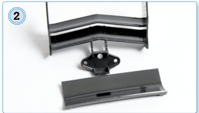
2 Beim neuen Heckflügel kann das obere Luftblech in zwei verschiedenen Positionen angebracht werden. Dadurch wird der Abtrieb erhöht oder reduziert
