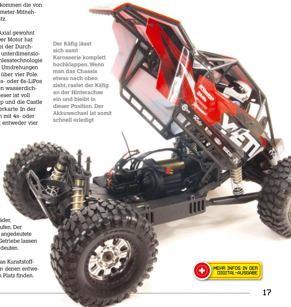
Die Chassiswanne nimmt nur zirka zwei Drittel der gesamten Länge ein. Der Rest ist für die Aufhängung im hinteren Bereich reserviert
