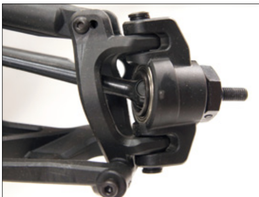
Stabile C-Hubs an der Vorderachse und CVD-Wellen sind bei diesem RTR-Modell Standard. 17-Millimeter-Sechskantmitnehmer sorgen für einen ordentlichen Kraftschluss zwischen Achse und Felge
