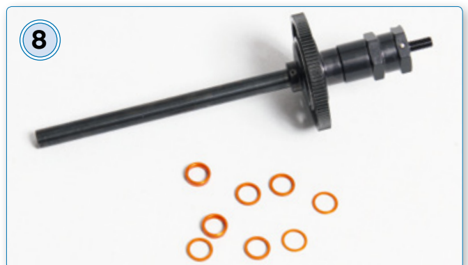
8 Die Antriebsachse und das darauf liegende Kugeldifferenzial. Mit den Scheiben wird die Breite des Fahrzeugs bestimmt
