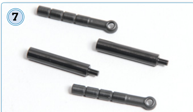
7 Die beiden Tubes werden mit Silikonöl befüllt. Sie ersetzen den Querdämpfer aus dem Vorgänger. Dieser ist separat erhältlich
