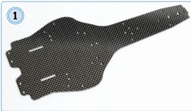
1 Die Chassis-Platte bleibt im Vergleich zum Vorgänger unverändert. Der breite Schnitt zur Realisierung verschiedener Akkupositionen wurde von anderen Herstellern übernommen
