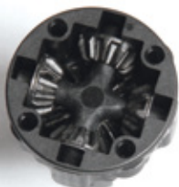
Das Innere eines der beiden Kegeldifferenziale
