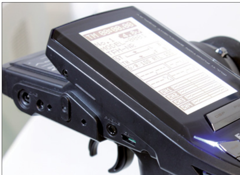
Auf der Rückseite befindet sich neben Lade- und Kopfhörerbuchse auch ein S.Bus-/S.BUS2-Anschluss
