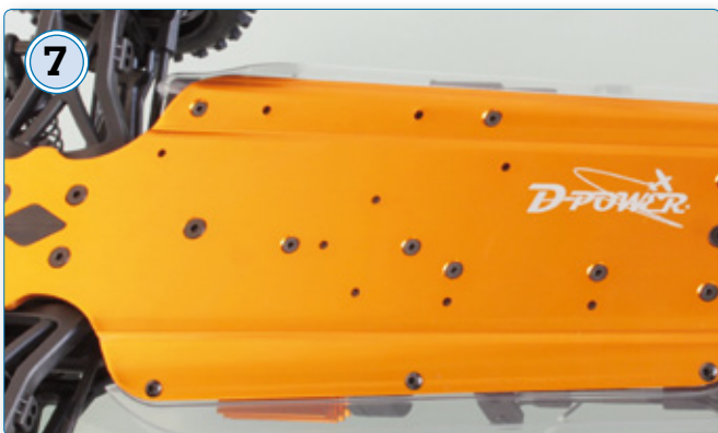
7 Die geschlossene Unterseite der Aluminium-Chassis-Platte sorgt in Verbindung mit der eng anliegenden Karosserie für einen guten Schutz
