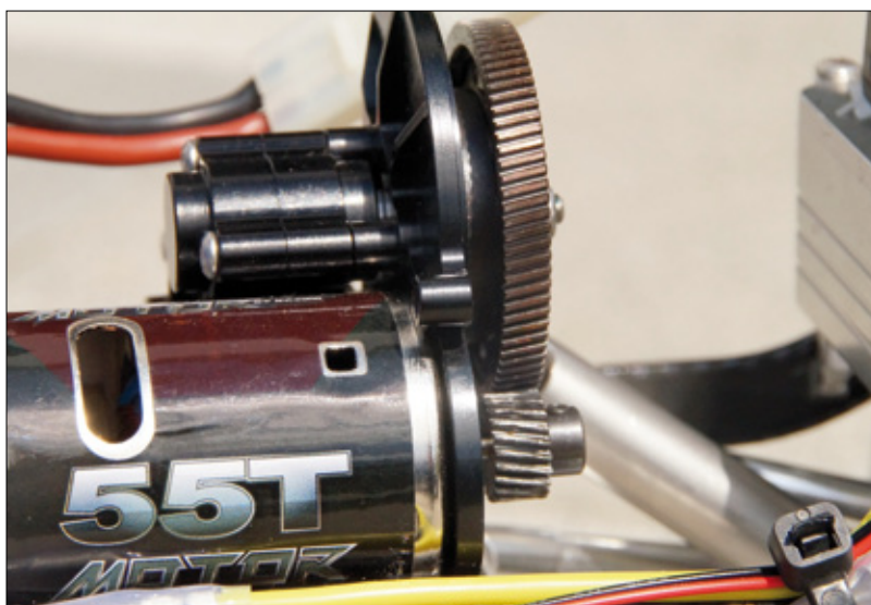
Über schrägverzahnte Haupt- und Motorzahnäder aus Stahl wird die Kraft effizient an das Getriebe übertragen
