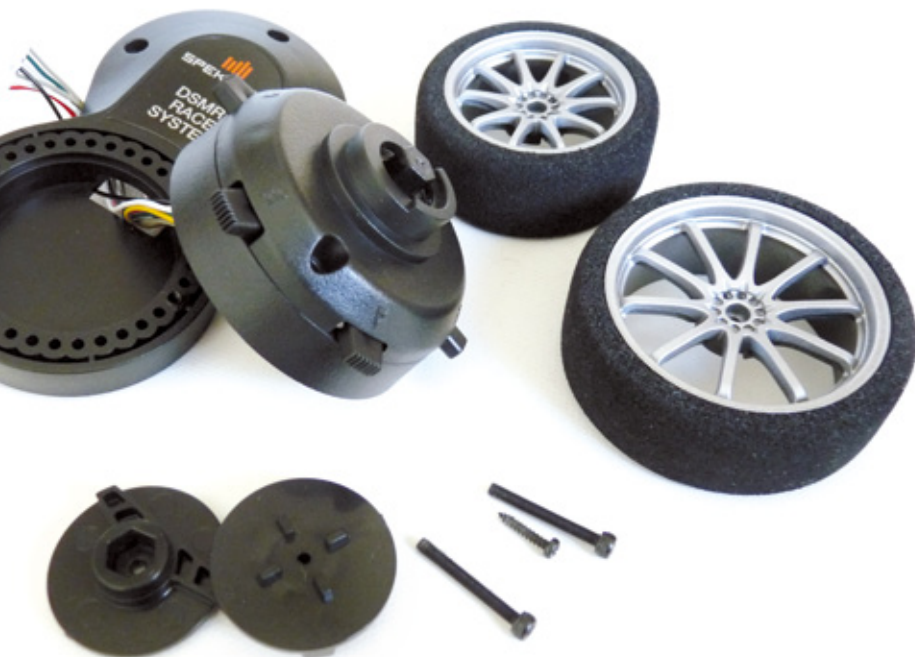
Der Umbau des Lenkrads geht extrem schnell, wobei sollte auf die Adapter man Acht geben, jeweils einer gehört zu seinem Lenkrad, ein Verwechseln führt zu einem kürzeren Lenkweg
