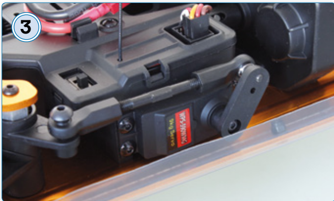
3 Das Lenkservo hat bei allen Modellen eine Stellkraft von 9 Kilogramm und bewegt die Zweiposten-Lenkung
