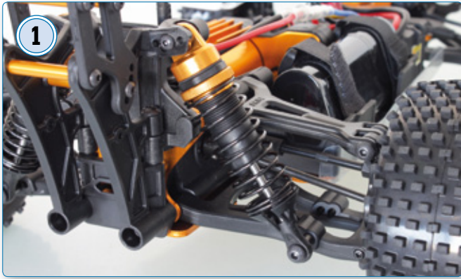
1 Vier Öldruckstoßdämpfer bringen Ruhe ins Fahrwerk
