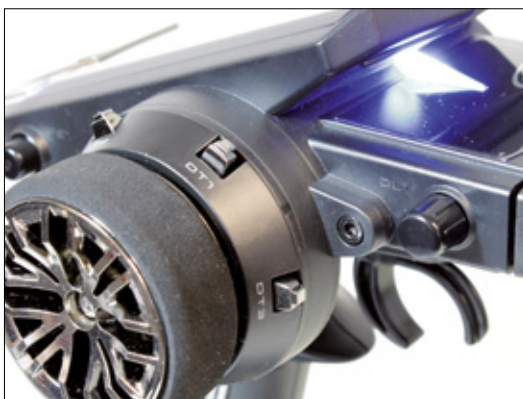
Der Drehgeber kann, wie alle anderen Schalter und Taster, frei mit Funktionen belegt werden. Die rückwärtige LED zeigt an, dass keine Telemetrie Verbindung besteht
