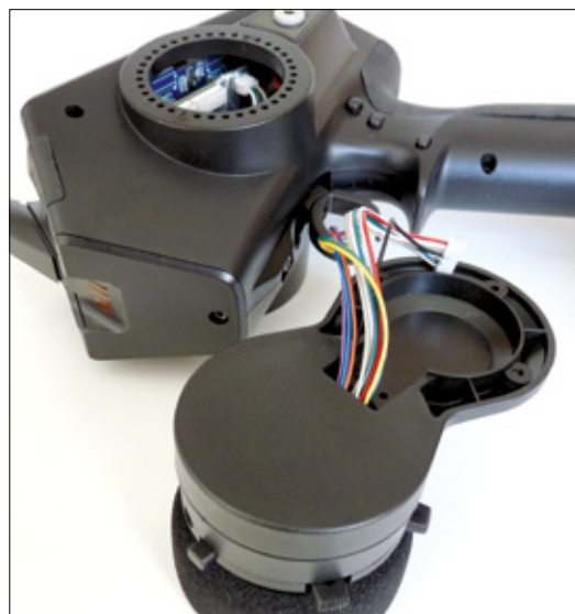
Der Wechsel von Linkshänder zu Rechtshänder kann sehr schnell durchgeführt werden, obwohl die Kabel etwas starr und kurz gehalten sind. Zusätzlich hat man mit den vielen Befestigungspunkten und zwei angewinkelten Adaptern die Möglichkeit, das Lenkrad nicht nur tiefer zu setzen, sondern es auch zu drehen
