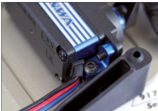
Zum Glück ist das Kabel unseres Sanwa Servos mit einer Silikontülle geschützt
