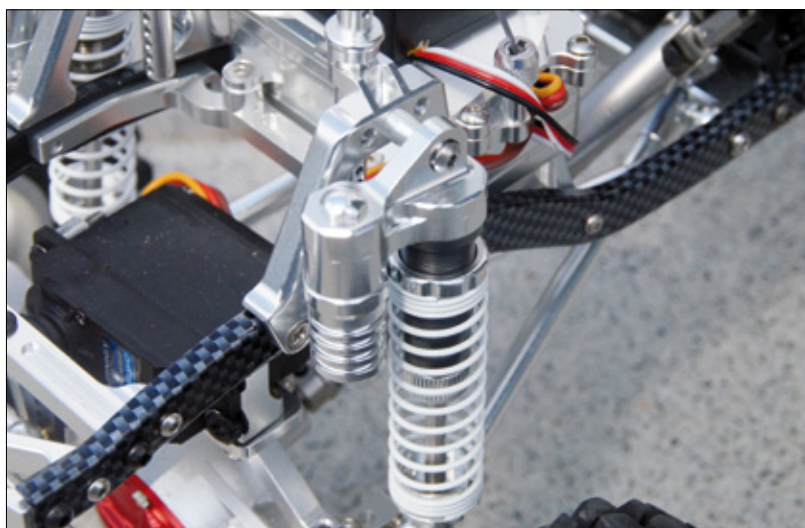
Die Alustoßdämpfer mit einstellbarer Rändelmutter sowie Ausgleichskammern arbeiten super soft und haben ein grandioses Ansprechverhalten
