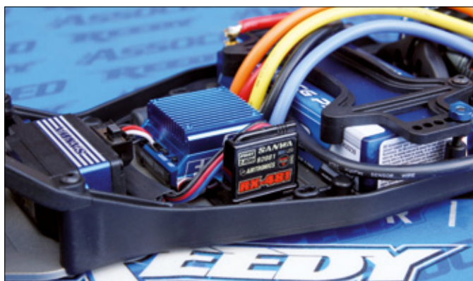
Die Elektronik findet auf dem gefrästen Aluminiumchassis des B6-Buggys ausreichend Platz. Der Sanwa-Empfänger RX-481 hat eine integrierte Antenne und macht das lästige Verlegen des Antennenkabels überflüssig
