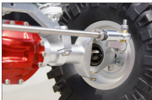
Die Vorderräder werden über spielfreie CVD-Kardanwellen angetrieben, selbstverständlich alles sauber kugelgelagert
