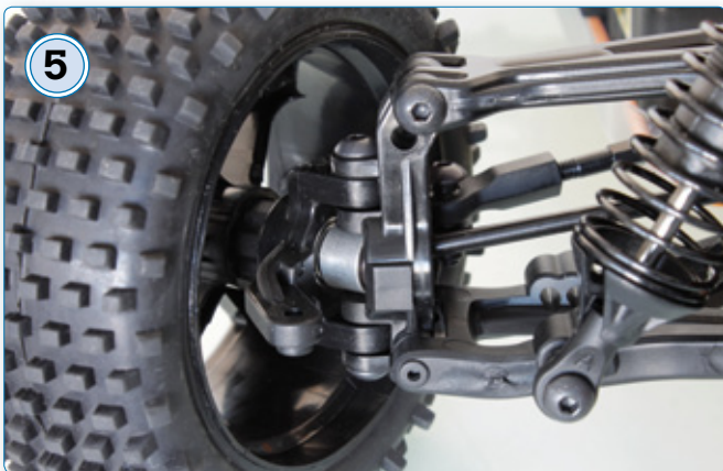
5 Robuste C-Hub-Aufhängungen gibt es an der Vorderachse. CVD-Wellen sind serienmäßig verbaut
