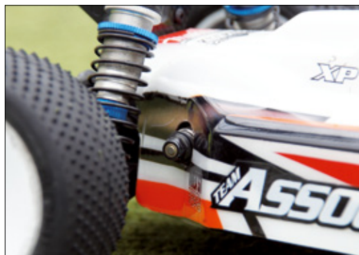
Durch ein kleines Loch in der Karosserie lässt sich der Slipper stufenlos einstellen
