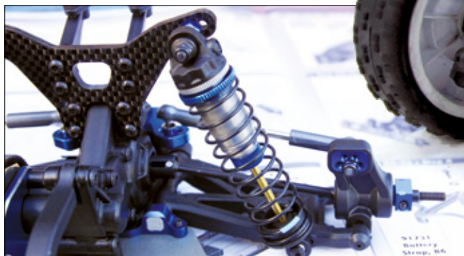
An der Hinterachse kommen 3,5 Millimeter kürzere Dämpfergehäuse zum Einsatz. X-Ringe sorgen für eine gute Abdichtung des Dämpfers
