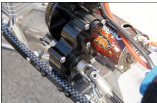
Das Verteilergetriebe aus Stahlzahnradern läuft vor Schmutz geschützt in einer Alukassette
