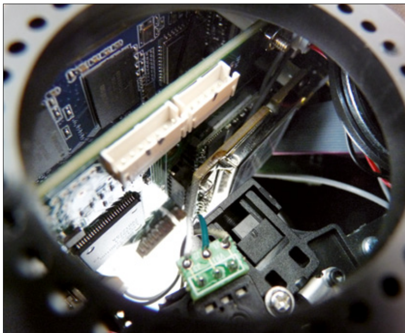
Ein Blick ins Innere zeigt die Stapelbauweise. Angefangen beim RF Sendemodul unter der silbrigen Abdeckung über das Mainboard zur Datenverarbeitung der Senderdaten bis hin zur bläulichen Platine des Android Aufsatzes ist das Innere des Senders recht dicht gepackt
