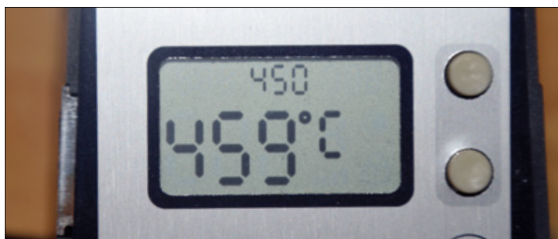
In der obersten Zeile wird die Soll-Temperatur und darunter die Ist-Temperatur angezeigt
