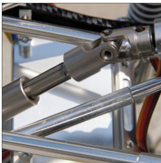
Die massiven Teleskop-Antriebswellen aus Stahl würden so manchem Großmodell Monstertruck gut zu Gesicht stehen
