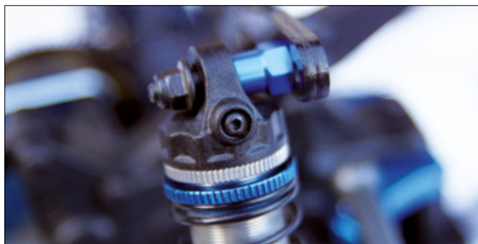
Über kleine M2×4-Millimeter-Schrauben werden die Dämpfer entlüftet. Ein perfektes Einstellen der Dämpfercharakteristik ist somit gewährleistet
