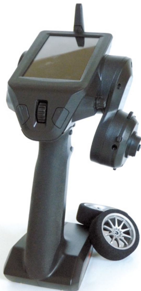
Die Einstellmöglichkeiten lassen auch solche exotischen Verdrehungen des Lenkrads zu, um zum Beispiel mit der rechten Hand auch noch Fotos machen zu können. Die Abstimmbarkeit auf eigene Belange ist bei der DX6R vorbildlich umgesetzt
