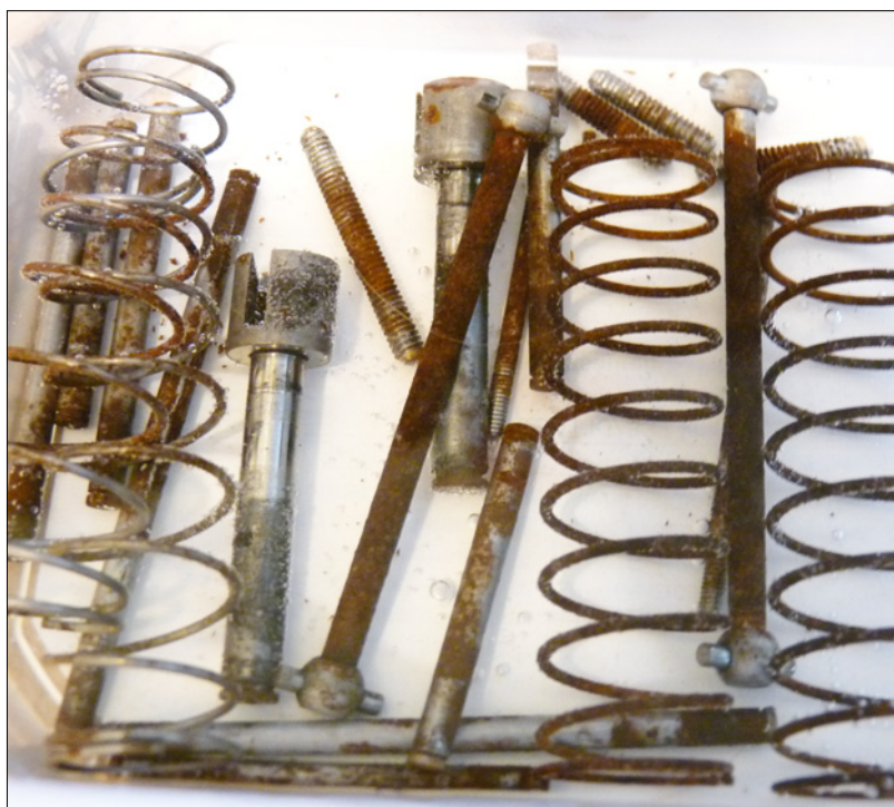
Die Schale sollte der Größe der Teile angepasst werden, damit man nur recht wenig Essig benutzen muss. Es reicht völlig aus, die Teile 3 bis 4 Millimeter unter der Oberfläche zu haben
