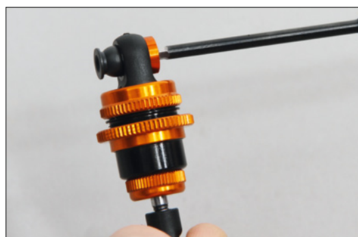
Ein Tip am Rande: Das Einschrauben der Kugelköpfe in die Kunststoffteile des Stoßdämpfers gewährleistet ein reibungsarmes Arbeiten
