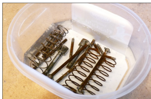
Die Schale sollte der Größe der Teile angepasst werden, damit man nur recht wenig Essig benutzen muss. Es reicht völlig aus, die Teile 3 bis 4 Millimeter unter der Oberfläche zu haben
