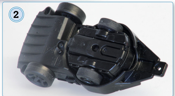
2 Die gesamte Elektronik samt Antrieb steckt in diesem Teil
