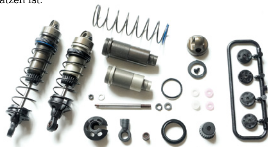
Dank der Entlüftungsöffnung in den serienmäßigen Verschlußkappen aus Aluminium lassen sich die Dämpfer, die nach dem Emulsionsprinzip (ohne Volumenausgleich) funktionieren, prima füllen und einstellen
