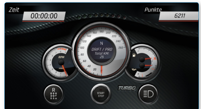
So sieht die App-Oberfläche zum Steuern des Drifters aus. Durch Swipen über den linken Bildschirmbereich dosiert man die Bremskraft, rechts wird Gas gegeben und durch Tippen in der Mitte wird die Handbremse gezogen
