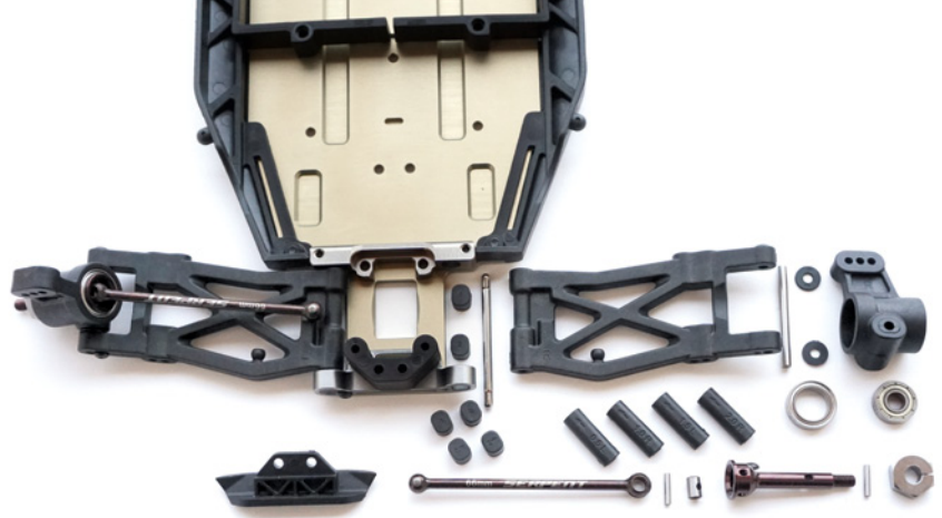
Der Aufbau der Hinterachse, inklusive CVD-Wellen, Aluminiumsechskantmitnehmer und Heckrammer. Das ausgeklügelte Buchsensystem erlaubt zahlreiche Einstellmöglichkeiten
