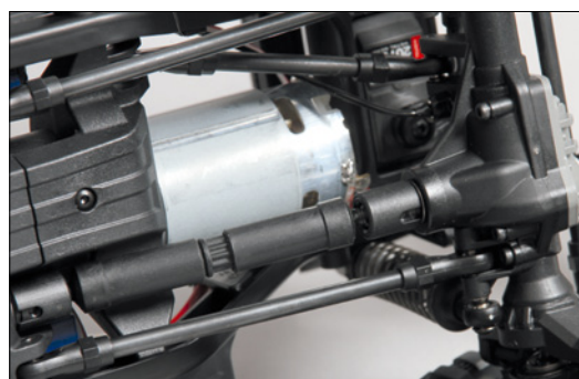
Der Motor sitzt über dem Antriebsschaft der Hinterachse
