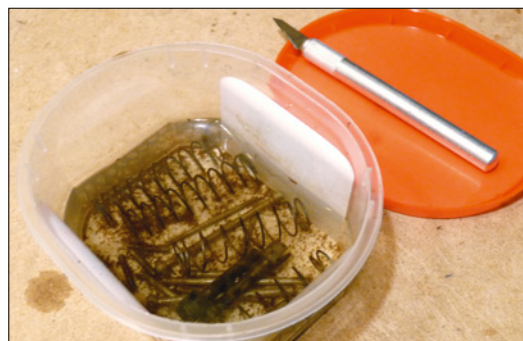
Nach etlichen Stunden kann man zwischendurch den ersten groben Rost mit einem Skalpell abschaben – eine Eisenbürste oder ein entsprechendes Tool für den Dremel gehen natürlich auch. Für noch bessere Ergebnisse sollten die Teile danach wieder in den Essig gelegt werden
