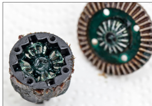
Blick ins Innere des Vierspider-Kegeldifferenzial mit den Stahlkegelrädern
