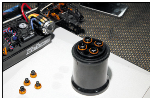
Das Öl in den Stoßdämpfern wird geändert, um durch eine andere Härte das Setup anzupassen
