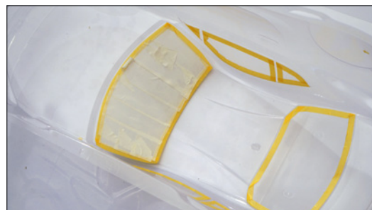
Mit Tamiya-Maskierklebeband und Malerkrepp werden die Fensterscheiben vor dem Lackieren abgeklebt
