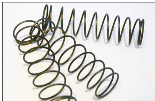
Die Dämpferfedern sehen nach einem zweitägigen Essigbad wieder wie neu aus und funktionieren auch nach wie vor tadellos
