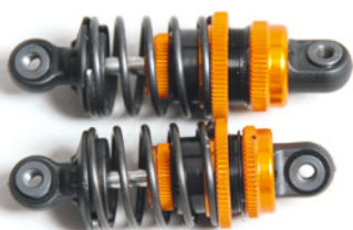
Im direkten Vergleich: der längere Stoßdämpfer des Vorgängers (oben) zum neuen kürzeren des T4'18
