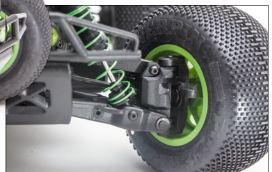
An der Vorderachse wird eine C-Hub-Aufhängung mit massiven Querlenkern eingesetzt
