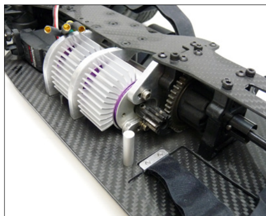
Gut zu erkennen ist der Schutzpfosten, damit ein sich lösender Akku nicht in den Antriebsgeräten geraten kann. Ebenfalls erkennbar ist der selbstverständlich verstellbare Motor um unterschiedliche Untersetzungen fahren zu können
