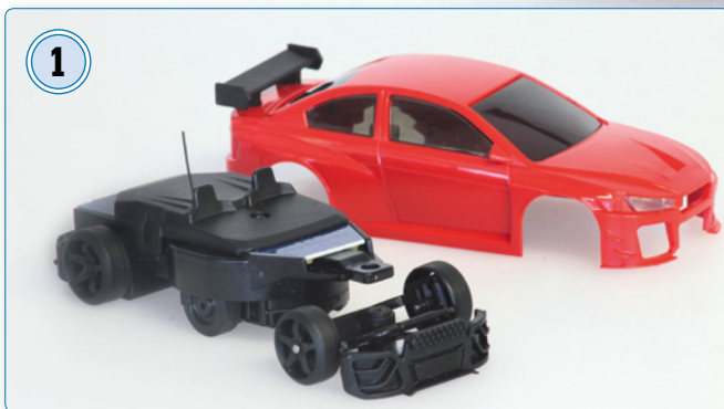
1 Mit drei Schrauben lässt sich die Karosserie abnehmen. Später sollen auch noch andere Fahrzeugdesigns verfügbar sein
