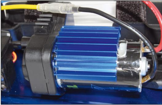
Als Antrieb dient ein konventioneller Bürstenmotor mit 15 Turns
