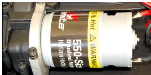
Im Krafraum verfügt der Monstertruck über einen großen 550er-Motor mit erhöhtem Drehmoment. Er basiert zwar auf konventioneller Bürsten-Technik, generiert dafür aber sehr ordentliche Fahrleistungen
