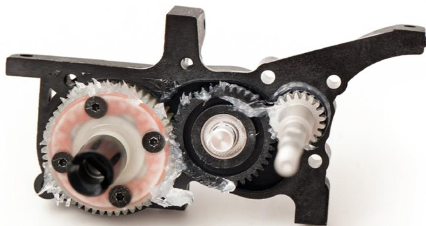
Der Aufbau des Laydown-Getriebes mit der Aluminium-Motorplatte – hier mit dem optionalen Kegeldifferenzial
