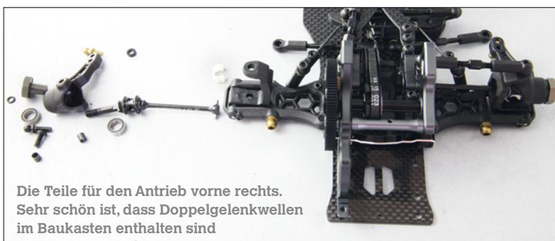
Die Teile für den Antrieb vorne rechts. Sehr schön ist, dass Doppelgelenkwellen im Baukasten enthalten sind
