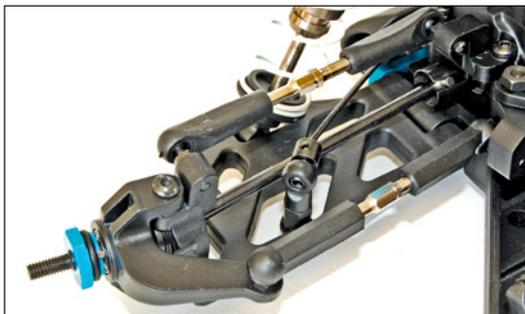
Rechts-Links-Gewindestangen, Stabilisatoren und Radmitnehmer aus Aluminium sind Teil der gehobenen Ausstattungslinie
