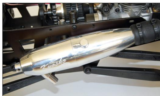
Um die maximale Motorleistung zu generieren, werden die Abgase durch ein Resonanzrohr abgeleitet
