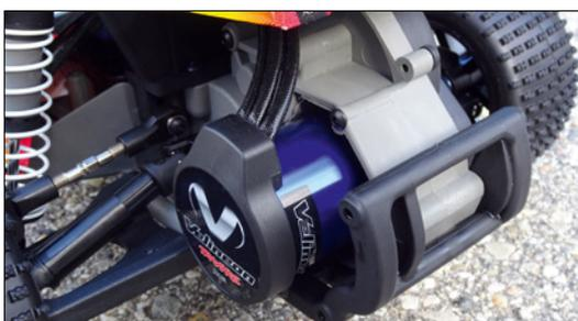
Der Velineon-Brushlessmotor ist samt Getriebe, Rutschkupplung und Regler einsatzbereit im Heck des Modells montiert und hält extremste Leistungsreserven bereit
