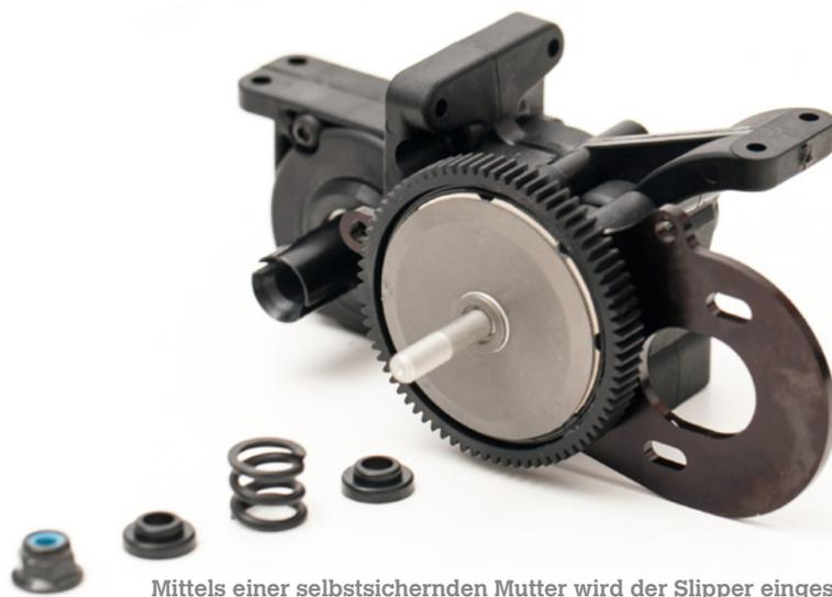
Mittels einer selbstsichernden Mutter wird der Slipper eingestellt
