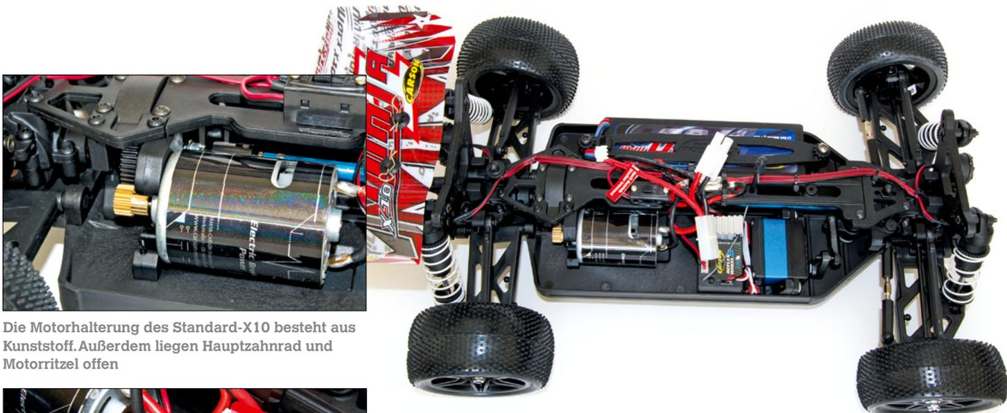
Die Motorhalterung des Standard-X10 besteht aus Kunststoff. Außerdem liegen Hauptzahnrad und Motorritzel offen
