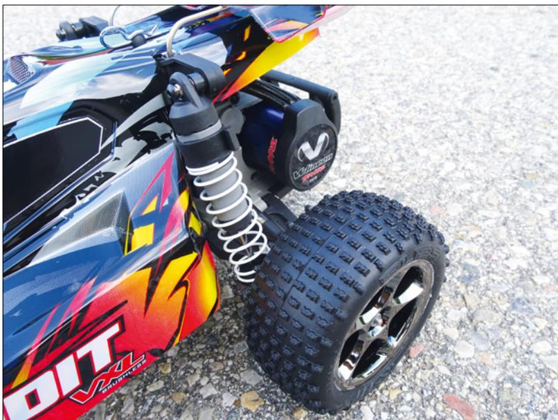
Die vier ab Werk eingebauten Öldruckstoßdämpfer sorgen nicht nur auf hartem Untergrund für eine hervorragende Federung des Modells
