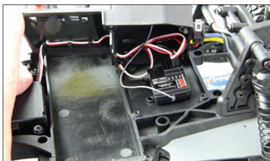
Der Chassisdeckel ist Teil des Akkuschachts und schützt den Empfänger vor Wasser und Dreck
