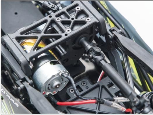
Die Teleskopwellen lassen sich auch separat lösen, ohne weitere Teile im Fahrzeug auszubauen zu müssen
