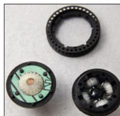
Das gefüllte Kegelraddifferenzial, bevor der Deckel montiert wird
