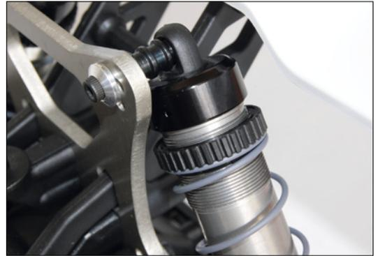
Mittels Rändelschrauben auf den Stoßdämpfergehäusen lässt sich die Bodenfreiheit stufenlos justieren
