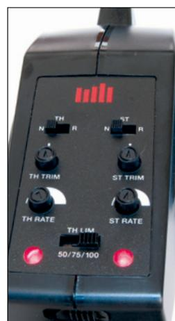
Neben den gängigen Schaltern und Knöpfen eines RTR-Handsenders bietet die STX2 zusätzliche die Möglichkeit, die Gasfunktion von 100 auf 75 oder gar 50 Prozent zu reduzieren. Ein sinnvolles Feature, wenn vollkommen ungeübte Piloten ans Steuer kommen
