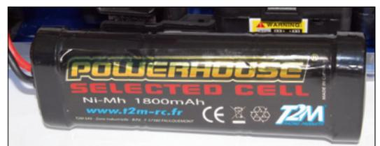
Der sechszellige Antriebsakku in NiMH-Bauweise und einer Kapazität von 1.800 Milliamperestunden ist nicht mehr als eine Dreingabe für die ersten Fahrten, bevor man ihn gegen ein vollwertiges Pendant ersetzt. Positiv ist allerdings zu erwähnen, dass als Verbindungssystem T- oder Deans-Stecker verwendet wurden
