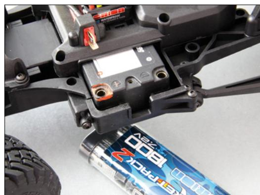
Der LiPo-Akku ist montiert, jetzt fehlt noch der Adapter für den Anschluss zum Regler
