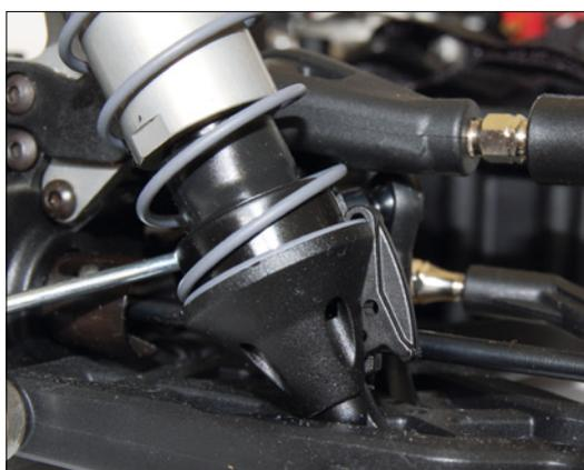
Klein, aber fein: Zusätzliche Krallen an den Federtellern sollen verhindern, dass die Fahrwerksfedern abrutschen
