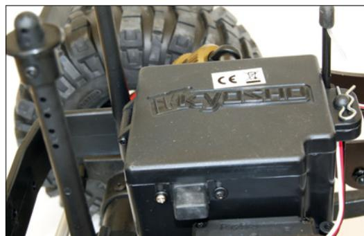
Um sie vor Schmutz und Feuchtigkeit zu schützen, wurden der 2,4-Gigahertz-Empfänger sowie der dazugehörige Akku in einer eigenen Box untergebracht
