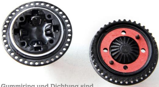
Gummiring und Dichtung sind eingesetzt, jetzt kann das Kegeldifferenzial verschraubt werden
