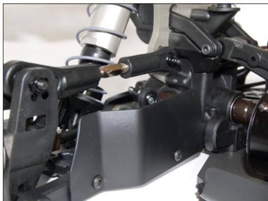
Damit aufgewirbelter Schmutz und Schlamm nicht ungehindert zu den hinteren Stoßdämpfern vordringen, verfügt der Hyper über sogenannte Mud Flaps zum Schutz
