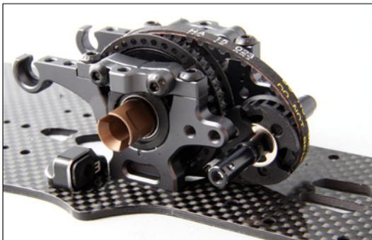
Kegelraddifferenzial, Getriebegehäuse, Riemen und Antriebswelle sind vormontiert
