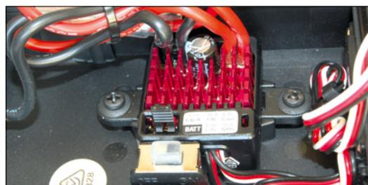
Der Fahrregler mit seinen Setup-Jumpfern bietet ein etwas angestaubtes Flair. Allerdings funktioniert er einwandfrei, bietet saubere Reaktionen auf Gas und Bremse und zeigte während der Tests keinerlei Anzeichen von Überhitzung
