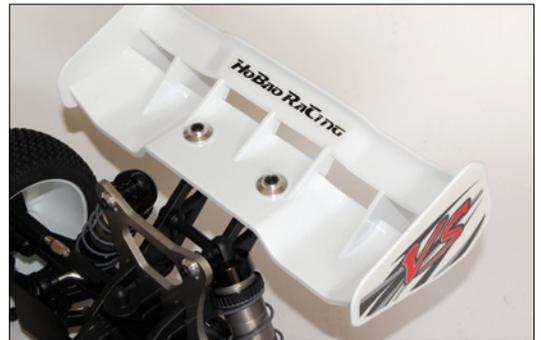
Per großem Heckflügel wird zusätzlich zum mechanischen auch noch aerodynamischer Anpressdruck auf die Hinterachse generiert
