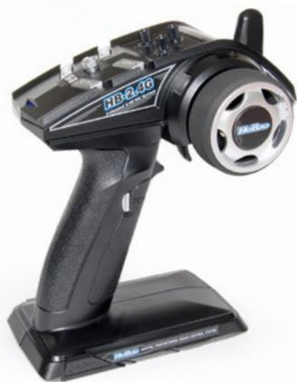
Wie es sich für ein modernes RC-Car gehört, moduliert die RC-Anlage im modernen 2,4-Gigahertz-Frequenzband, in dem Kanalüberschneidungen praktisch ausgeschlossen sind
