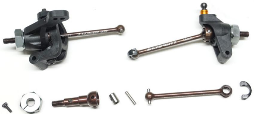
Der S411 4.1 ist rundum mit CVD-Kardans einschließlich Blades und Alu-Radaufnahmen ausgestattet
