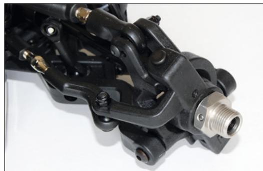
Die Lenkung weist eine robuste C-Hub-Konstruktion auf, die zusammen mit der Pivotball-Technik eine von insgesamt zwei gängigen Lenkungsbauweisen darstellt
