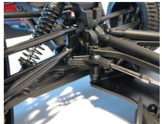
**Die Einzelradaufhängung ist mit starren Querlenkern und Spurstangen ausgerüstet**
