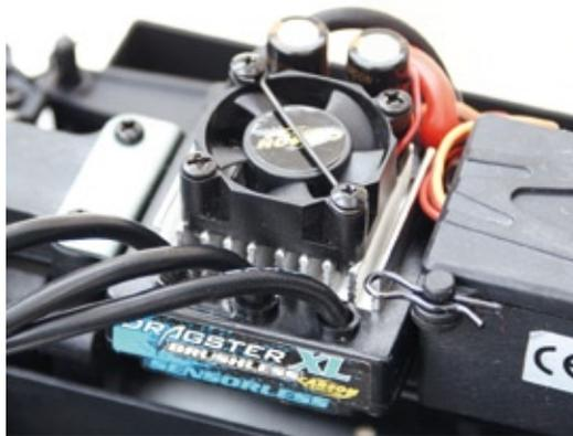
**Ein echter Kraftprotz sitzt oben auf der Radioplatte. Bei 11,1 Volt setzt der schwarze Regler 600 Watt um. Wie viel das ist, demonstriert dann der Motor mit voller Gewalt**
