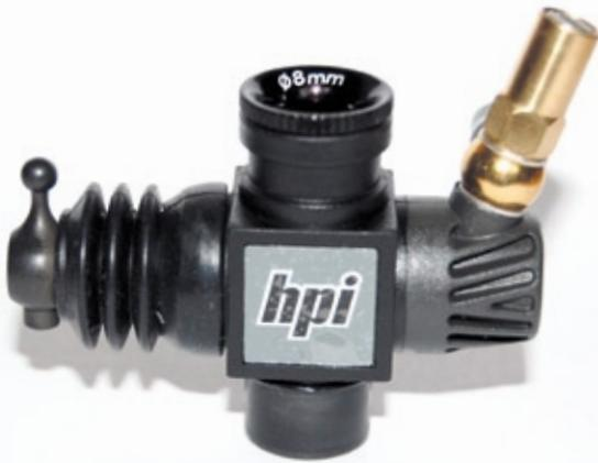
**Komposit-Vergaser und Wechsel-Venturis sind nur einige der Kennzeichen eines echten Renntriebwerks**
