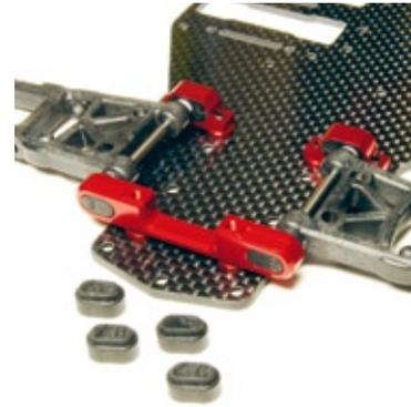
**Dank des Buchsen-systems sind den Einstellmöglichkeiten für die Spur fast keine Grenzen gesetzt. Das Rollzentrum wird standardmäßig durch Unterlegscheiben bestimmt**
