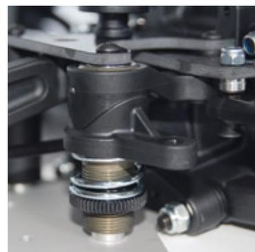
Bei harten Schlägen schützt der einstellbare Servosaver die Lenkmechanik und das Servo
