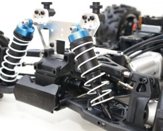
Bei so viel Leistung muss die Aufhängung deutlich mehr aushalten als bei kleineren Cars. Die Dämpfer fassen dadurch etwa doppelt so viel Öl wie gewöhnlich. Auch alle anderen Teile sind auf 1:8er-Verbrenner-Niveau
