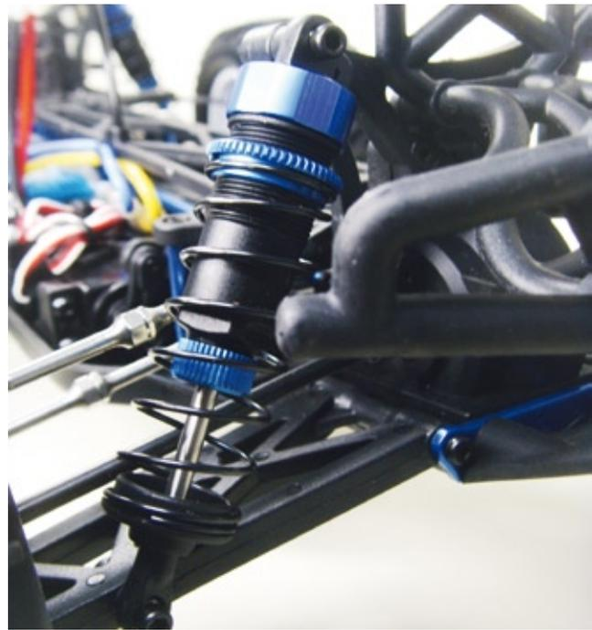
Die Big Bore-Dämpfer haben Feingewinde zur Einstellung der Bodenfreiheit
