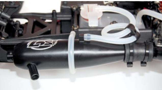
Das Resonanzrohr aus Aluminium optimiert die Leistungsabgabe des NT-Triebwerks
