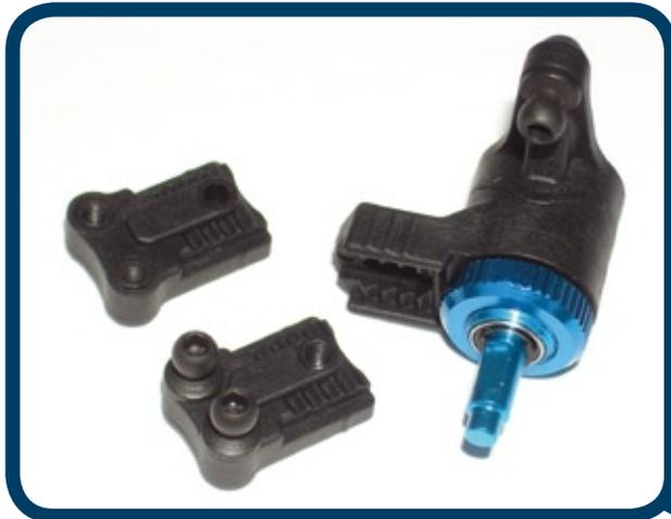
An der Lenkzentrale setzt man auf einen zentralen Umlenkhebel. Über eine crashsichere Verzahnung kann die Länge des Lenkhebels, über eine interne Feder die Wirkung des integrierten Servosavers und über ein separates Lenkteil der Ackermanneffekt beeinflusst werden
