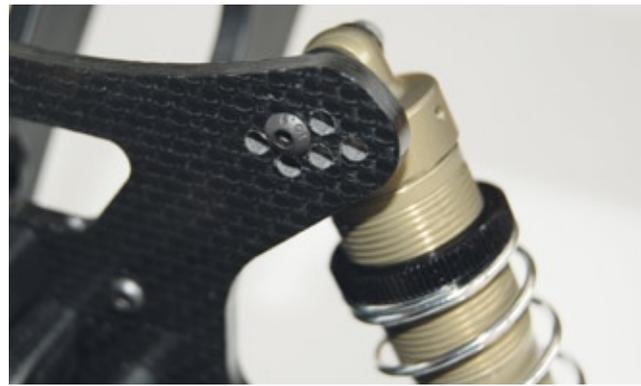
Dämpferbrücken aus Carbon senken das Gesamtgewicht und bieten diverse Aufnahmepunkte für die Stoßdämpfer. Wie bei allen anderen Karbonteilen auch, sind ihre Kanten mit Sekundenkleber zu versiegeln
