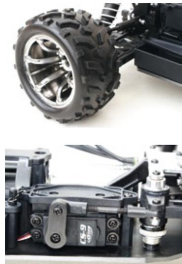
Liegend leitet das Servo seine Kraft an den Servosaver. Die Rändelmutter regelt die Federvorspannung. Nur die Kunststoffbefestigung ist nicht besonders steif geraten
