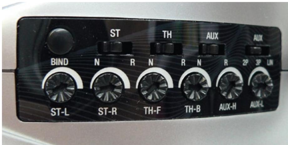
Neben dem üblichen Taster für den Kopplungsvorgang sind alle Einstellelemente zentral auf der Oberseite angeordnet, dies ermöglicht mit etwas Übung sogar die Verstellung sämtlicher Parameter beim Fahren
