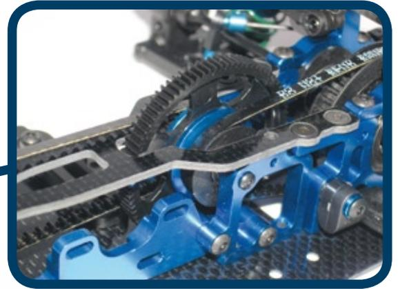
Bewährt: auch der TC6 setzt auf den üblichen Zwei-Riemen-Antrieb über ein im hinteren Chassisbereich angesiedeltes Hauptzahnrad. Stabile Aluminiumaufnahmen führen hierbei die für einen guten Leichtlauf notwendigen großen Riemenräder
