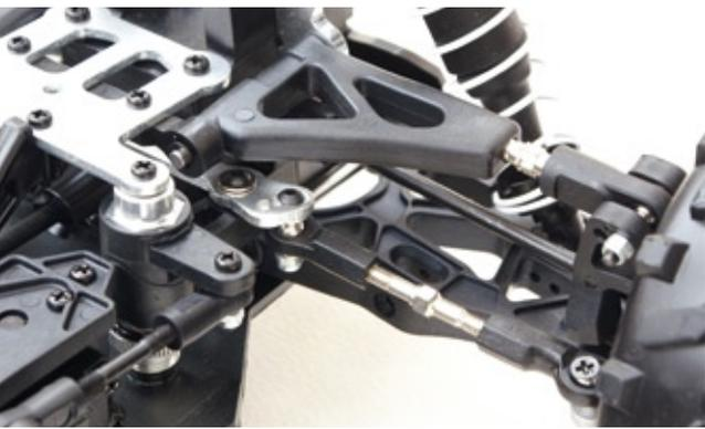
Vom Ackermanneffekt bis hin zu sämtlichen Längen der Anlenkung kann man alles komfortabel über Rechts-links-Gewinde verstellen
