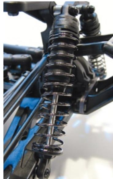
**Ausreichend dimensionierte Öldruckstoßdämpfer aus Kunststoff ermöglichen lange Federwege**
