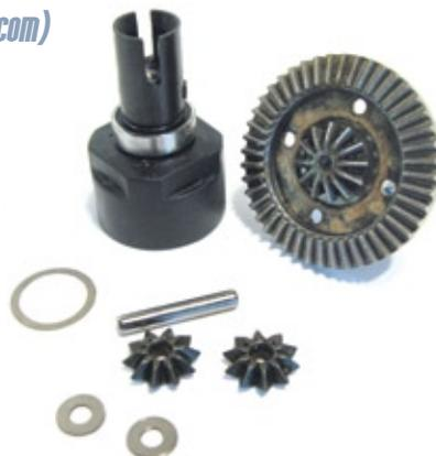
**Zweispider-Differenziale aus Metall und ein komplett kugelgelagerter Antriebsstrang sorgen für Langlebigkeit**
