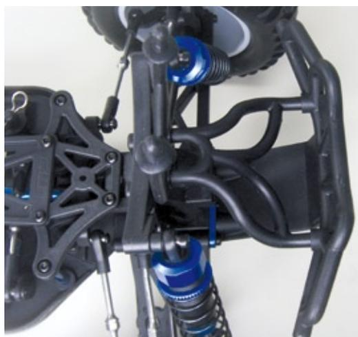
**Vorne und hinten schützen Rammer aus schlagfestem Kunststoff die Achsen**
