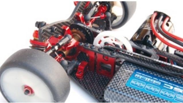
**Das direkt vom Motor angetriebene Hauptzahnrad verteilt die Kraft über zwei Riemen auf Vorder- und Hinterachse**
