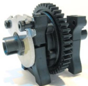
Die starre Antriebseinheit mit Bremssystem sieht aus wie ein normales Mitteldifferenzial, jedoch handelt es sich um einen starren Durchtrieb
