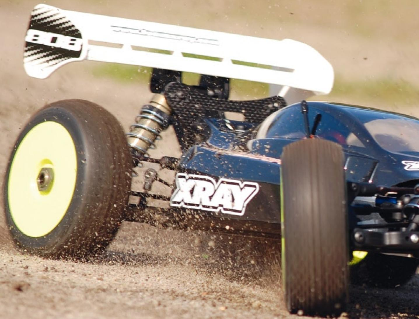
Eigentlich sind es nur drei unscheinbare Buchstaben, deren Bedeutung aktuell den Markt im RC-Car-Sport förmlich revolutioniert: ORE. Hinter der Abkürzung stehen Buggys im Maßstab 1:8, die entgegen der jahrzehntealten Tradition allerdings nicht mehr über Verbrenner-, sondern über bürstenlose Elektroantriebe verfügen. Und wo ein Boom ist, darf ein Hersteller natürlich nicht fehlen: XRAY.
