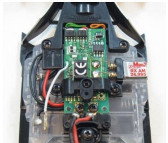
Die zentrale Elektronik beinhaltet Empfänger und Regler. Außerdem steuert sie das Micro-Servo an
