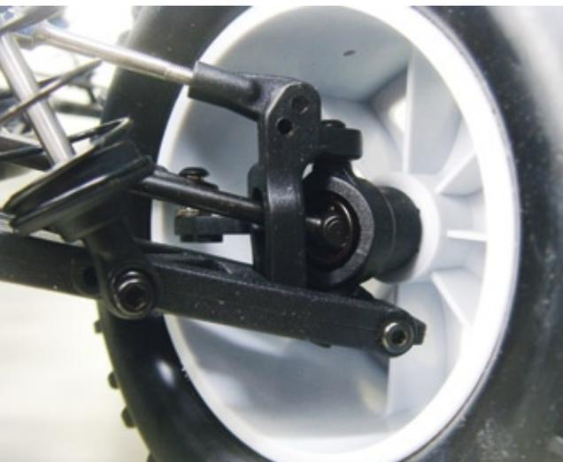
**Vorbildlich: CVD-Wellen an der Vorderachse. An der Hinterachse kommen ausreichende Knochenwellen zum Einsatz**
