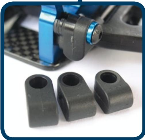
Die Querlenker werden direkt an den Bulkheads fixiert. Über vier unterschiedliche Montageblöcke können Rollcenter und Kick-Up beziehungsweise Kick-Down justiert werden. Durch zwischengelegte Plastikklipse lassen sich Spurweite und Vorspur variieren
