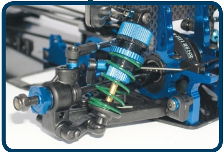
Auch die Hinterachse ist in aktueller Tourenwagen-Manier konstruiert. Interessanterweise verwendet Team Associated an Vorder- und Hinterachse die gleichen Bulkheads
