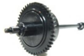
Ein Kegelrad-Differenzial sorgt für eine gleichmäßige Kraftverteilung an der Hinterachse
