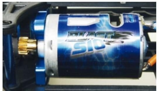
Der Blast 10-Motor sitzt in einer soliden Alu-Halterung
