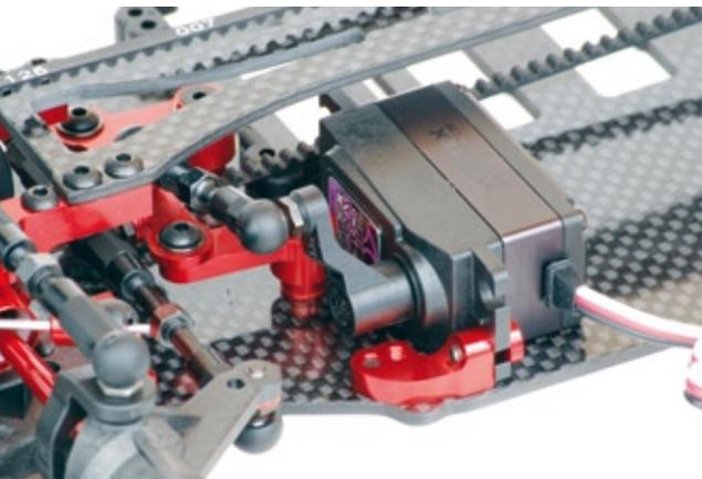
Der extravagante Servohalter ermöglicht die Montage unterschiedlicher Servotypen. Die Doppelarmlenkung verfügt leider über keinen Servosaver
