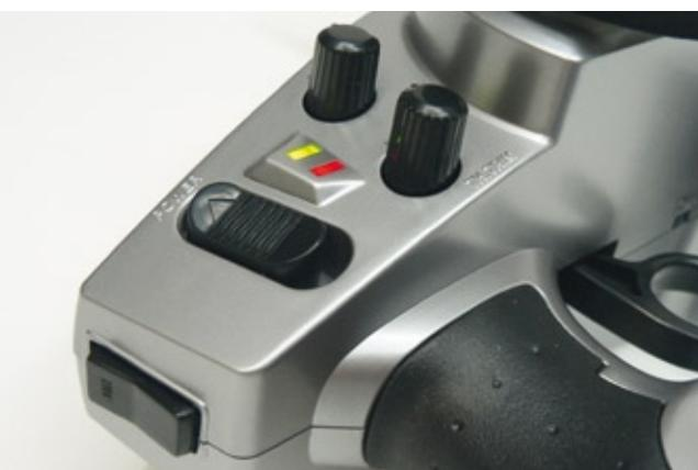
Mit dem Daumen kann sowohl der Sender ein- und ausgeschaltet als auch die Trimmung für Gas und Lenkung verstellt werden. Einzig der Schalter für den dritten Kanal ist umständlich zu erreichen, eine Platzierung unterhalb des Lenkrads wäre besser gewesen
