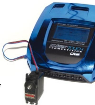
Der Pulsar Touch verfügt auch über eine Option zur schnellen Überprüfung von Servos
