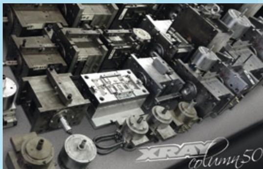
Hier sieht man einen Teil der benötigten Spritzgussformen. Jede einzelne benötigt mehrere Tage zur Fertigstellung; dafür ist höchste Qualität garantiert
