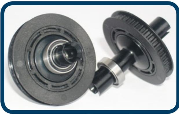
Angesichts der angesagten Brushless- und LiPo-Power setzt man im TC6 auf die Kombination von Kugeldiff an der Hinterachse und Slipper-Starrachse an der Vorderachse. Große Riemenräder sorgen dafür, dass gerade bei scharfen Modified-Aggregaten immer genügend Zahnriemenzähne eingreifen können
