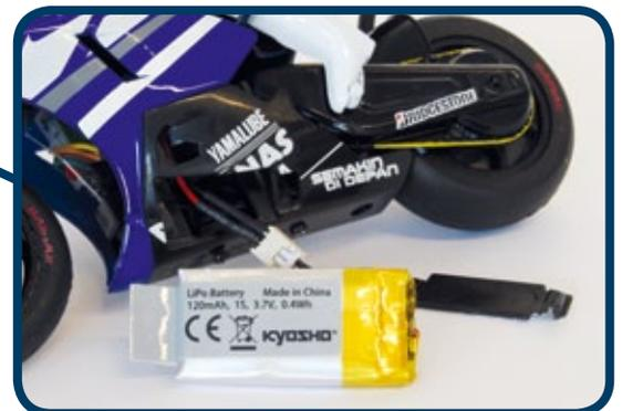
Der 1s-LiPo hat eine Kapazität von 120 Milliamperestunden und wird seitlich über eine Klappe in der Verkleidung versenkt
