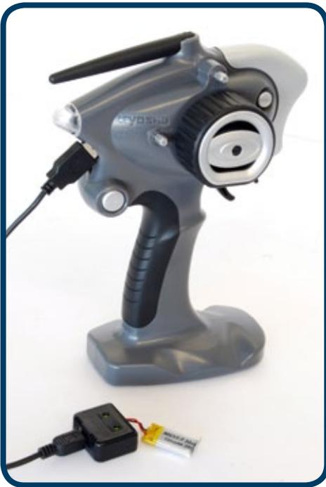
Über den beiliegenden Sender, der im 2,4-Gigahertz-Band arbeitet, lässt sich die Drehzahl des Kreiselsystems im Hinterrad des Bikes stufenlos einstellen. Das Ladegerät kann man entweder über den integrierten USB-Anschluss an der Fernsteuerung oder an einem Computer betreiben
