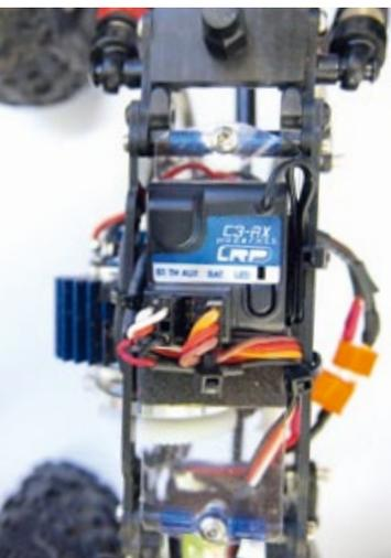
Eine leichte Radioplatte trägt den 2,4-Gigahertz-Empfänger
