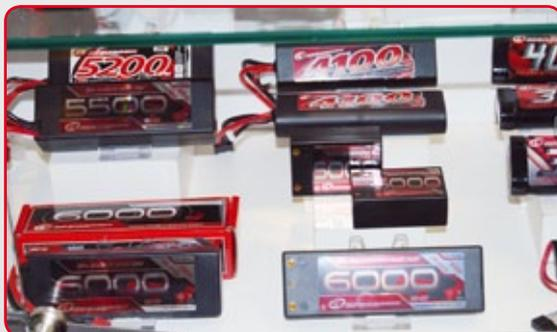
Speziell für 1:8er-Modelle gibt es von **Robitronic** LiPos im Hardcase. Die Stromspender haben Kapazitäten von 5.500 bis 6.000 Milliamperestunden und Spannungen von 7,4 bis 11,1 Volt. Die Belastbarkeiten liegen bei 50, 60 oder 70C, je nach Typ. Neben standardmäßigen Stickpacks gibt es auch dickere 3s-Packs oder Saddlepacks. Während die Sticks mit Kabeln samt Deans-Stecker versehen sind, haben die Saddlepacks 4-Millimeter-Goldkontaktbuchsen.
