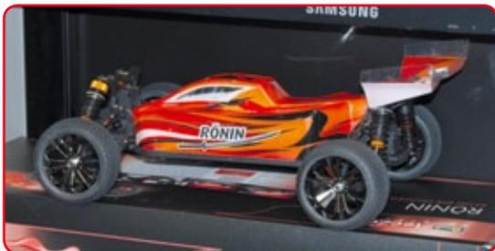
Ganz neu im RC-Car-Segment ist die aus dem Standmodellbau bekannte Firma **Revell**. Auf der Spielwarenmesse präsentierte das Unternehmen einen 1:10er-Buggy in zwei Ausführungen. Sowohl der Ronin mit Bürstenmotor als auch der Ronin Pro mit Brushlessmotor werden fahrfertig mit 2,4-Gigahertz-Fernsteuerung ausgeliefert. Die Modelle sind mit Allradantrieb ausgestattet und verfügen über eine komplette Kugellagerung. Zum Fahren werden noch Senderbatterien und ein 2s-LiPo-Akku benötigt.
