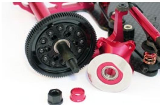
Der Rebel 10 setzt auf ein einstellbares Kugeldifferenzial an der angetriebenen Hinterachse
