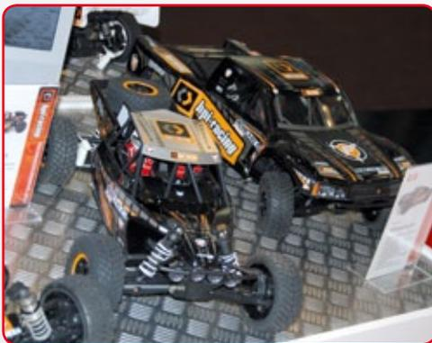
Eine Nummer kleiner, aber nicht unbedingt langsamer präsentierte **HPI** einen Short Course- und einen Wüsten-Buggy mit Flux-Antrieb. Sowohl der Apache C1 (Wüsten-Buggy) als auch der Apache SC (Short Course-Truck) basieren auf dem gleichen Chassis im Maßstab 1:8. Sie werden fahrfertig mit einer modernen 2,4-Gigahertz-Anlage ausgeliefert.
