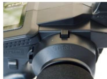
Beide Fernsteueranlagen sind mit digitalen Trimmungen für den ersten und zweiten Kanal ausgestattet. Hier im Bild die Syncro KT-201
