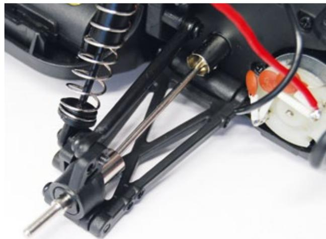
Die Motorkraft wird über solide Knochenwellen an die Radachsen und damit die Räder mit dem grobstolligen Profil weitergeleitet
