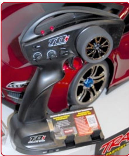
Nachdem es bereits einige wenige Hersteller vorgemacht haben, präsentiert nun auch **Traxxas** mit der TQi eine 2,4-Gigahertz-Fernsteuerung, die Telemetrie-fähig ist. Der Sender wirkt auf den ersten Blick sehr simpel. Das Besondere an der Anlage ist jedoch die Docking-Station für ein iPhone oder einen iPod Touch. Darüber können die Telemetriedaten abgelesen werden.
