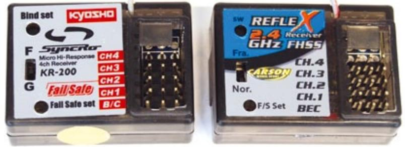
Die beiden Vierkanälempfänger, KR-200 (links) und Reflex (rechts), sind baugleich. Beide verfügen über eine Failsafe-Funktion sowie einen Umschalter für den Funkbetrieb in Frankreich. Das Gewicht beträgt jeweils 10 Gramm
