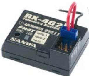
Der neue RX-462 Vierkanalempfänger von Sanwa im Vertrieb von LRP electronic ist telemetriefähig und wurde speziell für die Sanwa MT-4-Fernsteuerung entwickelt. Mit dem 2,4-Gigahertz-Receiver kann
