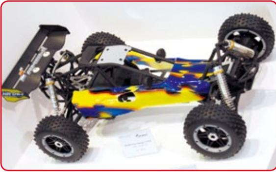
Im Maßstab 1:8 präsentierte **Amewi** ein Elektromodell im Wüstenbuggy-Design. Der NR 8BE wird als fahrerfertiges Modell mit vielen Aluminium-Teilen ausgeliefert. Zur Ausstattung gehört auch eine 2,4-Gigahertz-Fernsteueranlage. Den Vortrieb übernimmt ein Brushlessmotor mit 150-Ampere-Regler. Für die Stromversorgung sind noch zwei 2s-LiPos erforderlich.
