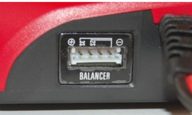
Am EHR-Balancerport lassen sich LiPos bis 3s-Konfiguration anschließen
