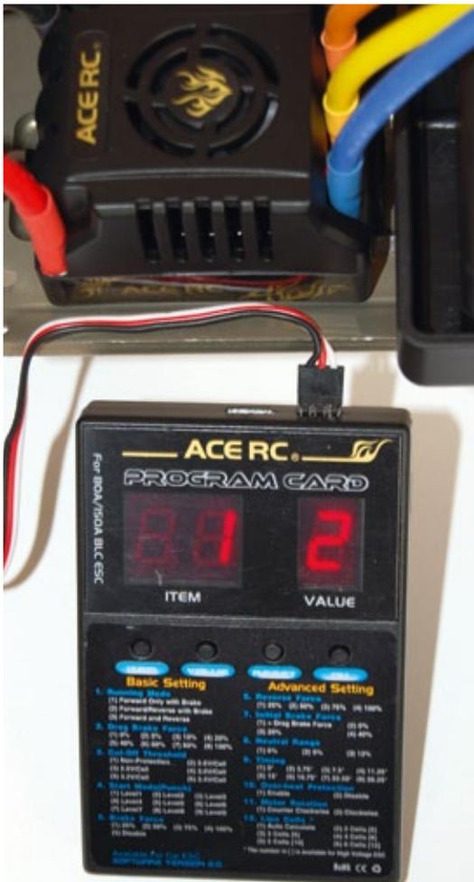
Mit einer Programmierkarte lassen sich Setup-Eingriffe am Antrieb leicht bewerkstelligen
