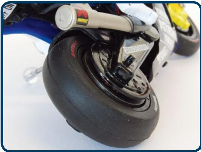
Im Hinterrad ist ein Kreiselssystem versteckt, das mit 7.000 Umdrehungen pro Minute und Volt dreht. Es verleiht dem Motorrad seine Stabilität beim Fahren
