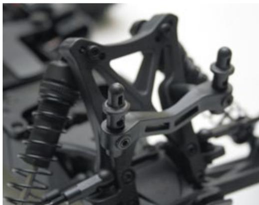
**Dämpferbrücken und Karosseriestützen bestehen aus zähem Kunststoff**
