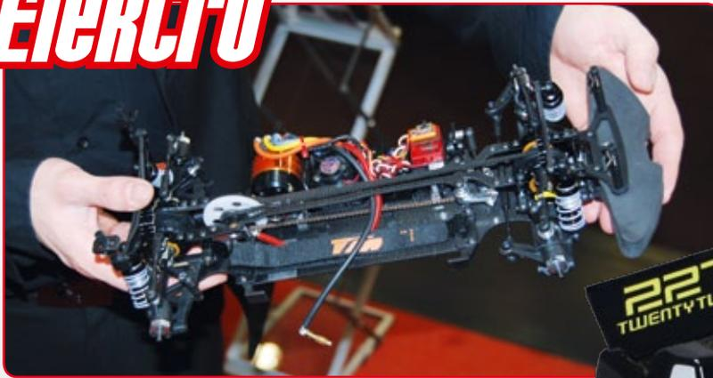
Auch dieses Jahr erlebten die Elektromodelle wieder einen Aufschwung. Am Stand von **HRC Distribution** beispielsweise, gab es neue Team Magic-Modelle zu sehen. Der E4 RS II ist ein Onroadler im Maßstab 1:10. Das Wettbewerbsmodell wird als Kit ohne Komponenten geliefert. Der permanente Allradantrieb ist über einen Zahnriemen sichergestellt.
