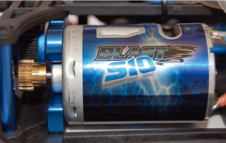
RTR-Modelle des unteren Preissegments werden meist mit Bürstenmotoren angetrieben. Für den Anfang sind diese ganz okay, aber der Wunsch nach mehr Power wird sich recht bald einstellen
