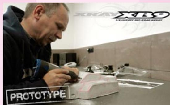
**Hier kann man gut die ersten Versuche an einer Urform erkennen. Bis alles so glatt und optimal für einen ersten Tiefziehversuch ist, vergehen mitunter Tage**
