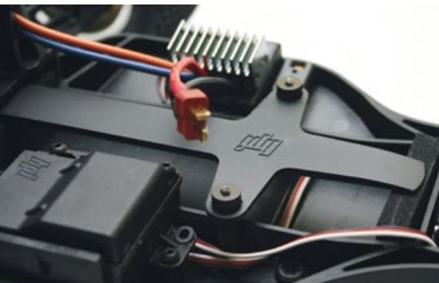
**Für die Akkuhalterung werden keine Klipse mehr benötigt**
