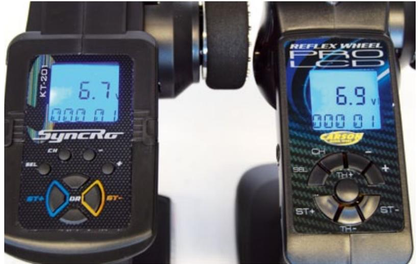
Die blau hinterleuchteten Displays beider Anlagen sind angenehm groß und auch bei direkter Sonneneinstrahlung noch gut ablesbar. Zur Menüsteuerung kommt die KT-201 (links) mit sechs Bedienknöpfen aus, die Reflex Wheel hat acht
