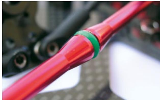
Zwischen den beiden Strebenhälften der Vorderachsblocke sitzt ein zusätzlicher O-Ring, der den Chassisflex im Bereich der Vorderachse ermöglicht
