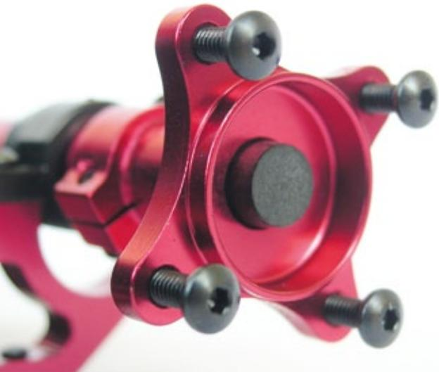
**Trotz gewichtsoptimierter Klemmung mittels M2,5-Schrauben fand der linke Hinterradmitnehmer ausreichend Grip auf der Kohlefaserhinterachse**
