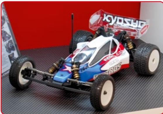
Der Ultima RB-5 SP2 WC Edition von **Kyosho** ist im Maßstab 1:10 gefertigt. Der 2WD-Buggy hat Heckantrieb und wird als Kit ausgeliefert. Durch neu designte, 2 Millimeter längere vordere Querlenker hat man beim Fahren eine bessere Kontrolle auf hartem Terrain. Darüber hinaus wurden die Achsschenkel und die Karosserie optimiert. Der Motor überträgt seine Kraft auf ein dreistufiges Getriebe mit Kugeldifferenzial. Das Modell ist 380 Millimeter lang, wiegt 1.620 Gramm und kostet 299,- Euro.
