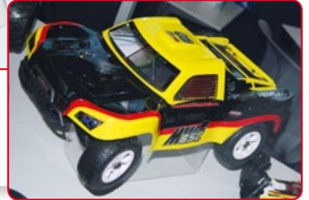
Ebenfalls neu bei **Krick** ist der Mega E 8SC, ein Short Course-Truck im Maßstab 1:8 mit Brushlessantrieb. Auch dieses Modell wird fahrfertig mit 2,4-Gigahertz-Anlage verkauft und der Antrieb ist für bis zu 4s-LiPos ausgelegt. Ein Akku gehört jedoch nicht zum Lieferumfang. Das 553 Millimeter lange Modell wiegt fahrfertig 3.350 Gramm und die drehenden Teile sind kugelgelagert.
