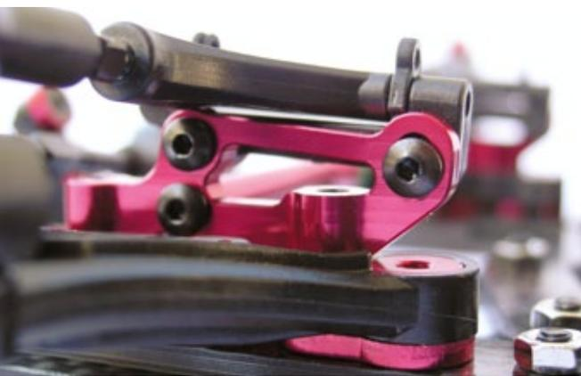
Die oberen Querlenkerhalter sind in drei Positionen von 0, 5 und 10 Grad montierbar, wodurch sich beim Einfedern der Nachlaufwinkel und damit auch die Lenkungsaggressivität verändert
