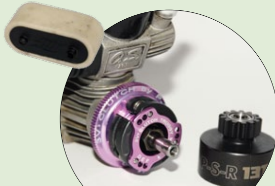
Nicht nur der Austausch eines Verschleißteils, sondern auch die Optimierung des Setups ist Aufgabe der PSR 3V 2 . Sie bietet diverse Möglichkeiten der Feinabstimmung inklusive passender Kupplungsglocken
