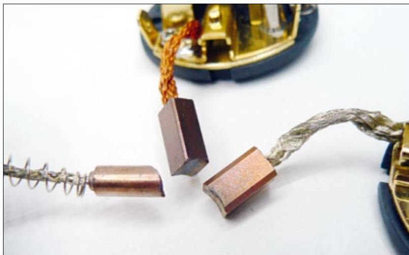
Verschiedene Motorkohlen: ganz links die runde Version aus den neuesten Motoren, in der Mitte die Standardversion für fast alle Motoren und rechts eine Laydown-Version mit liegend angeordneter Motorkohle für den Einsatz bei hohen Strömen
