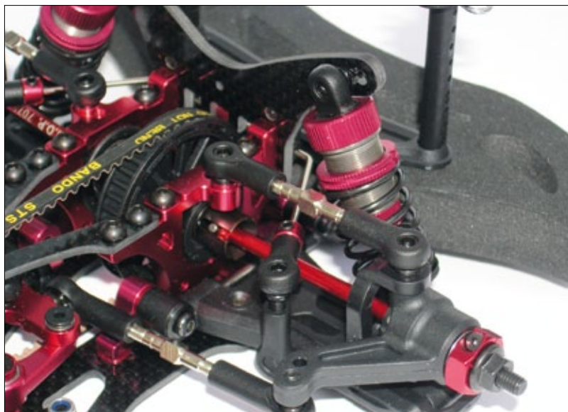
Die Vorderachse glänzt mit vielfältigen Einstellmöglichkeiten. Anstatt auf Experimente setzt TOP auf die klassische C-Hub-Machart
