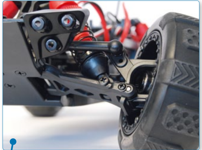
Bewährte Offroad-Technik mit Doppelquerlenkern und C-Hub-Aufhängungen. Einstellungen kann man hier jedoch nicht vornehmen
