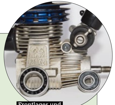
Frontlager und Hauptlager mit Stahl- oder Keramikugeln sorgen für optimalen Rundlauf der Kurbelwelle
