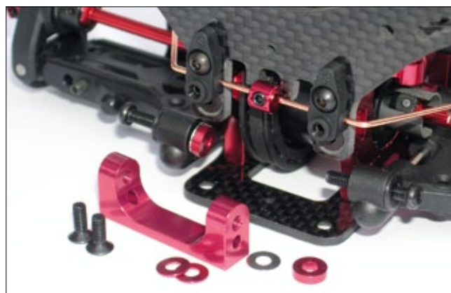
Die Schwingen werden nicht mehr an den Antriebsbulkhheads, sondern an separaten Aluteilen auf dem Chassis montiert. Zwei Aufnahmemöglichkeiten für die Schwingenstifthalter oder einfaches Unterlegen mit Beilagscheiben verändern das Rollcenter und damit auch das gewünschte Fahrverhalten
