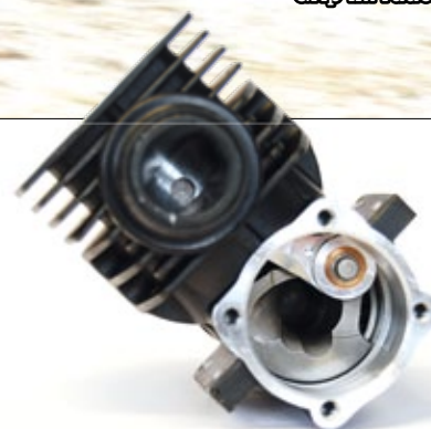
Die speziell geformte Kurbelwelle benünstigt die Gemischführung
