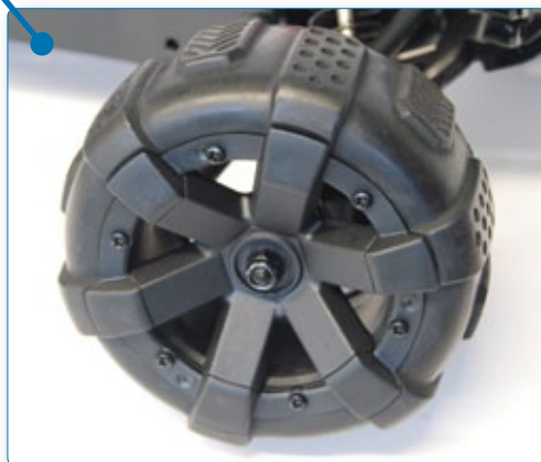
Klar, die Optik polarisiert. Technisch handelt es sich bei den Beadlock-Felgen mit Gummireifen jedoch um einwandfreie Lösungen
