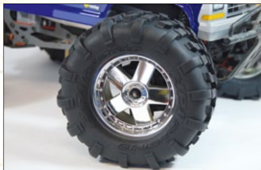
Die fertig verklebten Kompleträder im GT-Stil haben eine weiche Gummimischung für guten Grip im rauen Gelände
