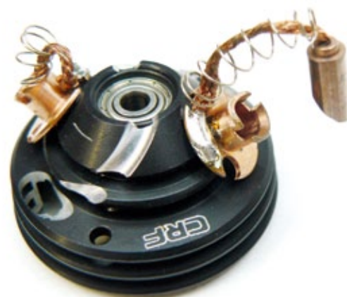
Der letzte Entwicklungsstand bei den Bürstenmotoren nutzt im 45 Grad Winkel gelagerte, runde Motorkohlen für extreme Leistung. Der Vorteil des komplett aus Aluminium gefrästen Motorkopfes liegt in der sehr guten Wärmeabfuhr und einem vergleichsweise stark geschlossenen Gehäuse für den Offroad-Einsatz
