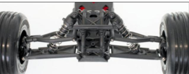
Die Vorderachse des Vorteks ist, typisch für ein 2WD-Modell, einfach und wartungsfreundlich konstruiert. Schwächen zeigen sich bei der Einstellung des Setups
