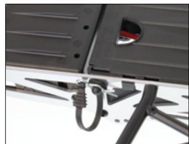
Der Antriebsakku wird ARRMA-typisch über die Chassis-Unterseite ins Modell eingeschoben. Ein Sicherungsstift arretiert die Abdeckklappe
