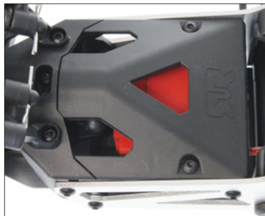
Das liegend verbaute Lenkservo des Typs ADS-7 hat eine Stellkraft von 7 Kilogramm pro Zentimeter. Die Stellzeit liegt bei 0,12 Sekunden beim Betrieb an 6 Volt. Das Getriebe wird von einem Slipper vor Leistungsspitzen geschützt
