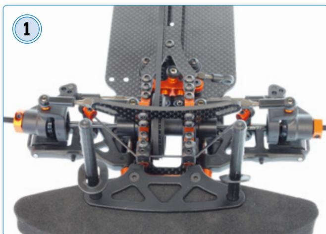
1 In der mit Stabilisatoren versehenen Vorderachse ist eine ein starrer Durchtrieb verbaut. Natürlich ist das Setup komplett stufenlos einstellbar
