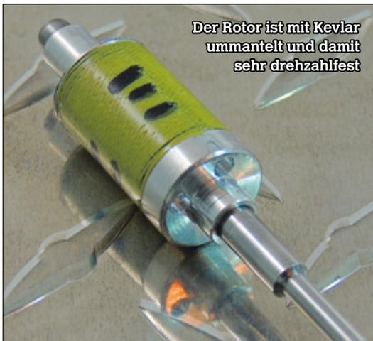
Der Rotor ist mit Kevlar ummantelt und damit sehr drehzahlfest
