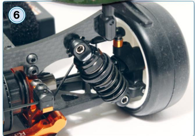
Die Öldruckstoßdämpfer des TC10 können stufenlos über Rändelschrauben eingestellt werden. Darüber hinaus wartet das Chassis mit vielen Befestigungspunkten auf
