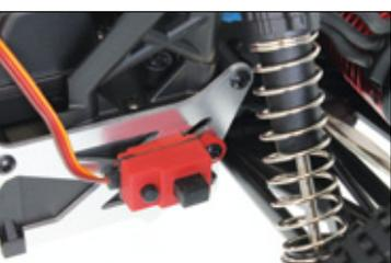
Programmiert wird der BLX-Controller mittels One-Button-Setup. Der entsprechende Taster ist gut erreichbar am Ein-aus-Schalter platziert
