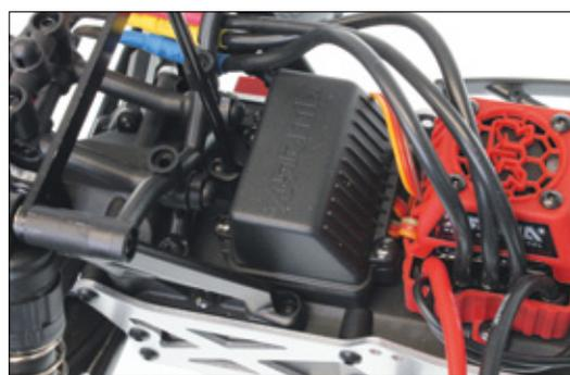
Der Regler ist für den Betrieb an bis zu 3s-LiPo-Akkus ausgelegt. Er ist ab Werk mit Motor und Receiver verbunden
