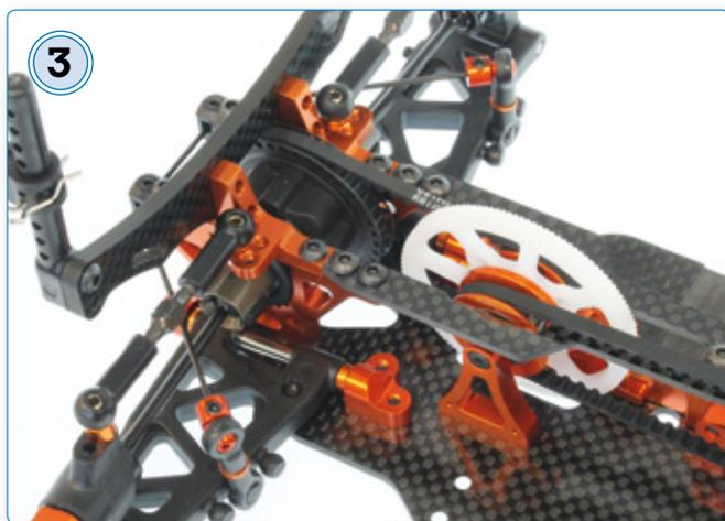
3 Zwei Kevlar-verstärkte Riemen übertragen die Motorkraft über das Kegelraddifferential in der Hinterachse und die vordere Starrachse auf die Räder
