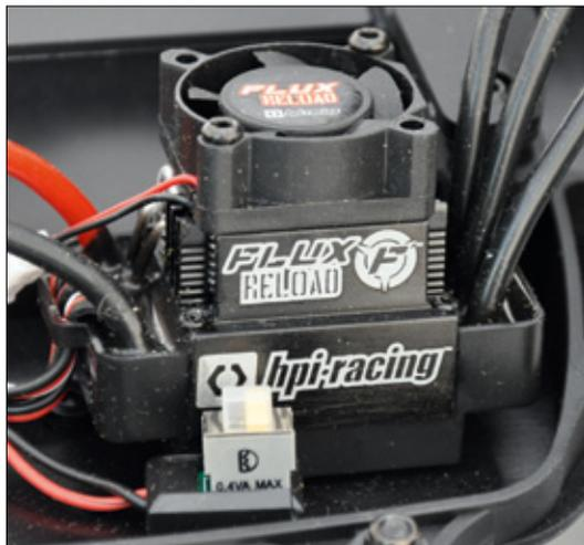
Der Flux Brushless-Regler Reload V2 ist mit einem Lüfter bestückt ist sogar 3s-LiPo-fähig
