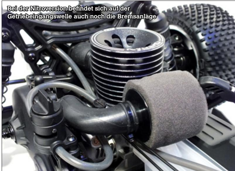
Bei der Nitroversion befindet sich auf der Getriebeingangswelle auch noch die Bremsanlage
