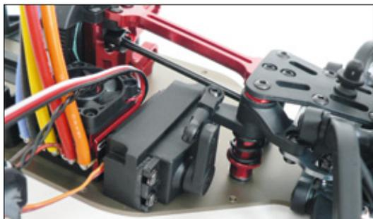
Beim Einsatz eines Low-Profile-Servos kann ein kompakter Regler mit etwas Geschick direkt auf der Chassisplatte montiert werden
