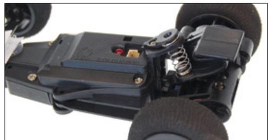
Über ein mehrstufiges Getriebe erhält der Antriebsmotor die notwendige Zugkraft. Die großzügige Schmierung vermindert die Reibung und dichtet das Getriebehäuse ab
