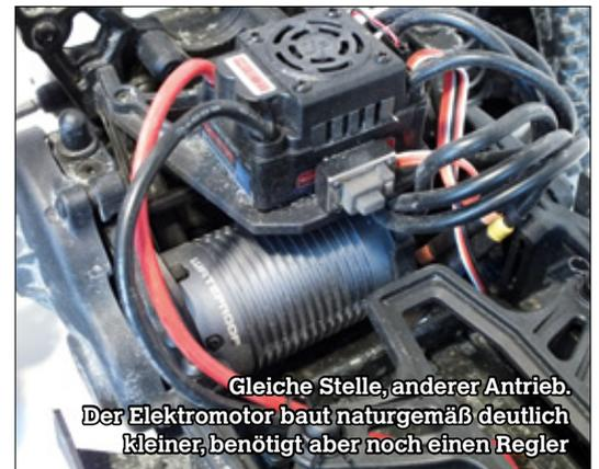
Gleiche Stelle, anderer Antrieb. Der Elektromotor baut naturgemäß deutlich kleiner, benötigt aber noch einen Regler
