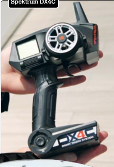
Die neue Spektrum DX4C von Horizon Hobby ist eine Vierkanal-Pistolenfernsteuerung, die serienmäßig mit einem AVC-Empfänger ausgeliefert wird. Zwar weist die DX4C mit einem erweiterten Funktionsumfang und einem neuen Design neue Features auf, setzt jedoch mit dem DSMR-Übertragungsverfahren auf bewährte Technik. Der Sender verfügt über 20 Modellspeicher und ein hintergrundbeleuchtetes Display.
