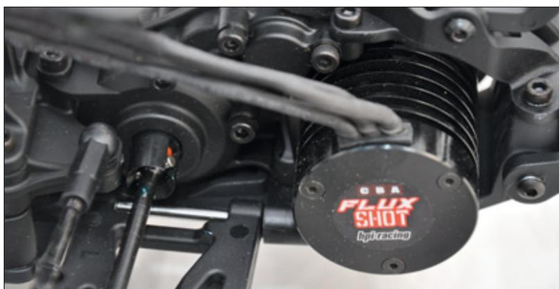
Der Flux-Shot-Brushlessmotor bietet Leistung satt. Das Aggregat verfügt über eine spezifische Drehzahl von 4.300 kv
