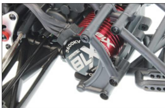
Angetrieben wird der Vorteks von einem BLX-Motor mit einer spezifischen Drehzahl von 3.600 Umdrehungen pro Minute und Volt
