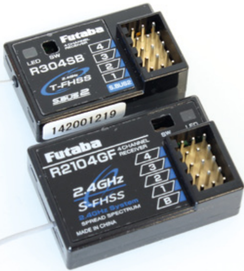
Zwei Empfänger gehören zum Set: Ein telemetriefähiger Receiver (oben) und ein Standard-Vierkanalempfänger
