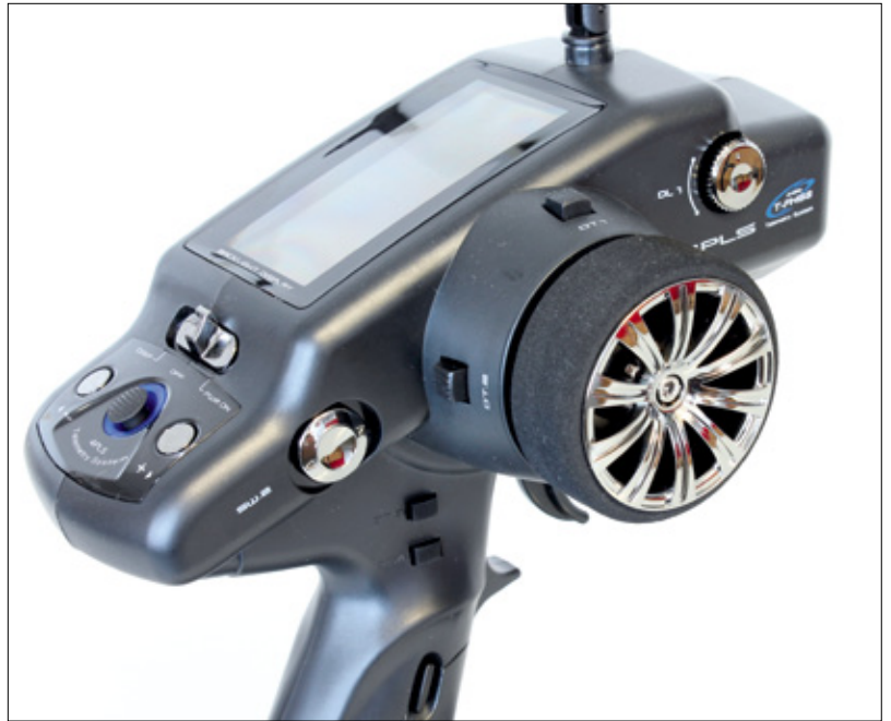
Ausgestattet ist die T4PLS mit fünf Gebern und zwei Schaltern
