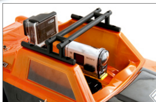
Ein selbst gebauter Überrollkäfig versteift die Karosse und schützt die Kameras
