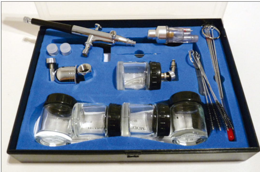
Bis auf den Wasserabscheider gehört ein Standard Double-Action-Airbrush inklusive Zubehör zum Lieferumfang des Kompressors. Die Zubehöerteile sind allerdings eher für große Flächen ausgelegt
