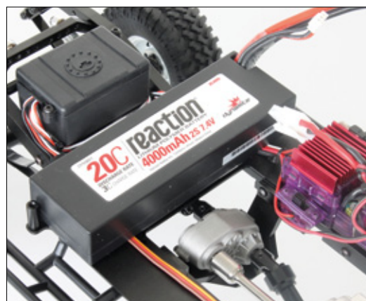
Das Twister-Lenkservo hat zwar ein Metallgetriebe, ist jedoch nicht sonderlich stark
