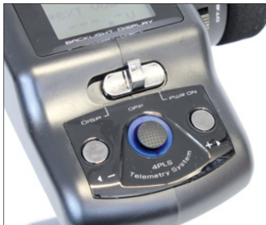
Die Menüführung erfolgt mittels Joystick und den Plus-Minus-Tasten
