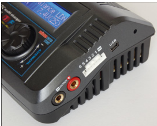
Der integrierte Balancer gleicht LiPos bis zur 6s-Konfiguration aus, Akkus werden wie üblich über 4-Millimeter-Buchsen angesteckt
