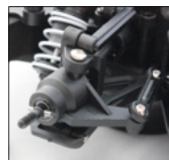
Spur und Sturz lassen sich leider nicht stufenlos einstellen. Hier wurde auf die Verwendung von Gewindestangen verzichtet
