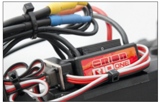
Der 25-Ampere-Regler ist programmierbar und kann an NiXX- und LiPo-Zellen gleichermaßen betrieben werden
