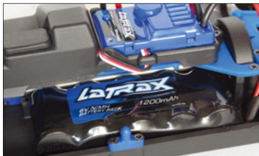
Teil des RTR-Pakets ist ein NiMH-Akkupack mit fünf Zellen und Tamiya-Steckverbindung
