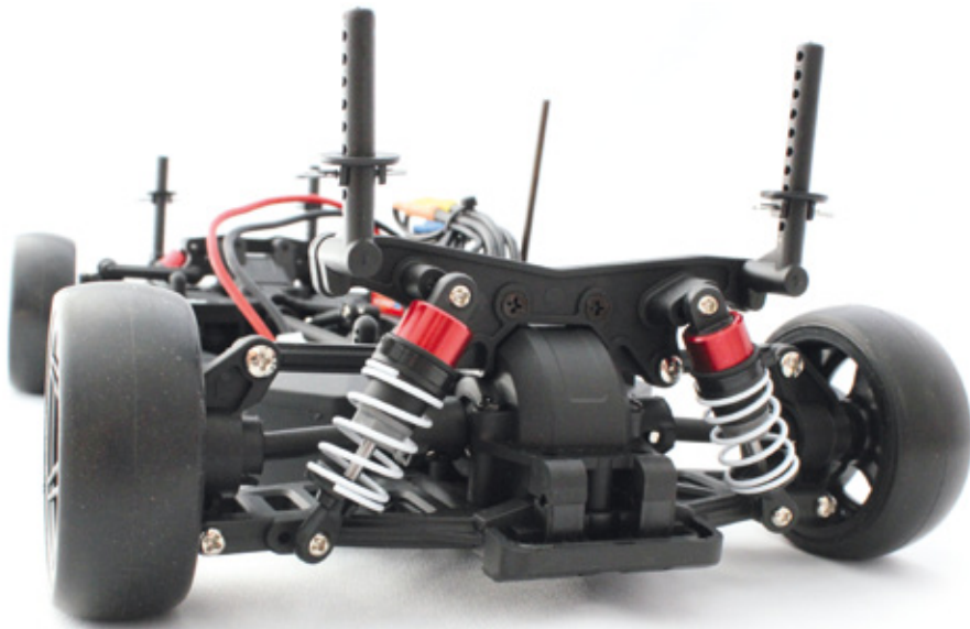
Die Federvorspannung der Öldruckstoßdämpfer wird mittels C-Klipsen eingestellt
