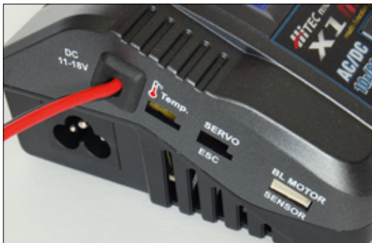
Neben dem Anschluss für einen optionalen Temperaturfühler lassen sich auch Servos und Brushlessmotoren testen
