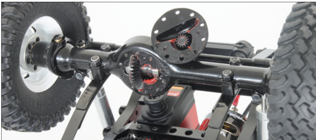
Durch Lösen von zehn Schrauben kann man die Achsen öffnen. Darin finden sich starre Durchtriebe, die in Kugellagern laufen und gut gefettet sind
