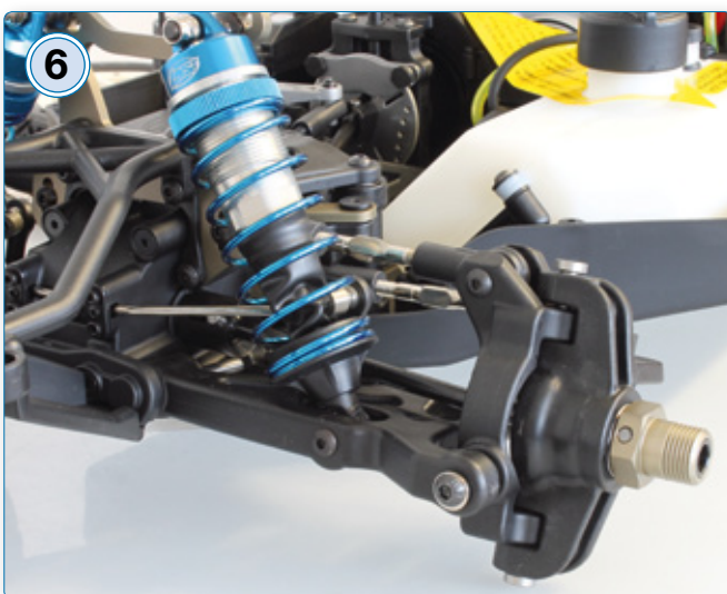
6 Dicke Kunststoff-Querlenker, Rechts-links-Gewindestangen, C-Hub-Aufhängungen und Aluminium-Bigbore-Öldruckstoßdämpfer zeichnen das Fahrwerk des Mini aus
