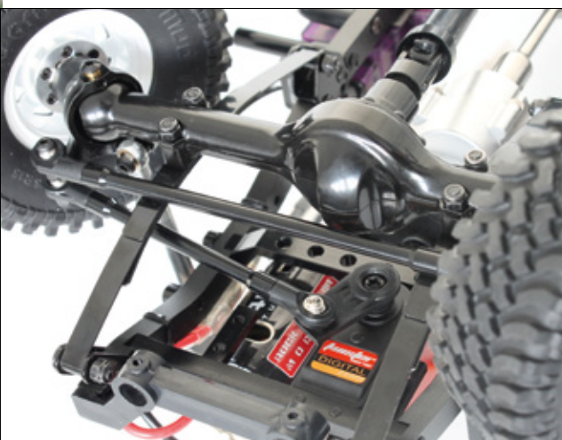
Das Twister-Lenkservo hat zwar ein Metallgetriebe, ist jedoch nicht sonderlich stark
