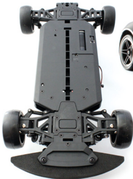
Ein glatter Unterboden zeichnet das Fazer-Chassis von Kyosho aus. Hier sind die Driftreifen aufgezo-
