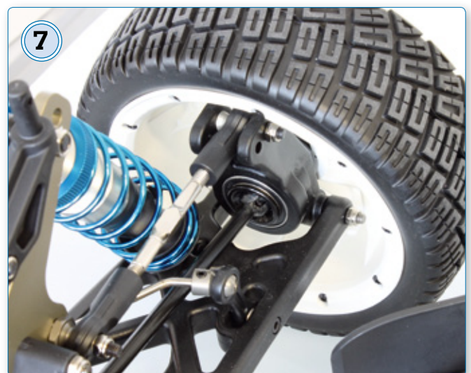
7 Selbstverständlich ist das komplette Modell kugelgelagert und als Antriebswellen kommen CVD-Exemplare zum Einsatz. Stabilisatoren gibt es vorne und hinten serienmäßig
