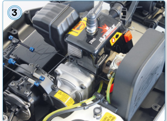
3 Der 29-Kubikzentimeter-Dynamite-Motor ist längs zur Fahrtrichtung eingebaut. Auffällig ist der große Luftfilterkasten. Der Aufbau entspricht dem üblichen Klassenstandard
