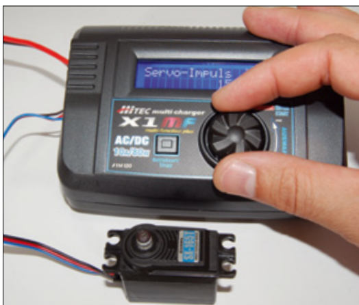
Per Drehrad lässt sich das angeschlossene Servo in unterschiedliche Positionen fahren
