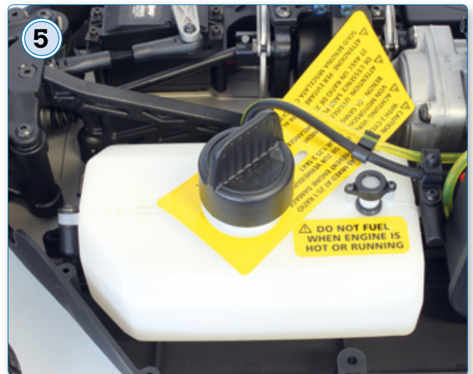
5 Der Benzintank nimmt das 1:25-Zweitaktgemisch auf. Er ist auch bei aufgesetzter Karosserie zugänglich
