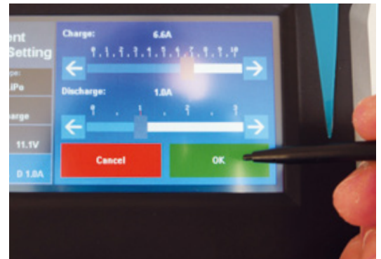
Mittels Schieberegler können Lade- und Entladestrom in Schritten von 0,1 Ampere eingestellt werden
