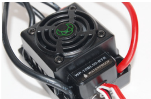
Spritzwasser hält das Gehäuse des sensorlosen Brushlessreglers effektiv von den empfindlichen Innereien fern. Damit bedeutet ein kleiner Regenschauer nicht zwangsläufig das sofortige Ende der Ausfahrt
