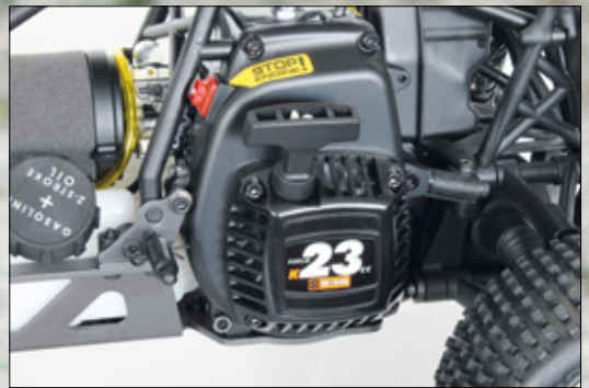
Der 23-Kubikzentimeter-Fulle-Motor wird über einen Seilzug gestartet und läuft ab der ersten Tankfüllung zuverlässig
