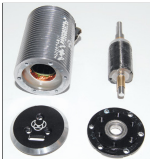
Mit wenigen Handgriffen ist das Brushlesstriebwerk in seine Baugruppen zerlegt
