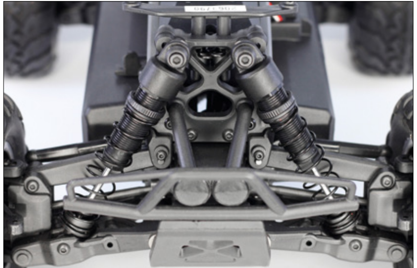
Im Savage XS Flux arbeiten vier einstellbare Öldruckstoßdämpfer aus Kunststoff
