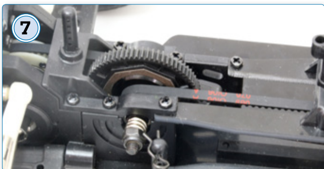
7 Die kugelgelagerte Mittelwelle mit dem Hauptzahnrad in seiner Halterung. Sechs Schrauben fixieren den oberen Halter. Im Bild vorne sieht man die Mutter, über die die Wirkung der Rutschkupplung eingestellt wird
