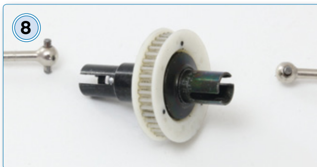
8 Die Kugeldifferenziale hinterlassen einen sehr guten Eindruck. Stahlausgänge, 3 Millimeter Kugeln, ein zerlegbares Riemenrad, Kugellager – einfach alles so, wie man es sich bei einem robusten Fahrzeug wünscht
