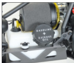
Der 700-Milliliter-Tank bevorratet genügend Sprit für rund 45 Minuten Fahrzeit
