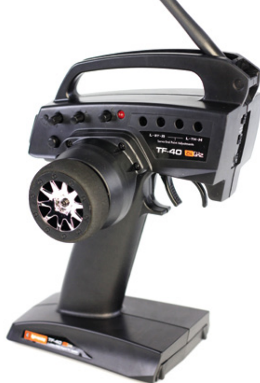
Der TF-40-Sender mit 2,4 Gigahertz bietet alle notwendigen Einstellmöglichkeiten und liegt gut in der Hand
