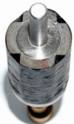
Der Rotor verfügt über vier Pole
