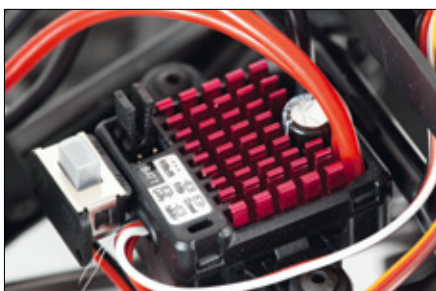
Der wassergeschützte Regler ermöglicht eine Fahrt auch bei widrigen Bedingungen
