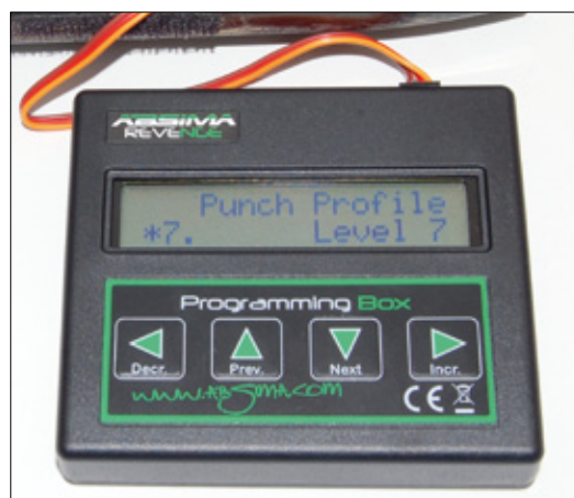
Die Programmierbox stellt eine ideale Möglichkeit dar, das Regler-setting nach den eigenen Bedürfnissen anzupassen
