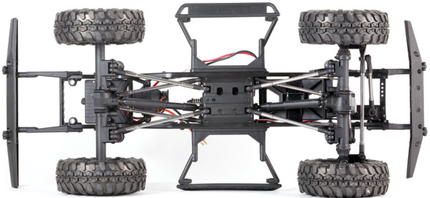
Das RTR-Modell verfügt über eine schicke und verwindungssteife Aluminium-Verlinkung
