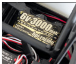
Ein NiMH-Akku mit 3.000 Milliampere-stunden Kapazität versorgt die RC-Anlage mit Strom
