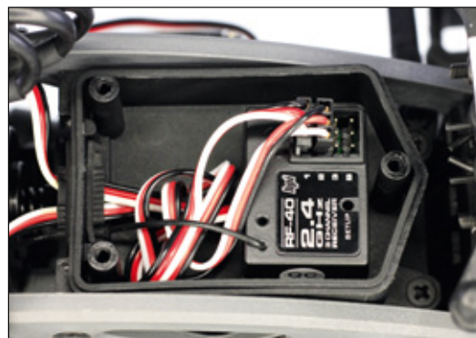
Der 3-Kanal 2,4 GHz Mini-Empfänger RF-40 findet reichlich Platz in der wasserdichten RC-Box, die zwischen den beiden Chassisplatten montiert ist
