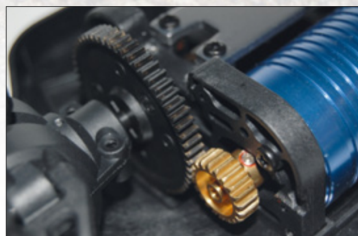
Eigentlich wären Kunststoff-Hauptzahnrad und Messing-Motorritzel ein leichtes Opfer für Sand und kleine Steinchen ...
