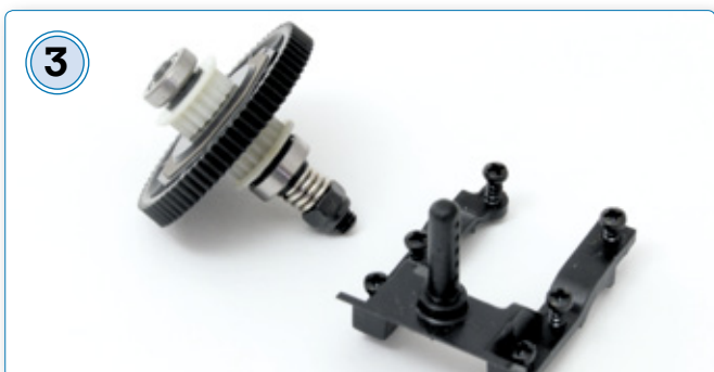
3 Die Mittelwelle ist mit einer einstellbaren Rutschkupplung versehen und mit nur sechs Schrauben des Halters flott ausgebaut. Das Hauptzahnrad ist in Modul 0,5 ausgeführt, was typisch ist für die kleineren Maßstäbe
