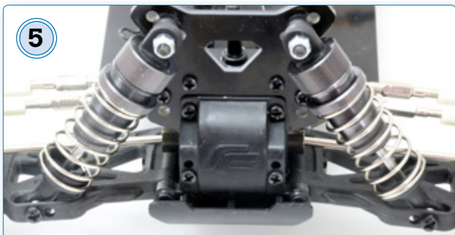
5 Vorne und hinten sind Schmutzabdeckungen montiert, die auch die optionalen Stabilisatoren halten. Die Stabis werden über Schrauben fixiert, die in die freien Löcher an der Abdeckung gedreht werden. Auf der anderen Seite werden sie mit den unteren Querlenkern verbunden
