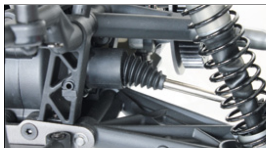
Die Antriebswellen sind mit Gummimanschetten gegen Schmutz geschützt
