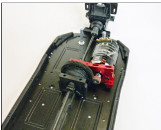
Beide Modelle lassen einen Wechsel der Motorposition zu, beim 2WD-Buggy sind zwei Varianten nutzbar, beim 4WD-Buggy können es sogar vier sein – allerdings nur mit optionalen Teilen
