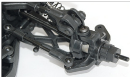
In Sachen Lenkung setzt Absima auf die gängige C-Hub-Konstruktion
