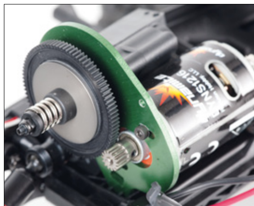
Das Ritzelspiel ist ab Werk perfekt justiert. Gut zu sehen ist die einstellbare Slipper-Kupplung, die vor Zahnausfall schützt
