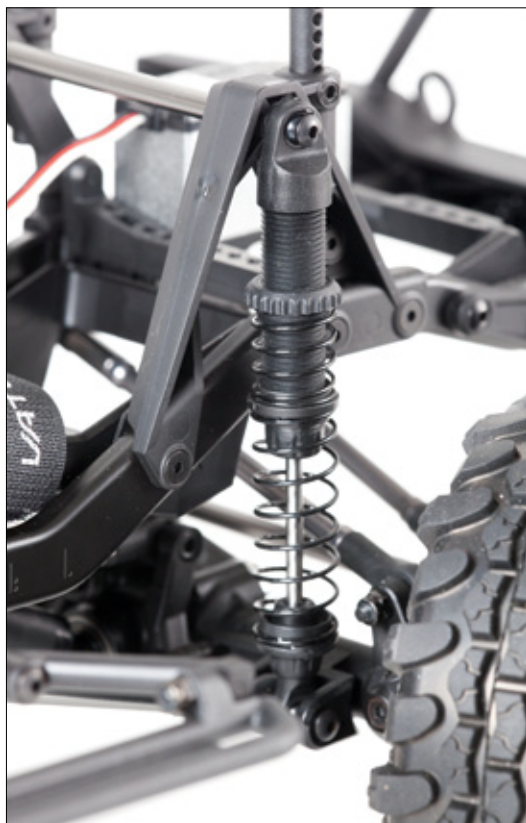
Die Stoßdämpfer behielten während des gesamten Tests ihr Öl
