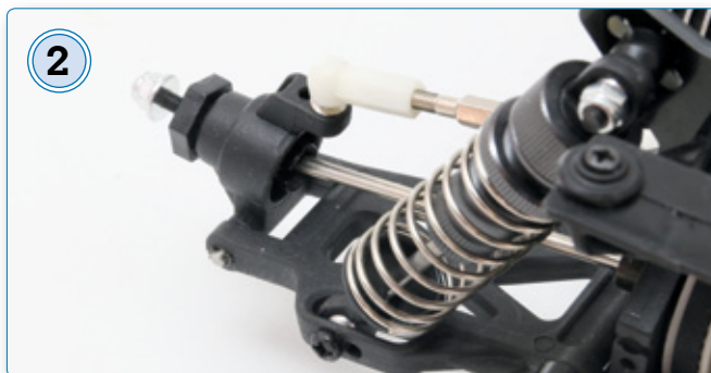
2 Die Hinterachse ist ähnlich gut aufgebaut wie die Vorderachse. Die Dämpferposition kann oben dreifach und unten zweifach verstellt werden. Die oberen Querlenker lassen sich in der Länge auf zwei Positionen montieren und im Rollcenter zweifach verstellen
