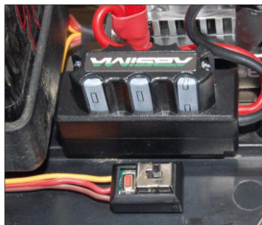
Drei Kondensatoren sorgen dafür, dass die Reglerspannung stets stabil bleibt
