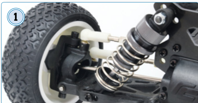
1 Die Vorderachse (rechts vorne) mit einer durchdachten Aufhängung und im Winkel mehrfach verstellbaren Alu-Öldruckstoßdämpfer. Die Bodenfreiheit wird über eine Rändelmutter justiert. Das Rollzentrum kann zweifach am oberen Querlenker verstellt werden
