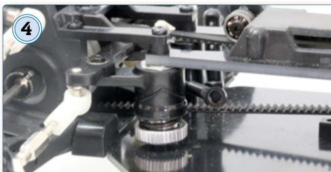
4 Auch ein Servosaver fehlt nicht am Carisma GTB. Dieser ist über eine Rändelmutter in seiner Wirkung einstellbar
