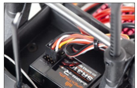
Die RC-Box beherbergt den hochwertigen Spektrum-Empfänger.
