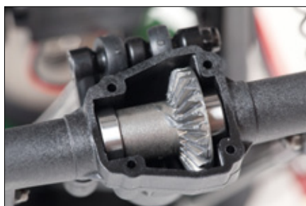
Hier wurde an Fett gespart. Vor der ersten Fahrt empfiehlt sich eine ergänzende Schmierung
