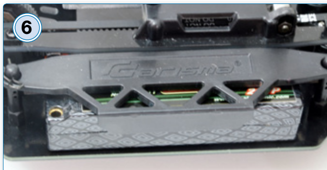
6 Richtig viel Platz bietet der Akkuhalter für die unterschiedlichsten Akkus. Der Halter ist fünffach höhenverstellbar und hält den Akku seitwärts fest. Innen auf der Chassisplatte ist eine kleine Schiene montiert, die den Akku daran hindert, gegen den Riemen zu rutschen
