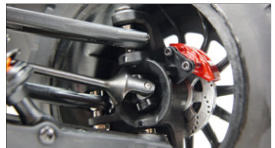
Vorne findet man Kardanwellen, die in Kugellagern laufen. Fette Querlenker unten und oben machen die Frontpartie sehr robust. Bei den Bremssätteln erkennt man die Montagepunkte am C-Hub
