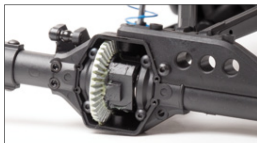
Um die Fettung der Differenziale zu checken, müssen lediglich vier Schrauben entfernt werden, um den Deckel zu öffnen
