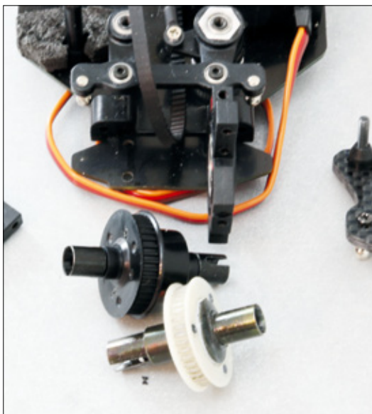
Der Austausch von Kugel- und Kegeldifferenzial. Die Carbon-Dämpferbrücke wird auch gleich montiert
