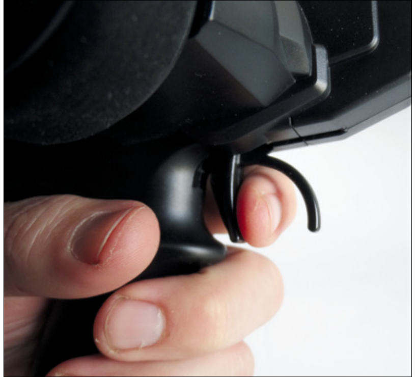
Der Gas-Bremshebel lässt sich zwar nicht verstellen, ist aber auch für kleine Hände gut erreichbar
