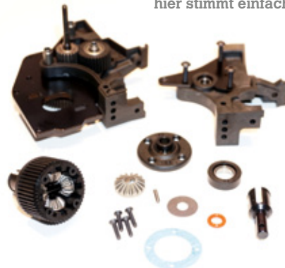
Das Getriebe in klassischer Dreistufenbauweise ist mit einem Vierspider-Kegeldifferenzial ausgestattet. Die gesamte Einheit hinterlässt einen sehr ausgereiften Eindruck und ist besonders leichtgängig
