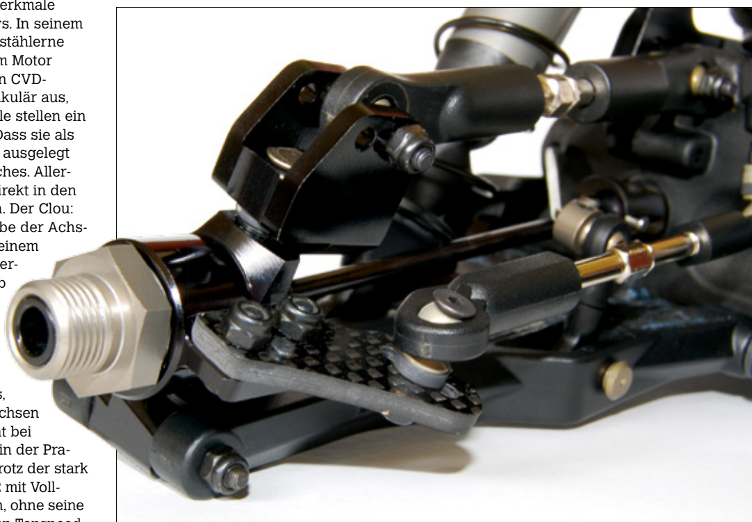
Im Bereich der Lenkhebel setzt die D8-Baureihe von Anfang an auf C-Hub-Konstruktionen in unterschiedlichen Formen. Das gilt auch für den D815
