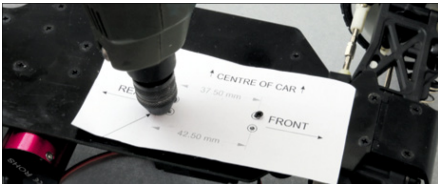
So wird die Schablone der Servohalter benutzt, um ein zusätzliches Loch in die Chassisplatte zu bohren
