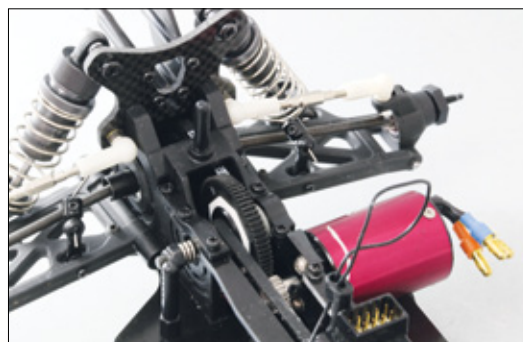
Das Heck ist fertig. Gut zu erkennen sind die neuen, etwas helleren Pads am Slipper
