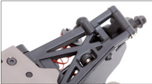
Die Querlenker sind aus stabilen Kunststoff
