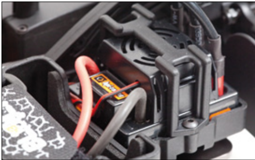
Der FluxVapor Pro Speed besitzt eine aktive Kühlung mittels Lüfter. Das er wasserdicht ist, macht ihn besonders interessant für den Rallyecrosser
