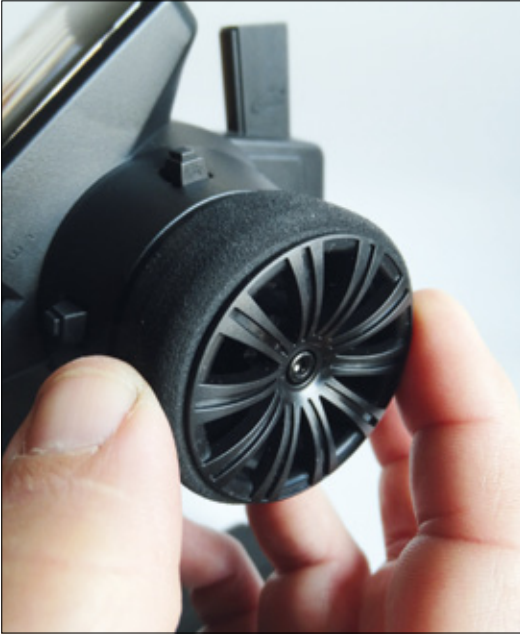
Ein griffiges Lenkrad mit Moosgummibeschichtung gibt gutes Feedback beim Fahren
