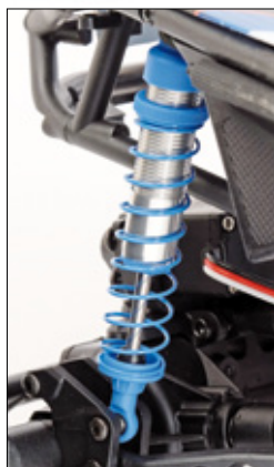
Edle Öldruckstoßdämpfer in Aluminium-Bauweise sorgen für ein sauber arbeitendes Fahrwerk im Gelände
